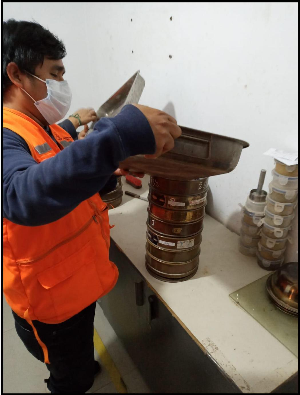
**Figura N°06:** Tamizado del agregado fino
