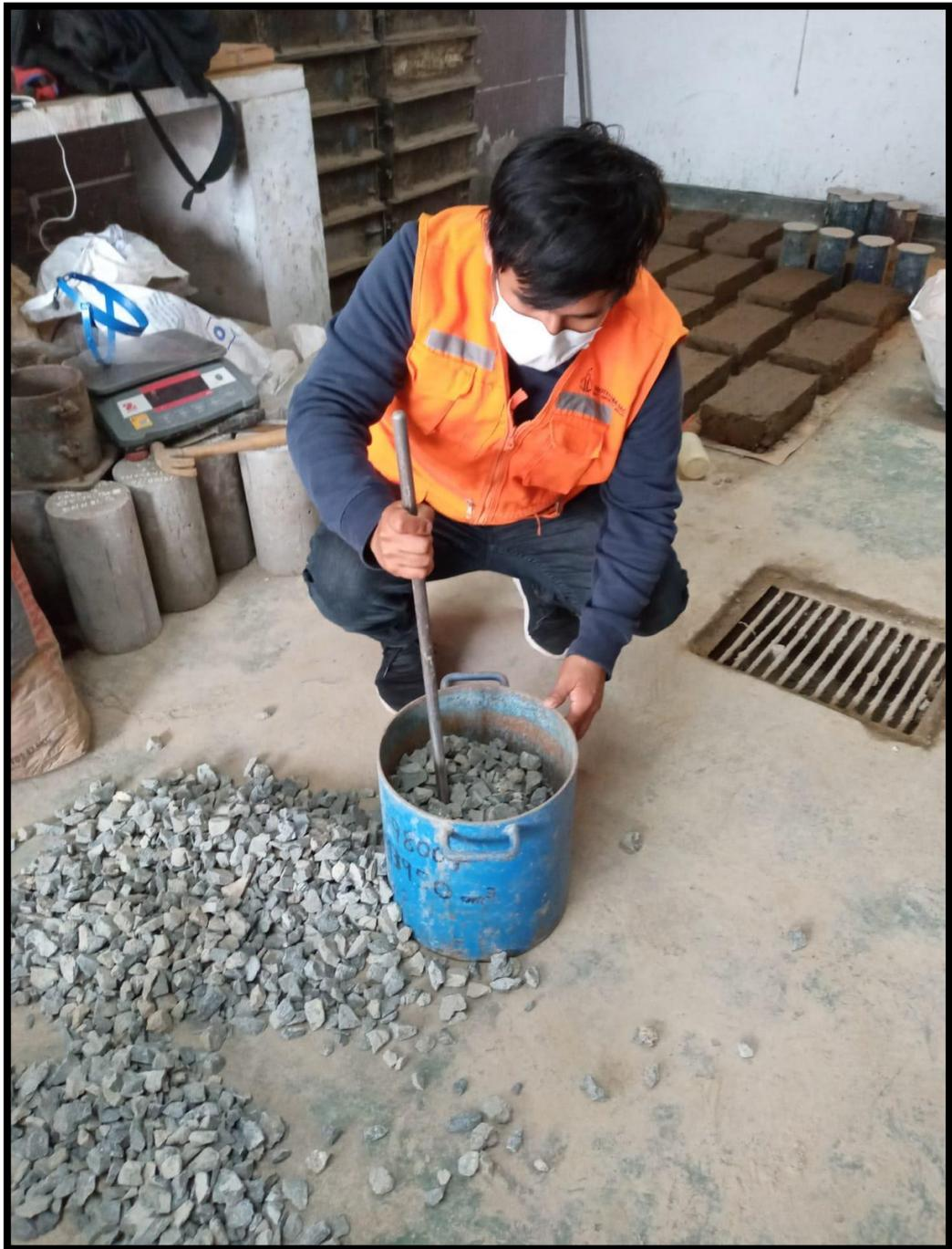
**Figura N°09:** Ensayo del P.U del agregado grueso
