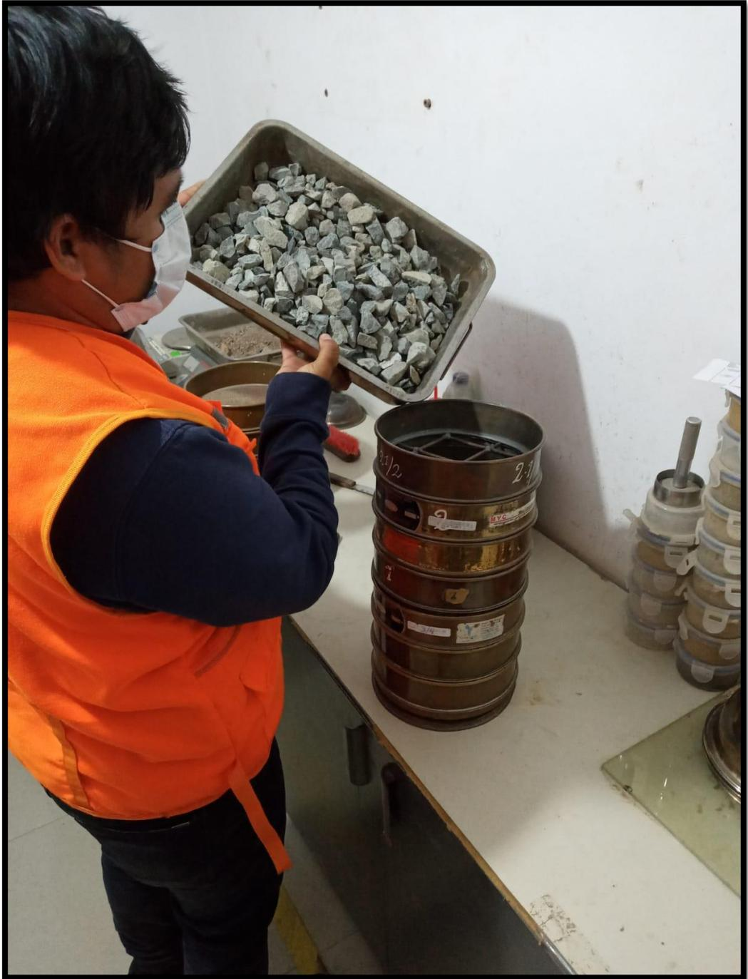
**Figura N°05:** Tamizado del agregado grueso
