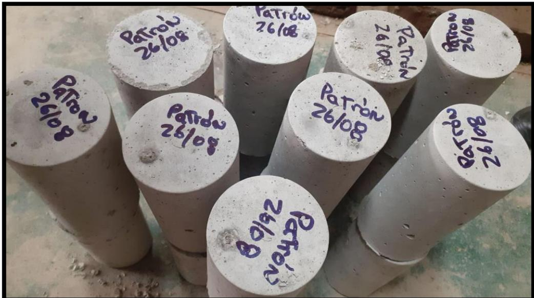
**Figura N°18:** Identificación de los especímenes de concreto
