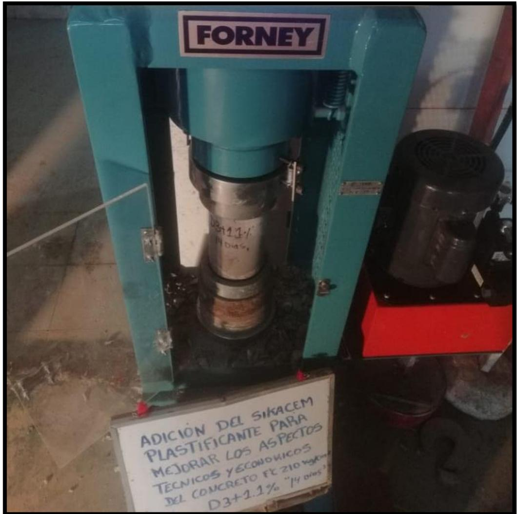
Figura N°20: Ensayo de resistencia a la compresión
