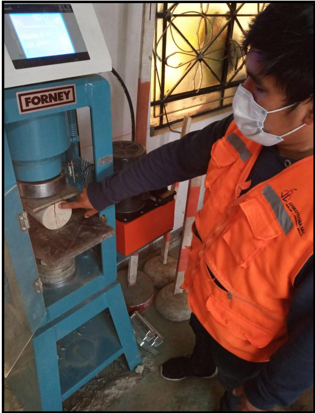
**Figura N°21:** Ensayo de resistencia a la tracción
