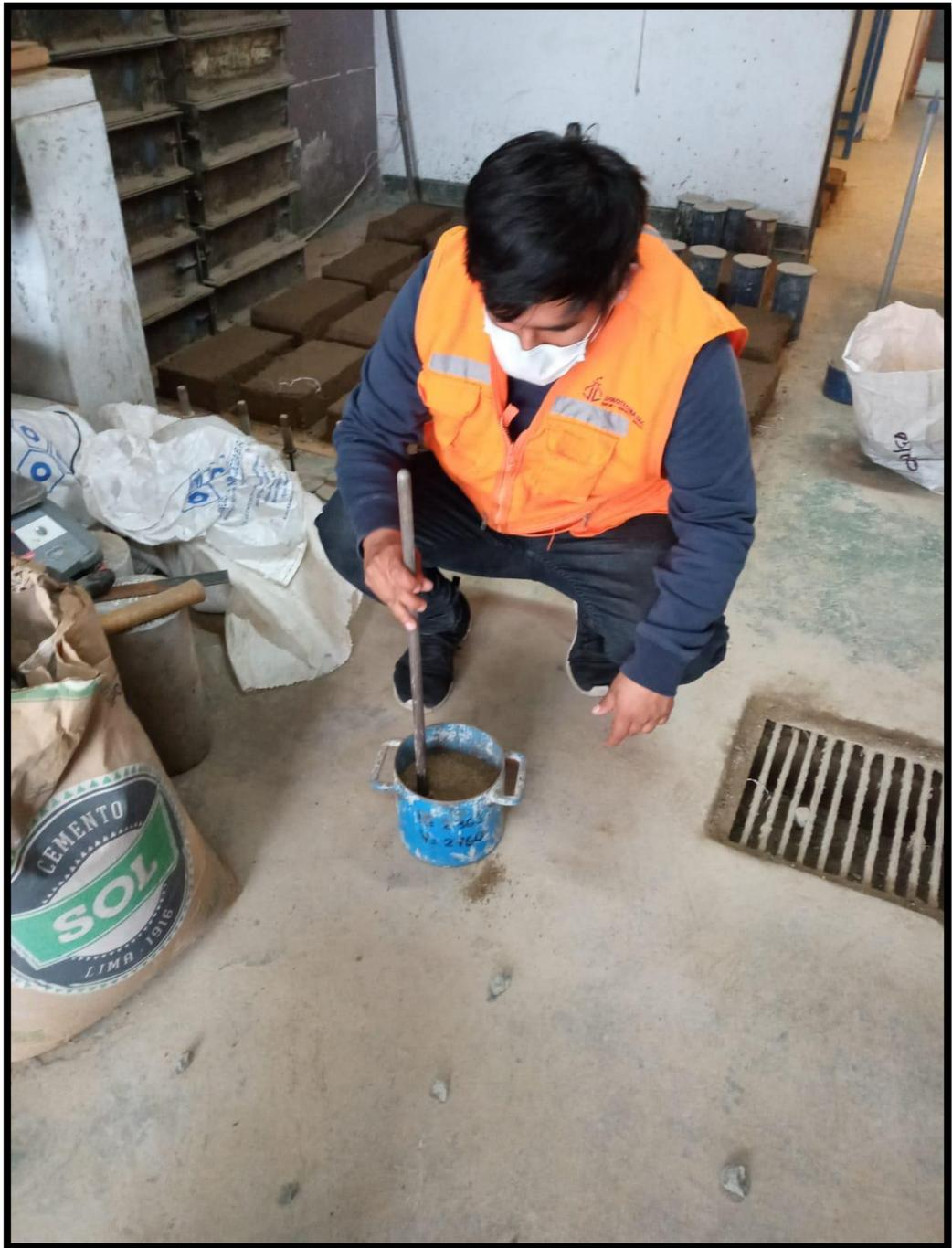
**Figura N°10:** Ensayo del P.U del agregado fino
