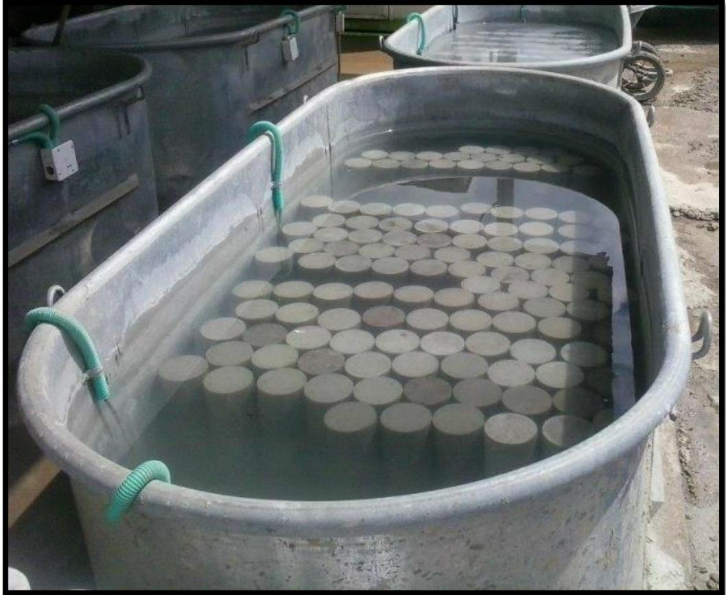
**Figura N°19:** Curado de probetas
