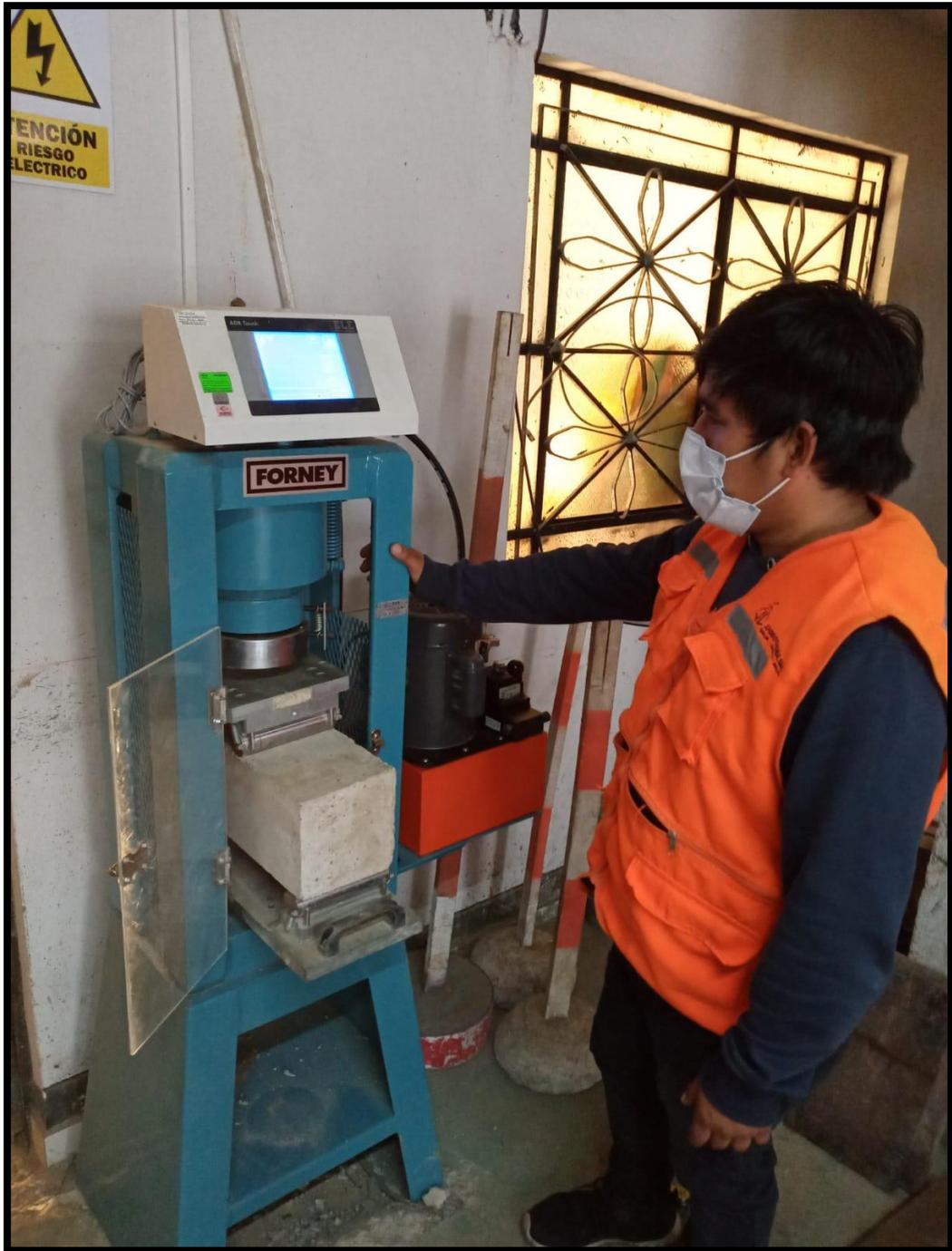
Figura N°22: Ensayo de resistencia a la flexión
