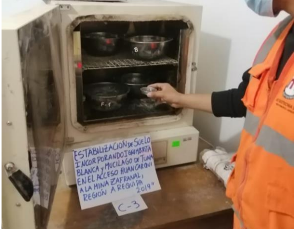
Fotografía 38. Muestras del ensayo Limite Plástico C-03.
