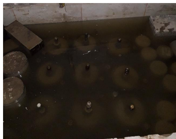
Fotografía 188. Sumergida de molde CBR en la poza de saturación.
