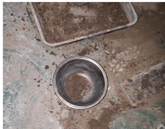
Fotografía 44. Muestra del molde Proctor.
