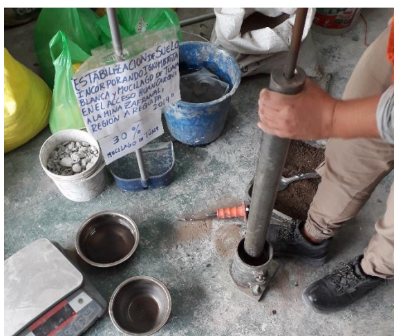
Fotografía 161. Compactado de la muestra a 25 golpes.
