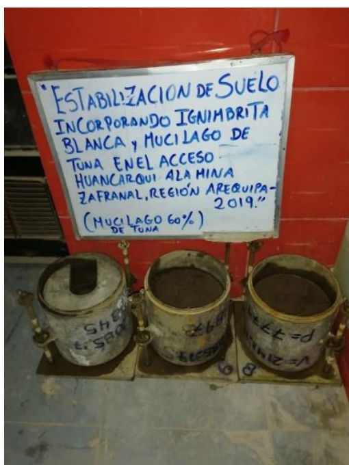
Figura 52. Moldes de CBR 60% dosificación Mucilago de Tuna.
