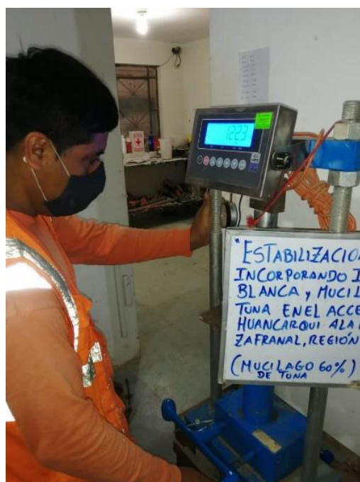
Figura 53. Ensayo de CBR 60% dosificación Mucilago de Tuna.
