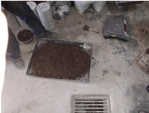
Fotografía 53. Muestra al finalizar la combinación de suelo y agua.
