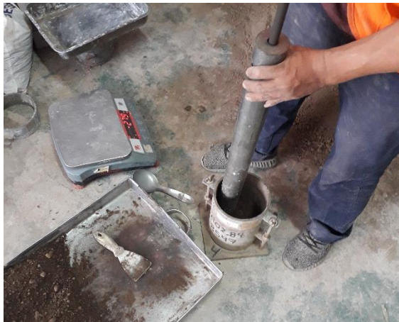
Fotografía 57. Compactación del molde CBR a 56 ,25 y 12 golpes.
