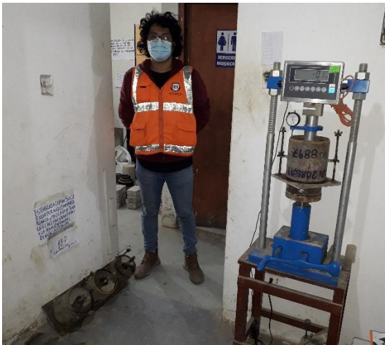
Fotografía 149. Moldes y Prensa de CBR listo para su ensayo.
