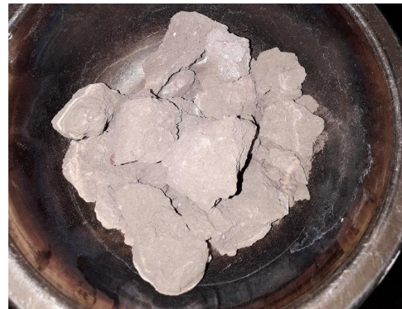
Fotografía 170. Muestra seca tras estar en el horno
