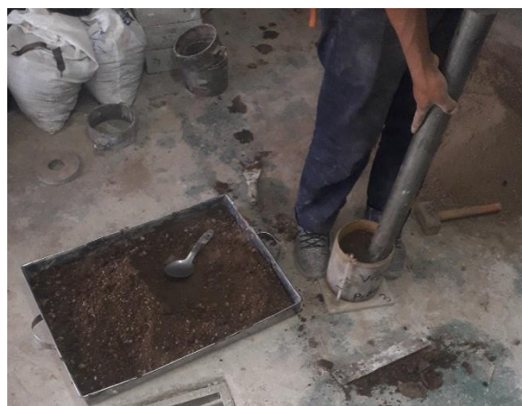
Fotografía 56. Inicio de Compactación del molde CBR en 5 capas.
