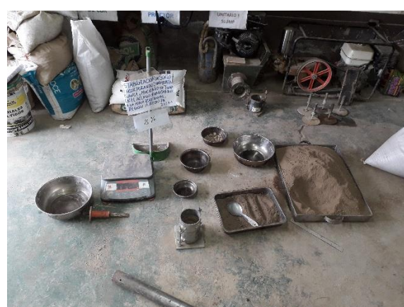
Fotografía 116. Vista de los materiales que se usaran en el ensayo Proctor M.
