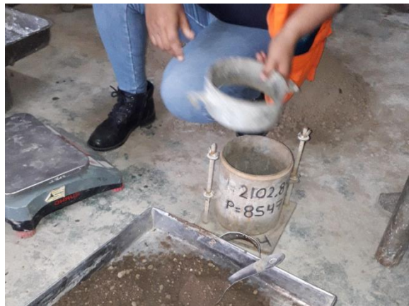
Fotografía 54. Armado del molde CBR.
