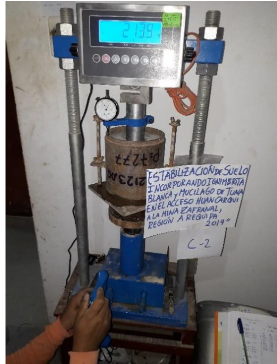
Figura 41. Ensayo CBR C-02.
