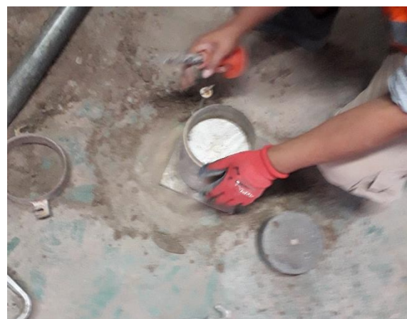
Fotografía 140. Molde CBR terminado.
