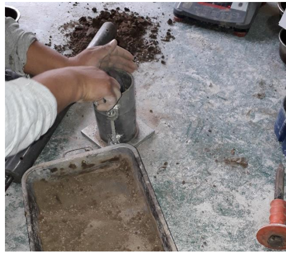
Fotografía 40. Llenado del material al molde.
