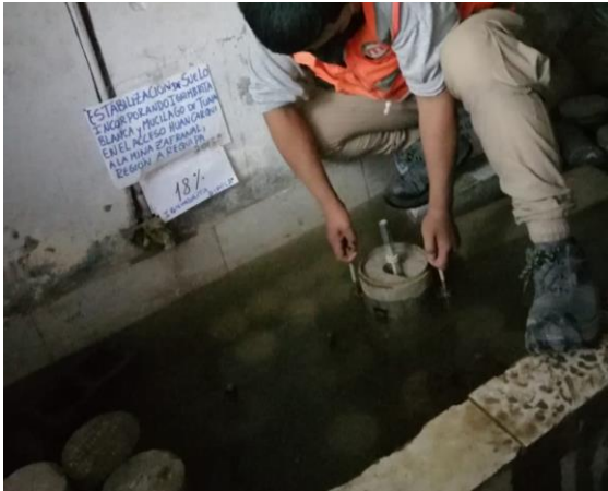
Fotografía 147. Moldes de CBR 18% sumergidos en la poza de saturación.
