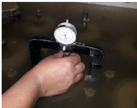
Fotografía 70. Lectura de la expansión de los moldes (4 días de medición).
