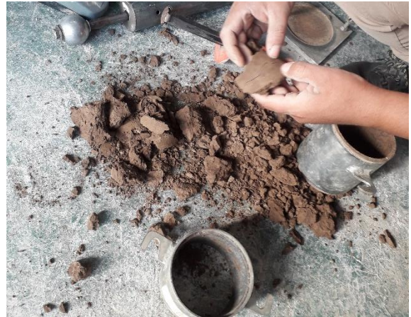
Fotografía 166. Extracción de muestra del molde Proctor.
