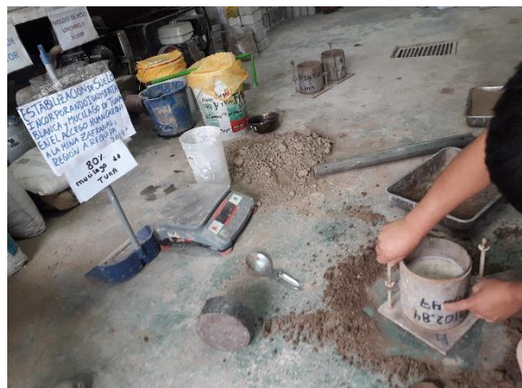
Fotografía 182. Molde de CBR terminado.
