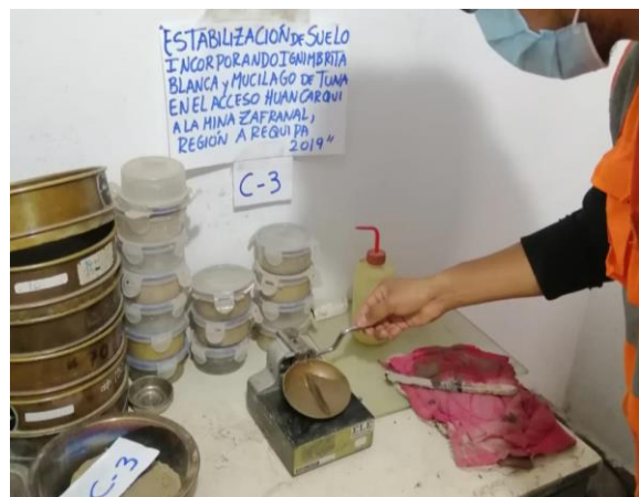
Fotografía 32. Ensayo Limite Liquido C-03.
