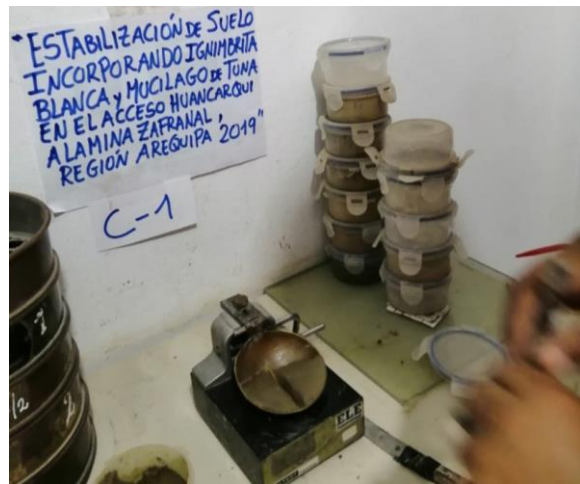
Fotografía 30. Ensayo Limite Liquido C-01.
