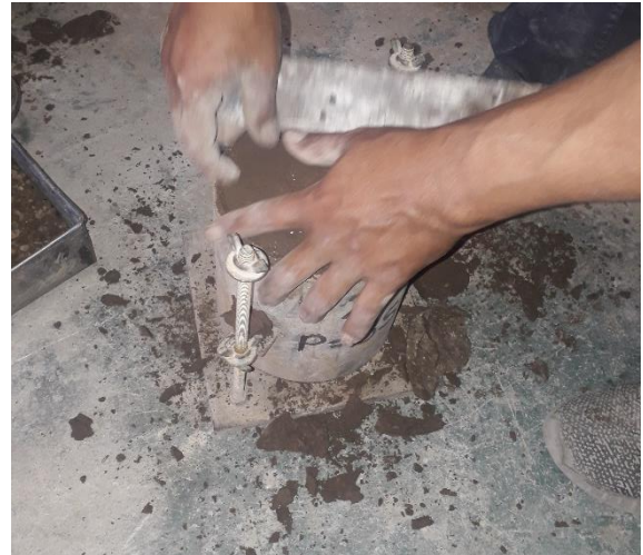
Fotografía 60. Razado del molde.
