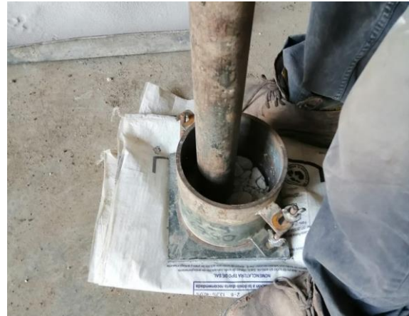
Fotografía 88. Uso del molde de CBR para pulverizar el material.
