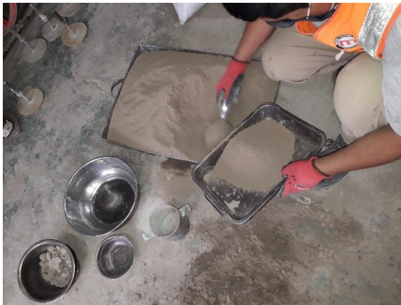
Fotografía 129. Toma de muestra (suelo) para el ensayo CBR.
