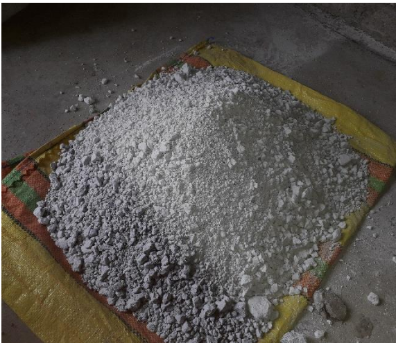
Fotografía 89. Ignimbrita blanca que no se logró pulverizar (separada).
