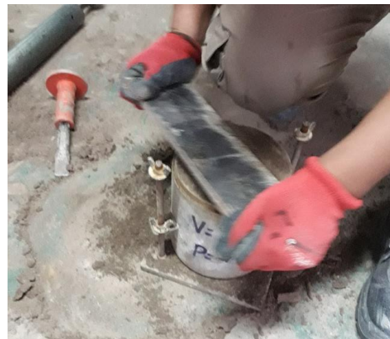
Fotografía 138. Razado del molde CBR.
