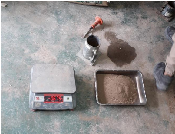
Fotografía 111. Muestra de suelo para el ensayo Proctor Modificado.
