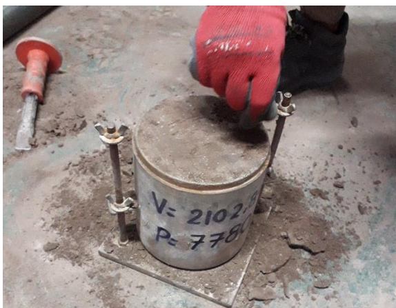
Fotografía 139. Molde de CBR al finalizar el razado.
