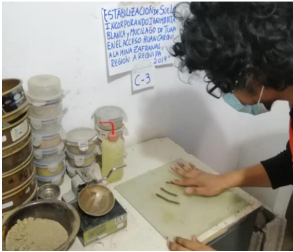
Fotografía 35. Ensayo Limite Plástico C-03.
