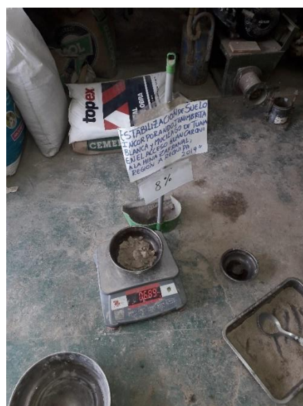
Figura 43. Muestra extraída del molde Proctor a 8% de dosificación de Ignimbrita Blanca.
