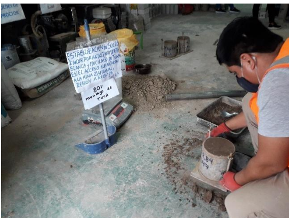
Fotografía 181. Limpieza del molde de CBR.
