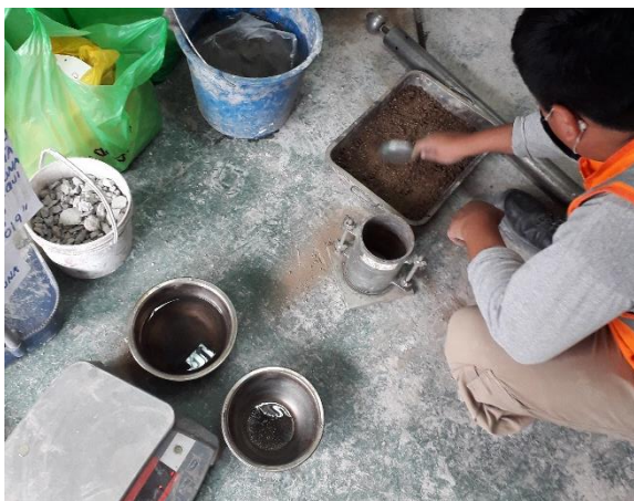
Fotografía 159. Llenado del molde Proctor con la muestra.
