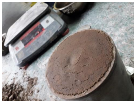
Figura 37. Molde de compactación Proctor Modificado.
