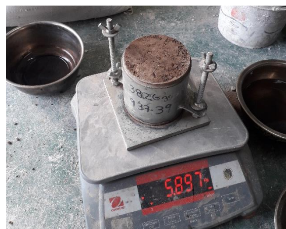
Fotografía 164. Pesado del molde Proctor.
