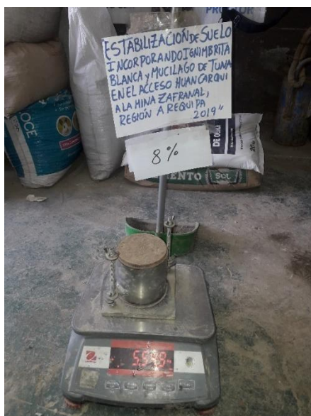
Figura 42. Molde Proctor a 8% de dosificación de Ignimbrita Blanca.
