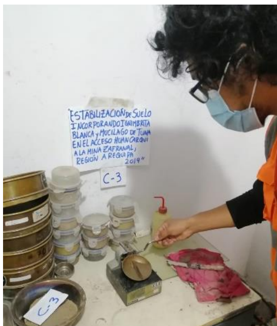
Figura 35. Ensayo Limite Líquido Calicata - 03
