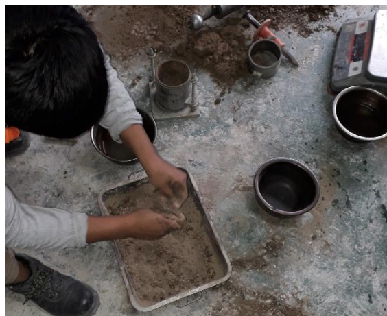
Fotografía 157. Mezcla de los materiales (suelo, agua y mucilago).
