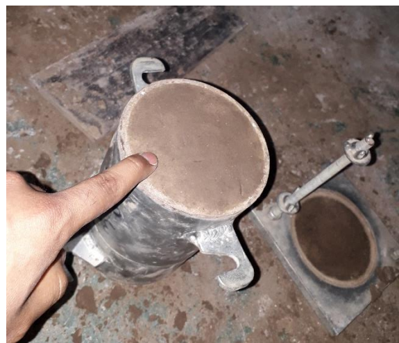
Fotografía 42. Molde Proctor terminado.
