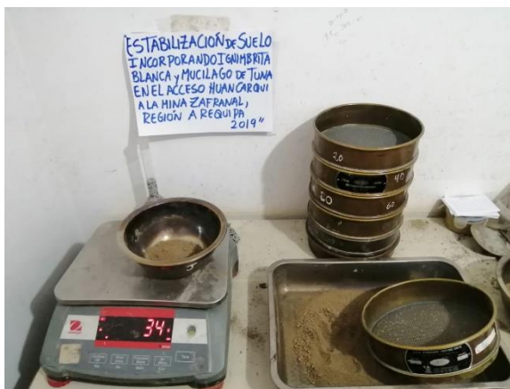
Fotografía 25. Instrumentos para la clasificación granulométrica.
