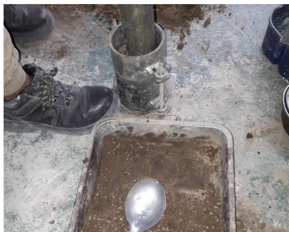
Fotografía 160. Compactado de muestra en 5 capas.
