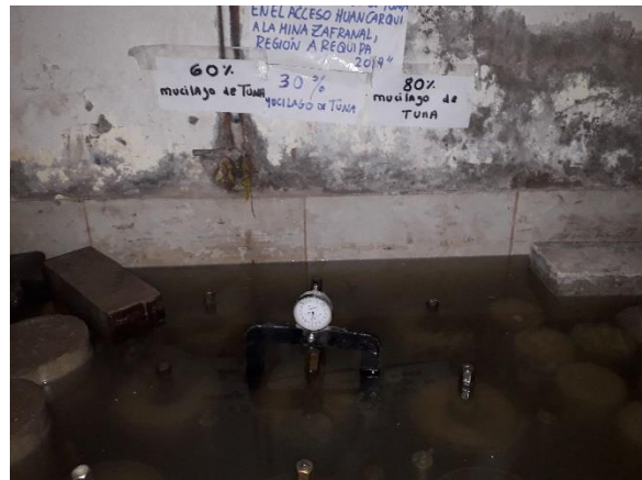
Fotografía 190. Lectura - expansión mediante el uso del Deformímetro.
