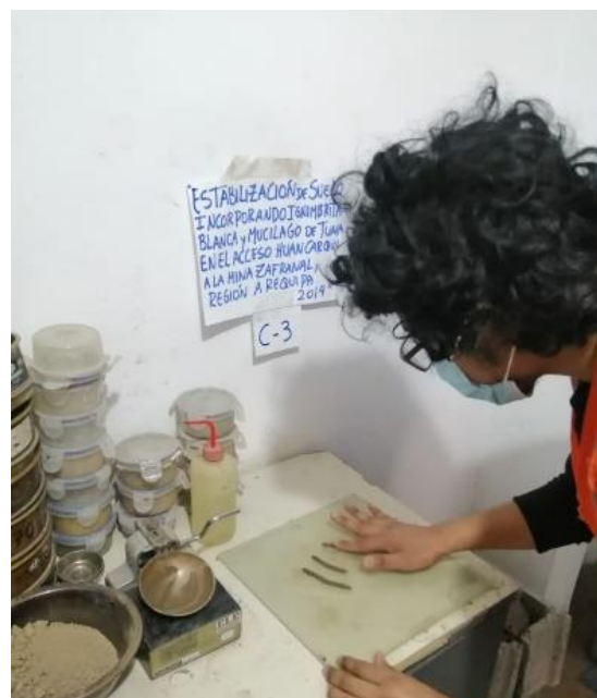
Figura 36. Ensayo Limite Plástico Calicata - 03
