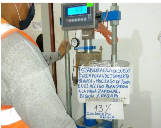
Fotografía 151. Ensayo de los moldes de CBR de 13% de ignimbrita B.
