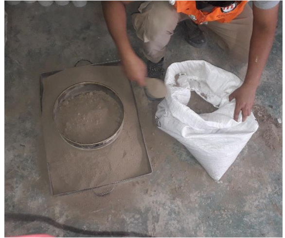
Fotografía 24. Toma de muestras para los ensayos de clasificación.
