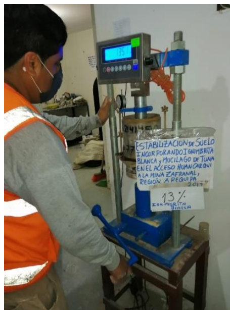
Figura 47. Ensayo de CBR 8% dosificación Ignimbrita Blanca.
