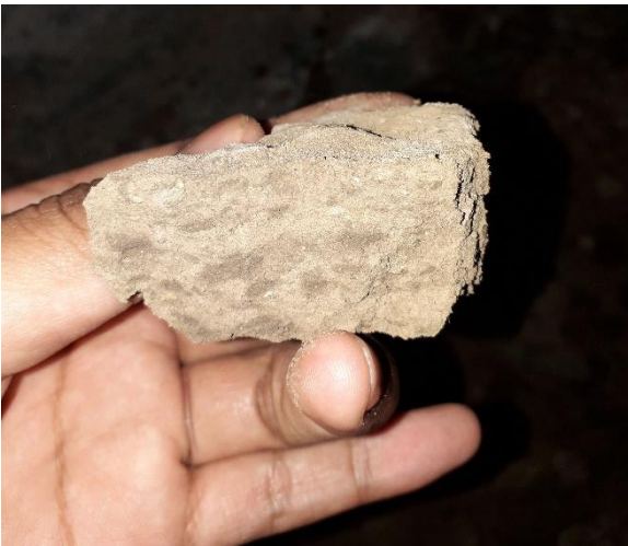
Fotografía 167. Vista de la muestra Proctor.
