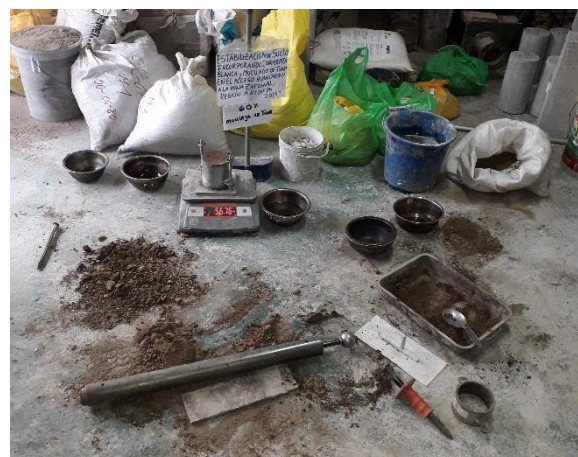
Fotografía 158. Vista de los materiales que se usaran en el ensayo Proctor M.
