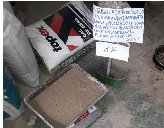
Fotografía 130. Pesado de la muestra 6 kg.
