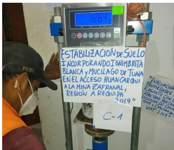
Fotografía 72. Ensayo CBR de los moldes de la C-01.
