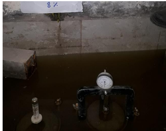
Fotografía 148. Lectura de la expansión de los moldes (4 días de medición).
