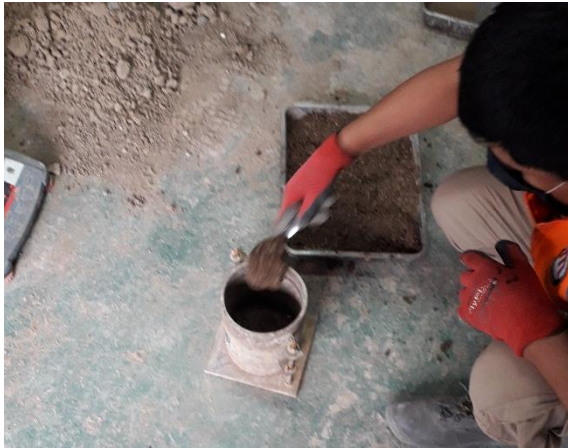
Fotografía 177. Llenado de la muestra en el molde CBR.
