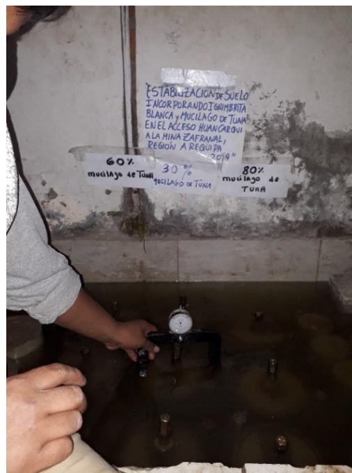
Figura 51. Medición de la Expansión mediante el uso del deformímetro.
