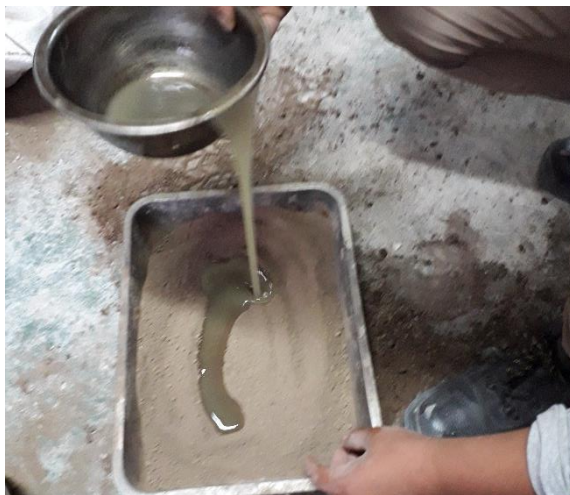
Fotografía 155. Incorporación del mucilago de tuna en el suelo.
