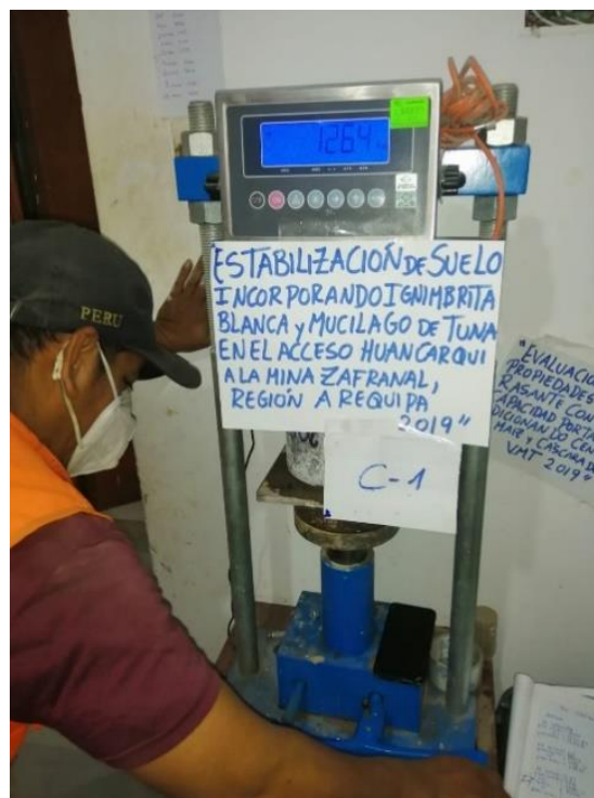
Figura 39. Ensayo CBR C-01.
