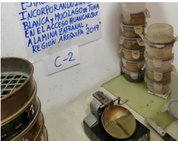
Fotografía 31. Ensayo Limite Liquido C-02.
