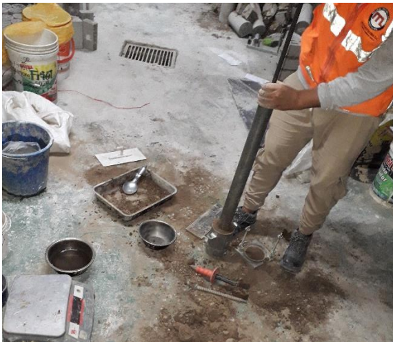
Fotografía 41. Compactado del molde a 5 capas 25 golpes.
