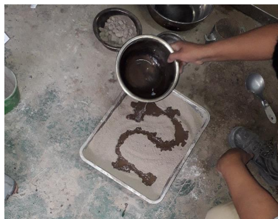
Fotografía 134. Incorporación de agua según su O.C.H.
