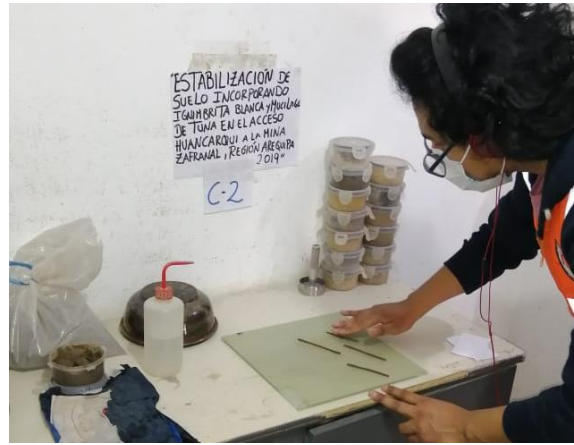
Fotografía 34. Ensayo Limite Plástico C-02.
