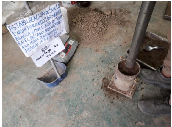
Fotografía 178. Compactado de la muestra en el molde CBR.
