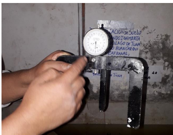
Fotografía 69. Deformímetro (trípode, y dial manómetro de expansión).
