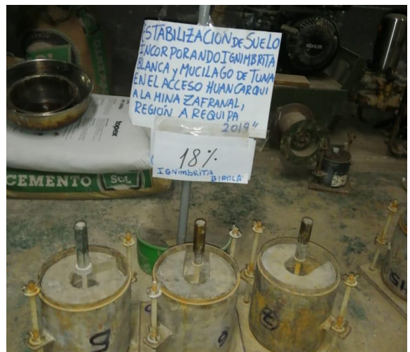
Fotografía 144. Moldes de CBR a 18% de dosifi. De ignimbrita blanca.
