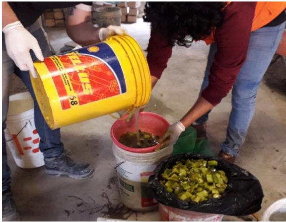
Fotografía 105. Primer colado para retirar los trozos de tuna.
