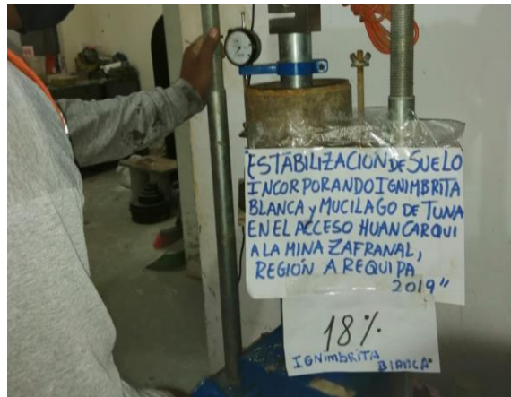
Fotografía 152. Ensayo de los moldes de CBR de 18% de ignimbrita B.
