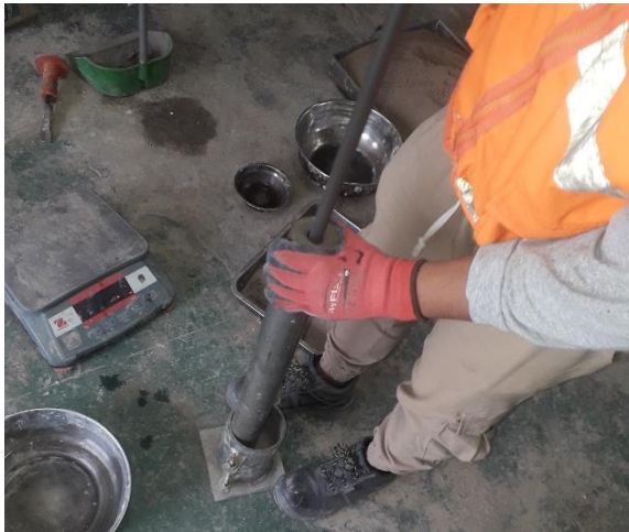
Fotografía 119. Compactado de la muestra 5 capas a 25 golpes.
