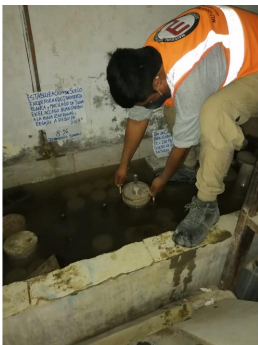
Figura 44. Sumergida de los moldes de CBR a 8% de dosificación (Ignimbrita Blanca).
