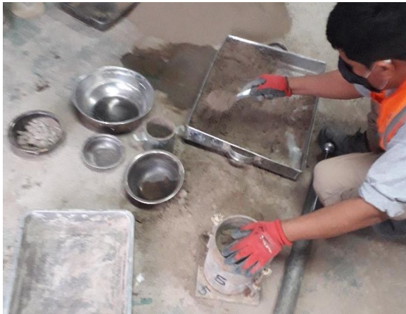
Fotografía 135. Llenado del molde CBR con la muestra.
