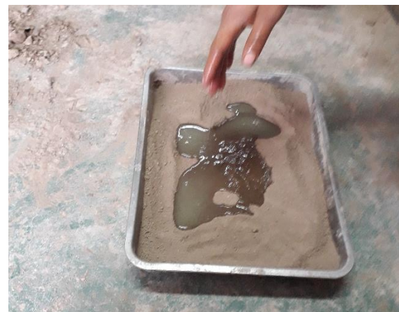
Fotografía 176. Mezcla de los materiales (suelo, agua y mucilago)
