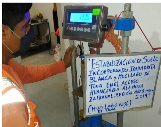
Fotografía 193. Ensayo de los moldes de CBR de 60% de Mucilago de T.
