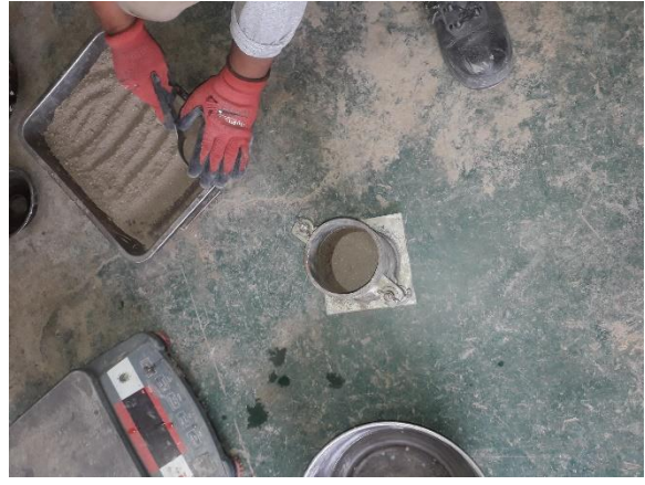
Fotografía 118. Llenado de la muestra en el molde de Proctor.
