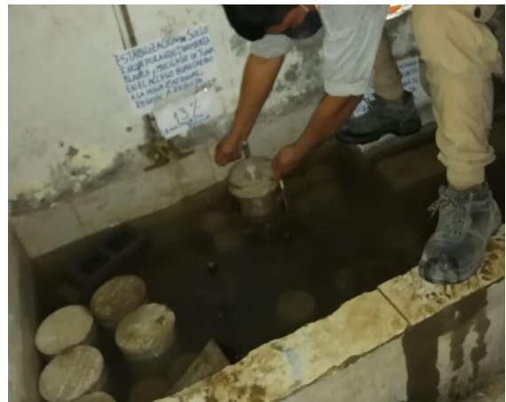
Fotografía 146. Moldes de CBR 13% sumergidos en la poza de saturación.
