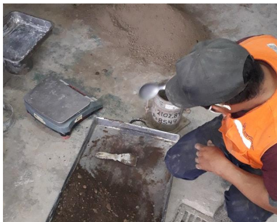
Fotografía 55. Llenado del molde CBR.
