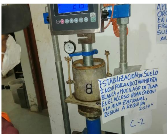
Fotografía 73. Ensayo CBR de los moldes de la C-02.
