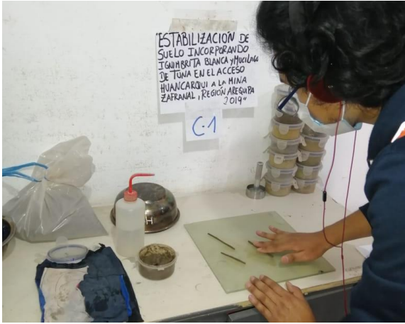
Fotografía 33. Ensayo Limite Plástico C-01.
