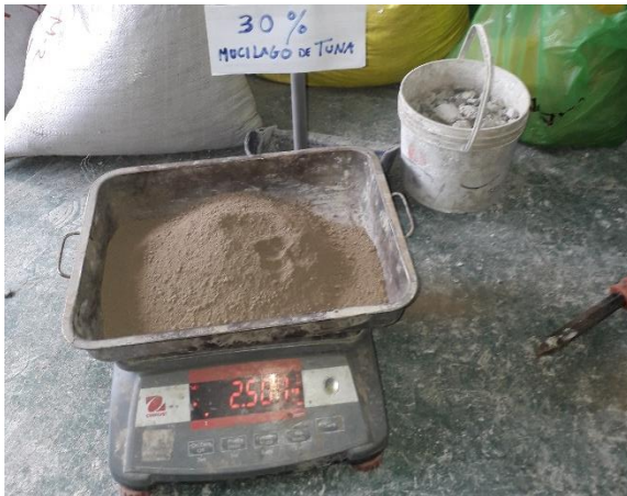
Fotografía 153. Pesado de la muestra de suelo para en ensayo Proctor M.
