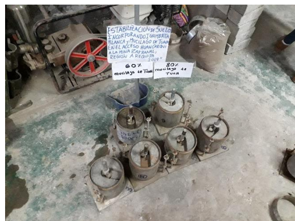
Fotografía 186. Moldes de CBR a 80% de dosifi. De Mucilago de tuna
