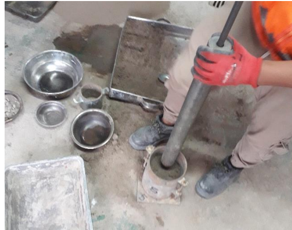
Fotografía 136. Compactado del molde CBR en 5 capas 56, 25 y 12 G.
