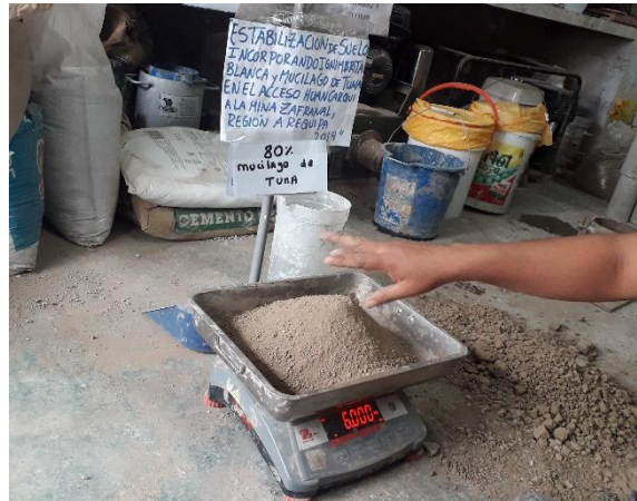
Fotografía 172. Pesado de la muestra para el ensayo CBR.
