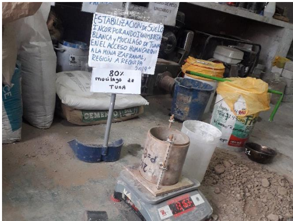
Fotografía 183. Pesado del molde CBR.
