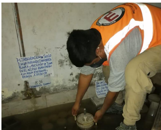
Fotografía 145. Moldes de CBR 8% sumergidos en la poza de saturación.
