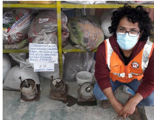
Fotografía 142. Moldes de CBR a 8% de dosifi. De ignimbrita blanca.
