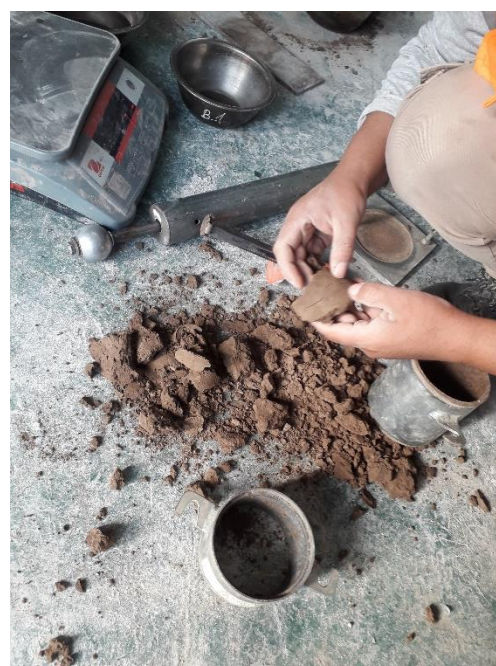
Figura 49. Muestra extraída del molde Proctor 60% de dosificación Mucilago de Tuna.
