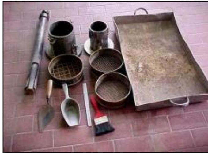
*Figura 3 Materiales para realizar el proctor modificado*
