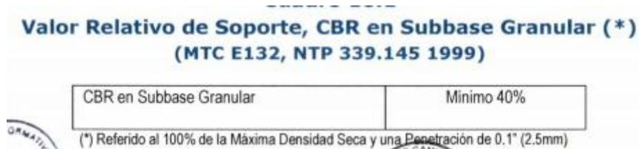
Figura 10 Valor Relativo de Soporte, CBR en Subbase Granular
