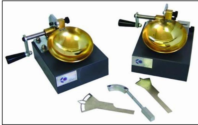
*Figura 1 Copa de Casagrande equipo para determinar los límites líquido*
