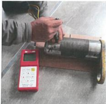
Figura 6. Medición de dureza del pin en la posición A (zona de desgaste).
