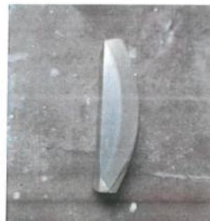
Figura 9. Probeta obtenida del pin de articulación donde se observa la capa de temple (oscuro) y la zona central (color claro).
