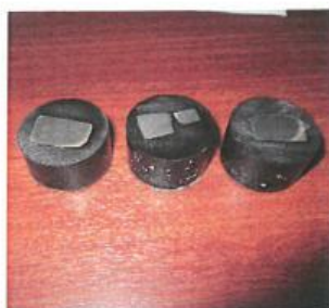
Figura 17. Probetas encapsuladas para la realización del análisis metalográfico de los pines.
