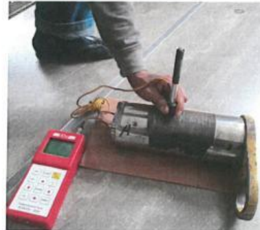
Figura 7. Medición de dureza al pin en la posición B.
