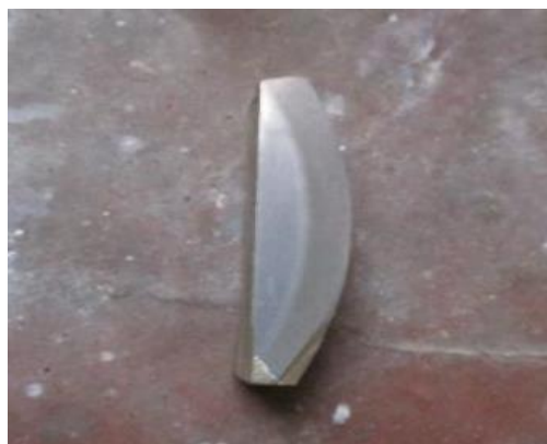
Figura 15. Probeta obtenida para medir la dureza por capa del pin desgastado.
