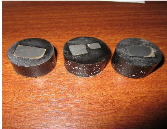
Figura 19. Probetas encapsuladas para la realización del análisis metalográfico de los pines.
