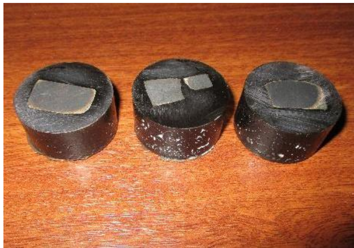
Figura 28. Probeta obtenida del pin nuevo para análisis metalográfico.
