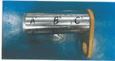
Figura 10. Foto de pin nuevo donde se indica las zonas de medición de dureza.
