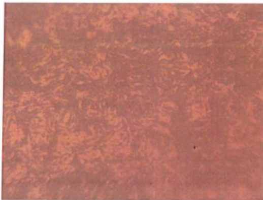
Figura 12. Fotomicrografía a la zona de temple del pin de articulación nuevo y usado. Ambos tienen la misma microestructura. La microestructura consta de martensita revenida (sorbita). Ataque químico: Nital 5%. 500X.
