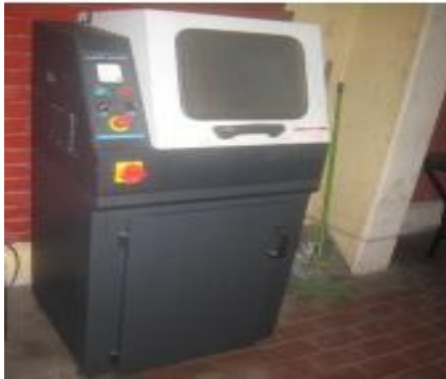
Figura 07. Máquina para corte de las probetas (BAINCUT - M)
