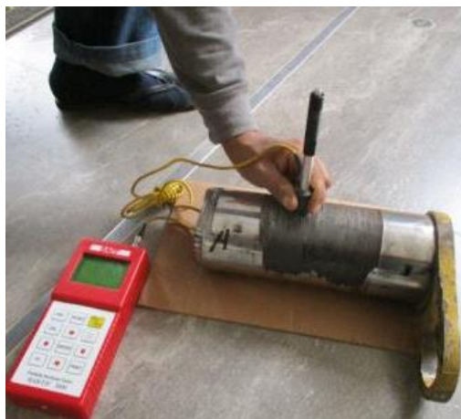
Figura 11. Medición de dureza del pin en la posición B (zona de desgaste):
