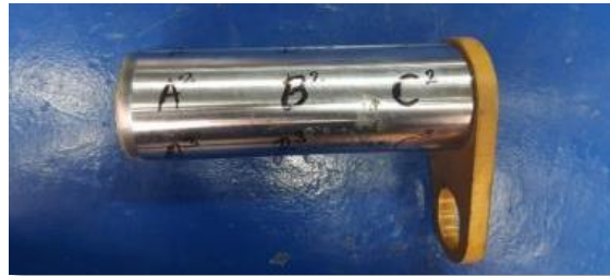
Figura 24. Zonas de medición de dureza del pin nuevo en la posición A, B Y C.
