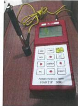
Figura 5. Durómetro portátil universal digital SAD- HARTIP 3000. Escala Rockwell C
