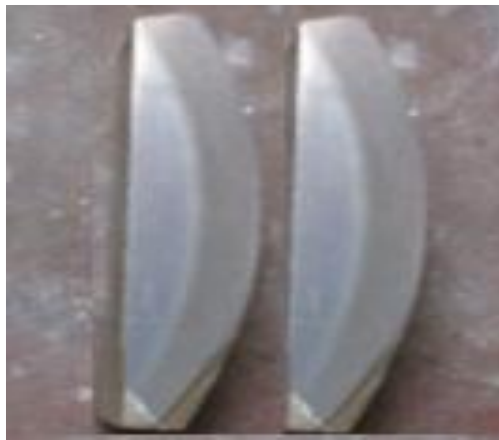
Figura 26. Probeta obtenida para medir dureza por capa del pin nuevo.
