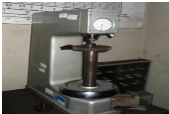
Figura 22. Durómetro analógico, escala rockwell C.
