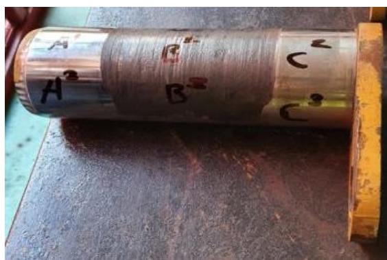
Figura 13. Pin desgastado con los tres puntos para ensayo de dureza.
