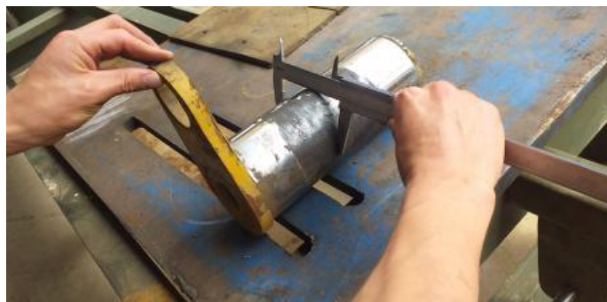
Figura 06. Medición en la parte desgastada del pin.
