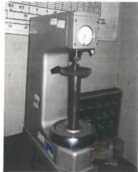
Figura 4. Durómetro analógico. Marca Frank. Escala Rockwell C
