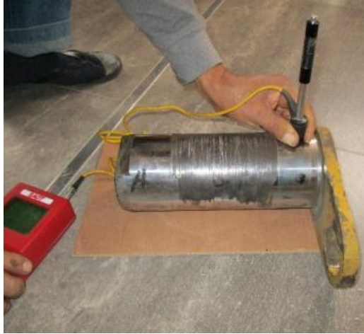
Figura 12. Medición de dureza del pin en la posición C.
