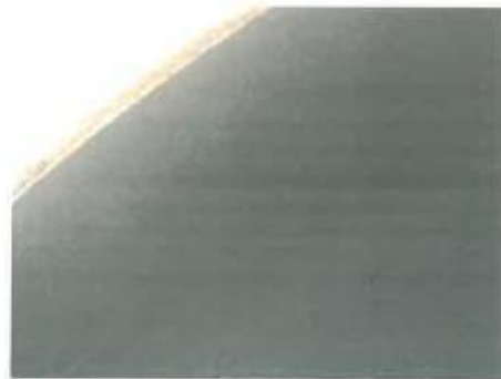
Figura 11. Fotomicrografía de la zona superficial de los pines, se observa que ambos constan de una capa periférica (color claro) de cromo duro, una capa (color oscuro) producido por el temple superficial por inducción y la zona central (color gris).
