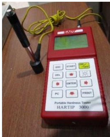
Figura 09. Durómetro portátil universal digital, escala Rockwell C.
