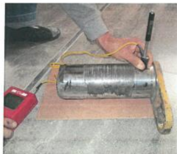
Figura 8. Medición de dureza del pin en la posición C.
