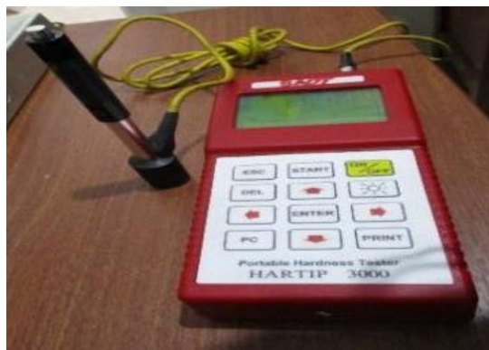
Figura 23. Durómetro portátil universal digital, escala rockwell C
