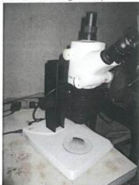
Figura 15. Microscopio estereográfico para el análisis microscópico de la estructura de capa del pin.
