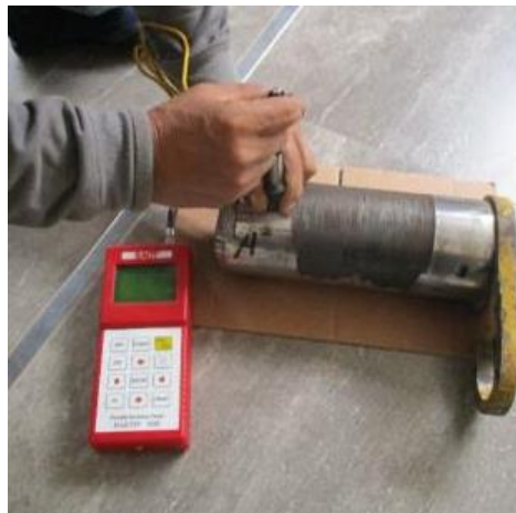
Figura 10. Medición de dureza del pin en la posición A.
