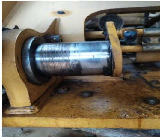
Figura 04. Desmontaje del pin.
