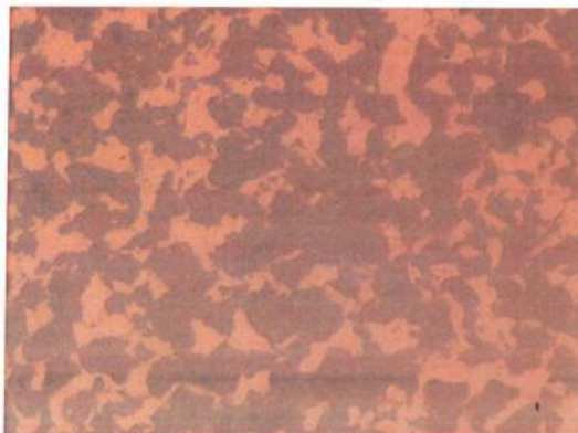
Figura 13. Fotomicrografía del núcleo del pin de articulación usado. La microestructura consta de perlita (color oscuro) y ferrita (claro). Característica de un acero hipoeutectoide. Ataque químico: Nital 5%. 500 X
