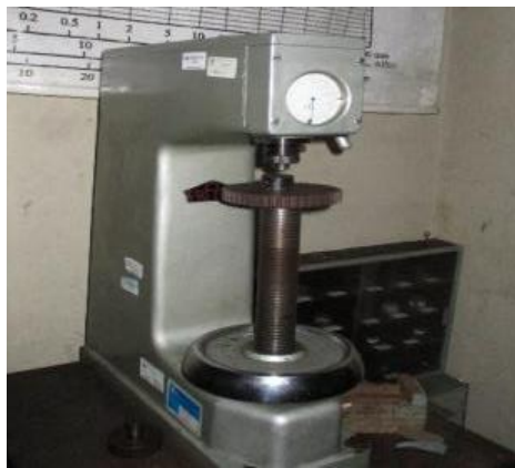
Figura 08. Durómetro analógico, escala rockwell C.
