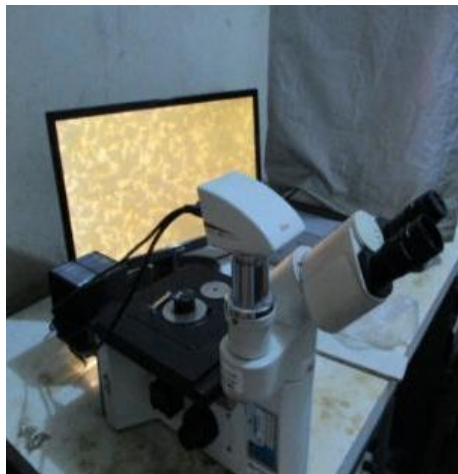
Figura 18. Microscopio Metalográfico Leica de 50-1000x.
