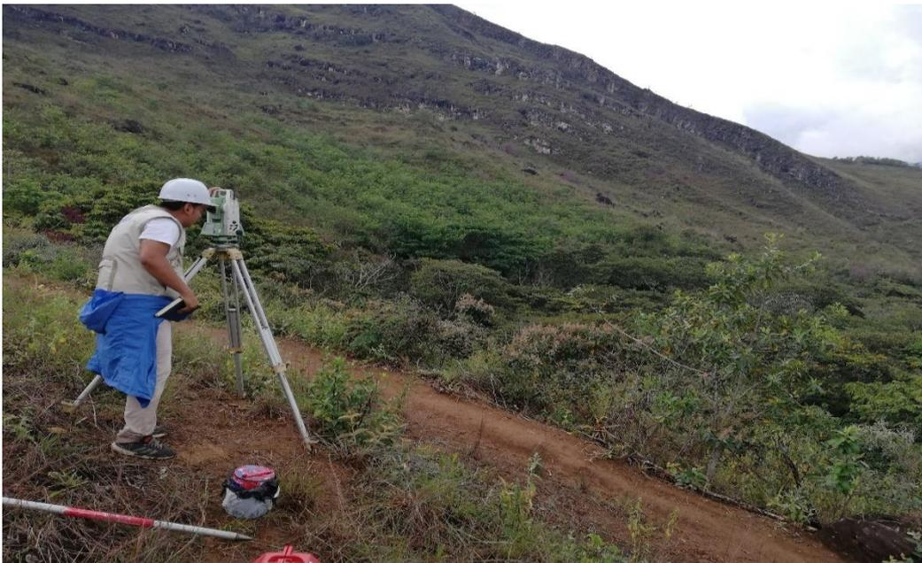
Foto N° 2: Levantamiento topográfico por el método de poligonal abierto con dos puntos conocidos
