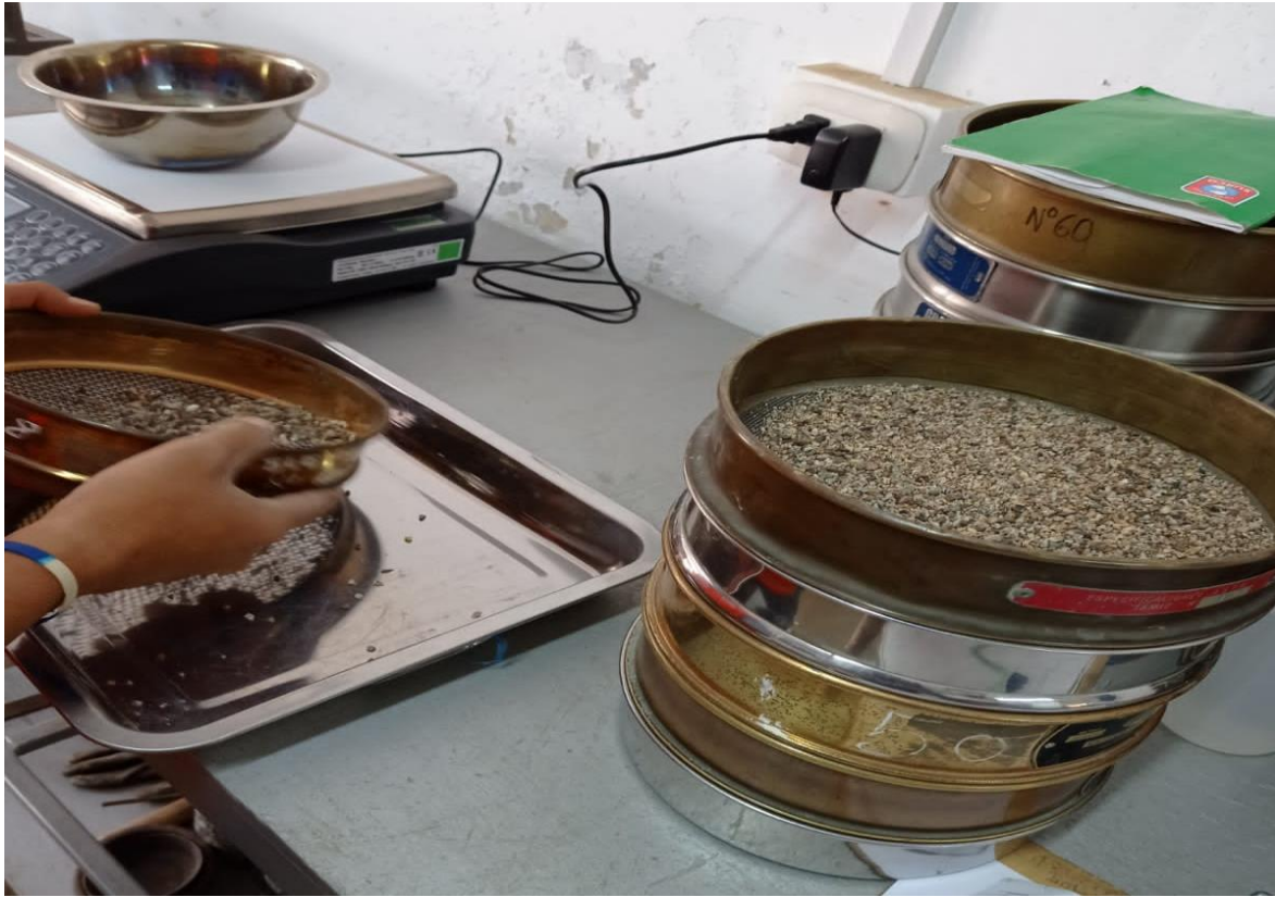
Anexo 07: Realización del ensayo de la granulometría del agregado fino.
