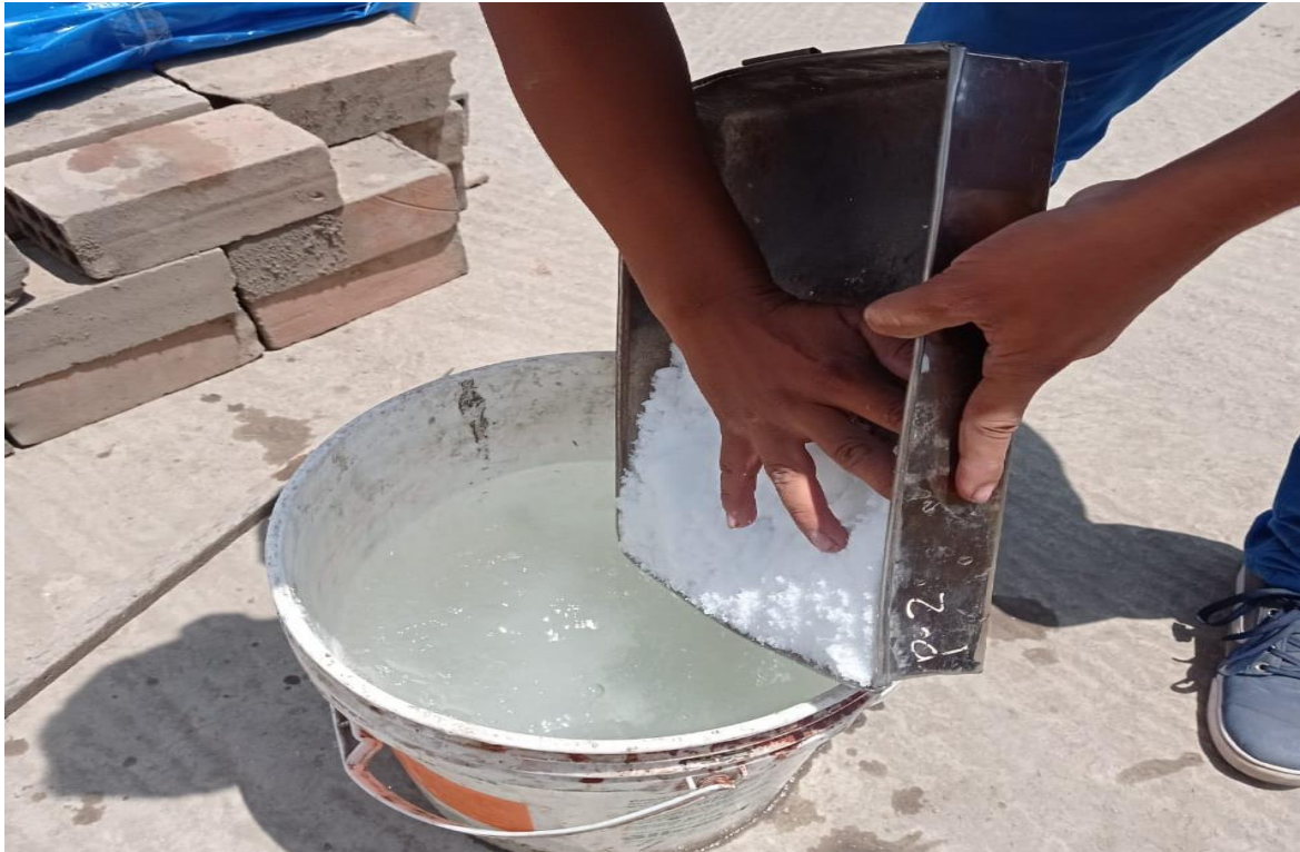
Anexo 15: Mezclar el sulfato de magnesio con el agua para disolver el agente.
