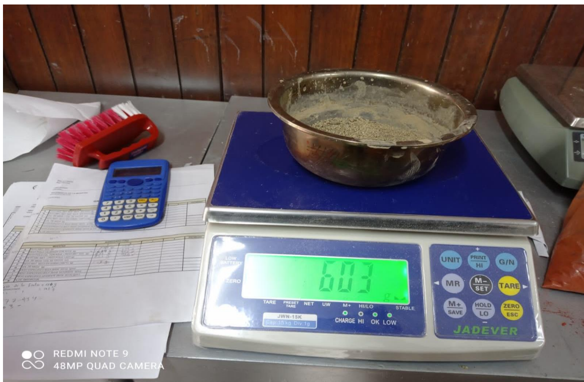
Anexo 05: Pesado del agregado fino para el respectivo ensayo de contenido de humedad y granulometría.
