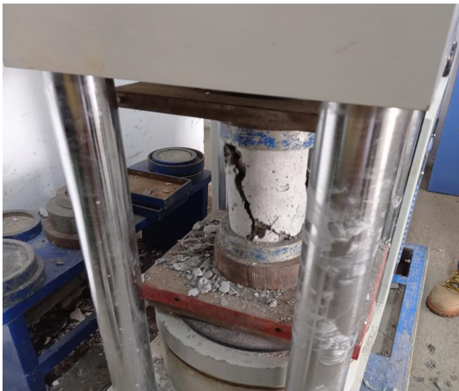
Anexo 19: Se puede observar el ensayo de la resistencia a la compresión de las probetas en curado normal
