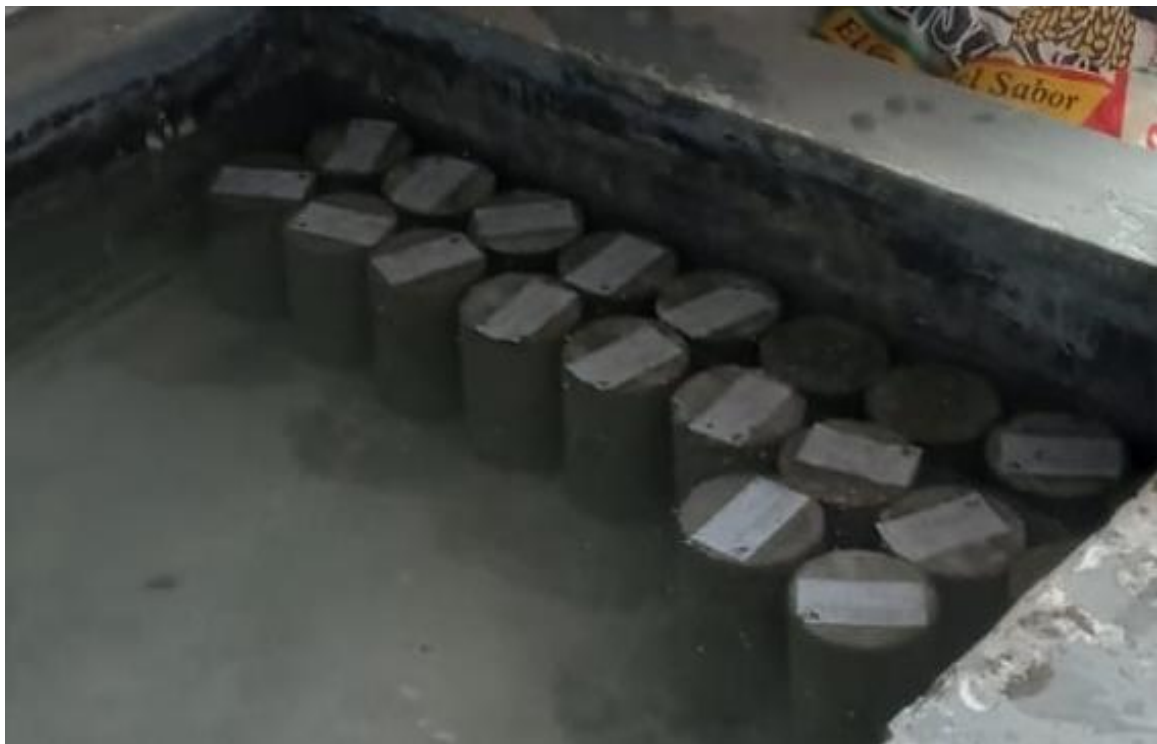
Anexo 18: Se puede observar el curado normal de las probetas.
