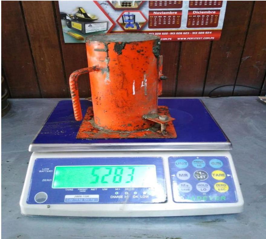
Anexo 13: Realización de pesaje de las probetas en su estado fresco.
