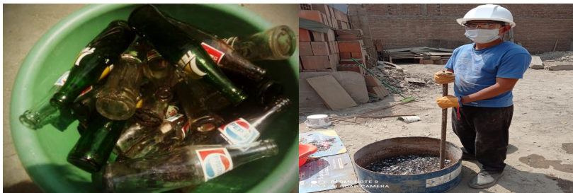
Figura 04: Obtención y triturado del vidrio
