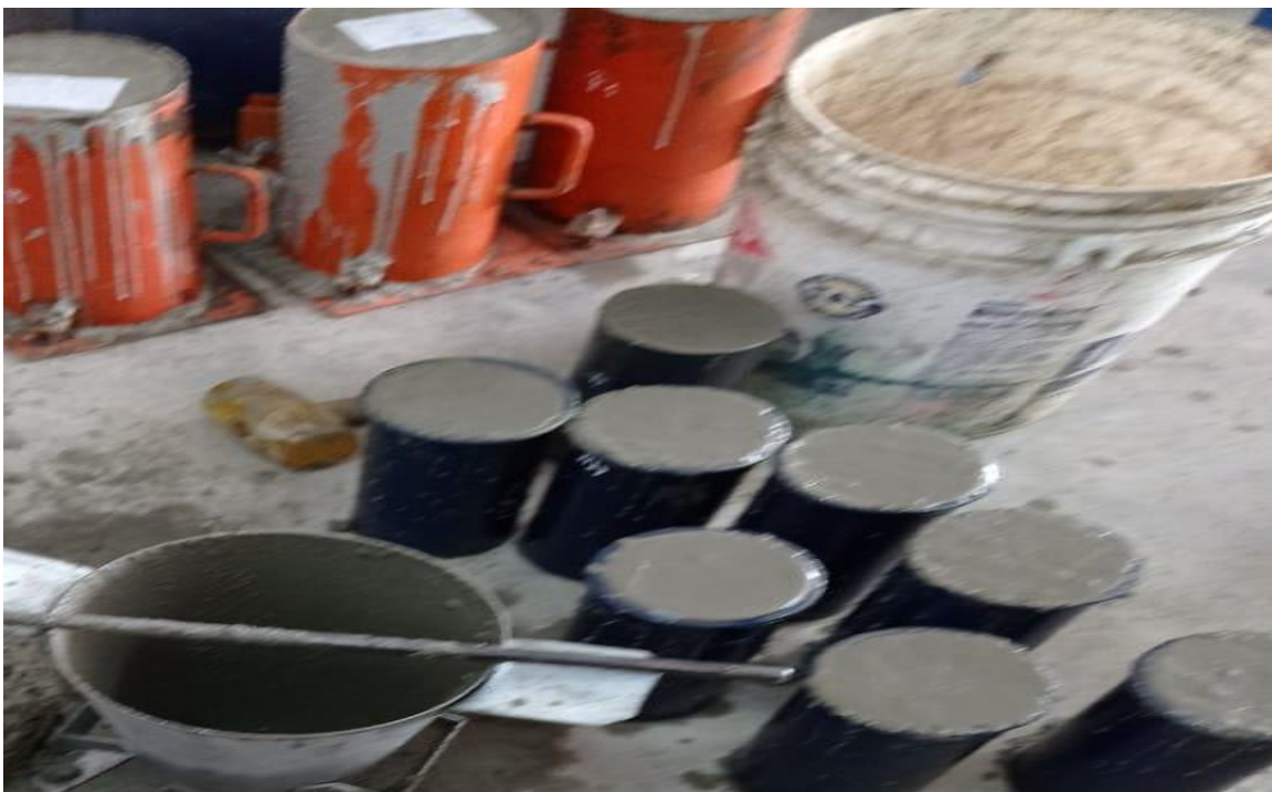
Anexo 12: Elaboración de las probetas de concreto patrón y con adición de vidrio como parte del agregado fino en 20 % y 40%.
