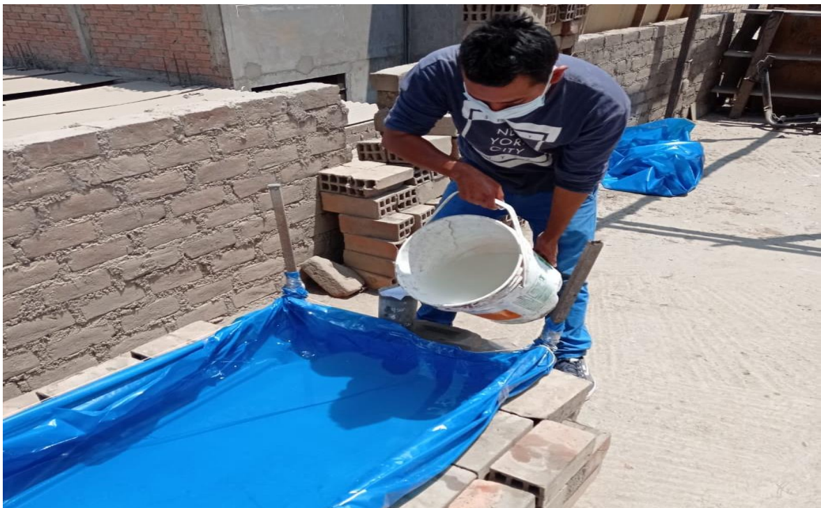
Anexo 16: Vaciar el sulfato disuelto en la fuente de curado para las probetas que se verán la durabilidad.
