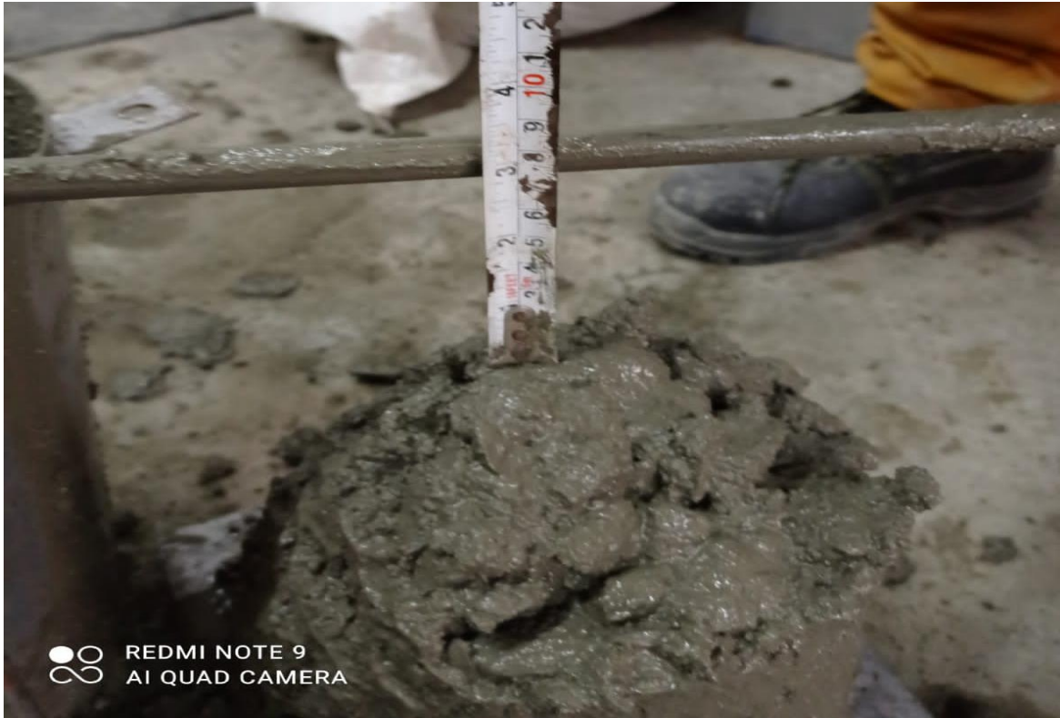
Anexo 11: Elaboración del ensayo en estado fresco del concreto, slump de 3".
