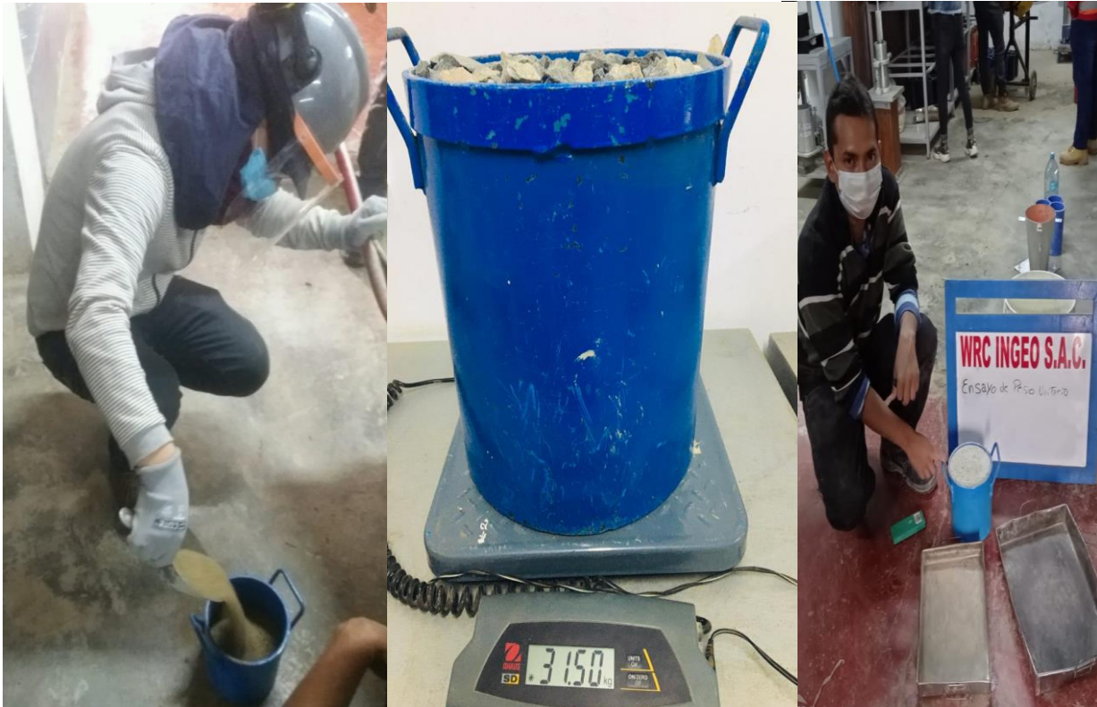
Anexo 09: Realización del ensayo del peso unitario de los agregados y del vidrio triturado.
