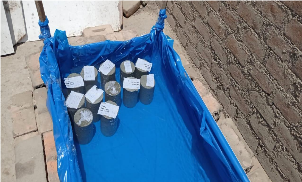
Anexo 17: Curado de las probetas que serán sometidos a ataques de sulfato de magnesio.
