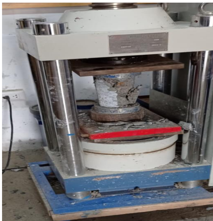
Anexo 20: Se puede observar la ruptura del concreto.
