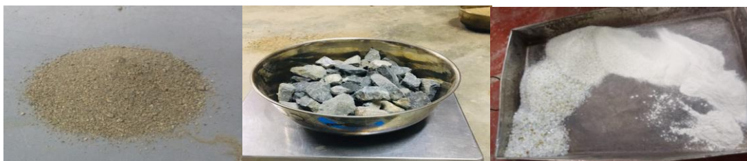
Figura 05: Agregados del concreto y vidrio triturado
