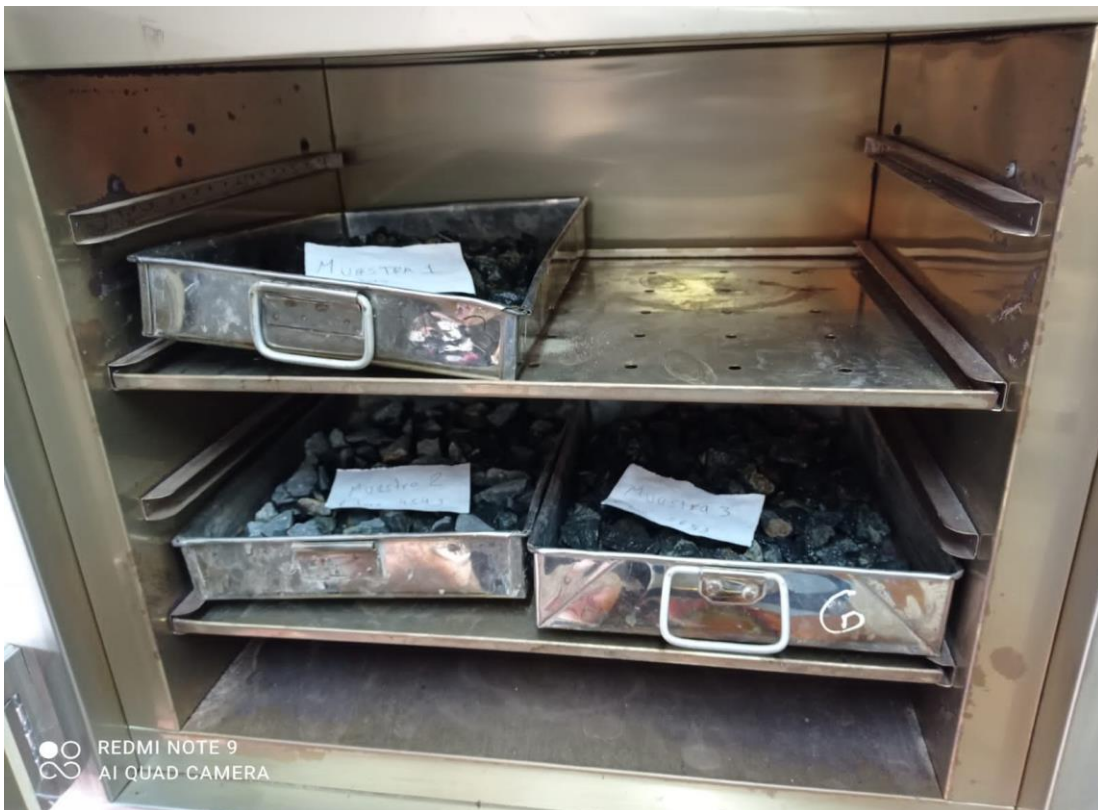
Anexo 04: Muestra del agregado grueso en el horno para determinar el contenido de humedad
