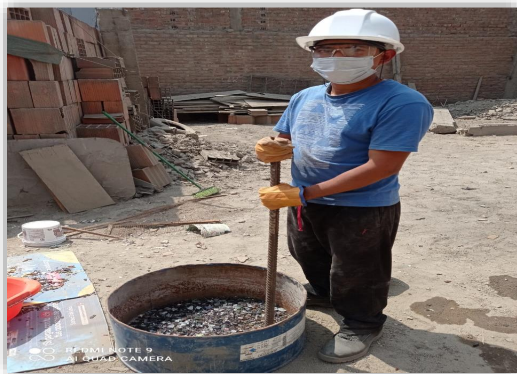
Anexo 02: La trituración del vidrio con herramientas manuales.
