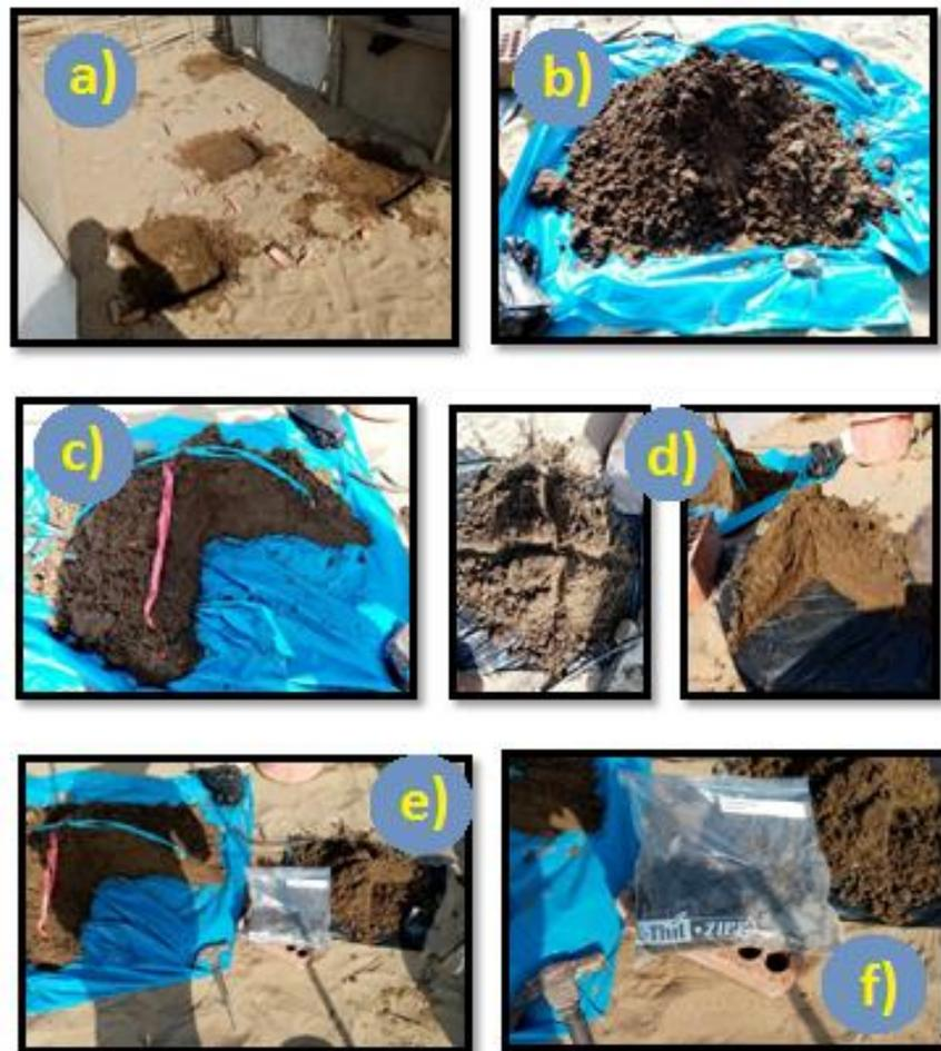
**Figura 27.** *Figura del procedimiento para la recolección de la muestra.:a) Localización y toma de puntos de muestreo, b) Muestra mezclada, c) Primera partición, d) 1/2 muestra/ Segunda partición, e) ¼ muestra y f) empaquetado para llevar a analizar*
