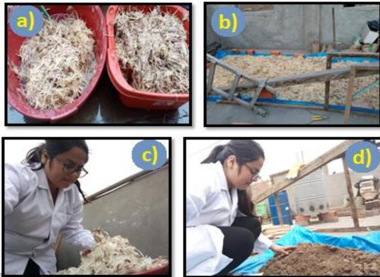
**Figura 4.** Lavado y secado de materia prima: a) lavado de plumas de pollo, b) secado de plumas de pollo, c) plumas secas y d) secadas de gallinaza.
