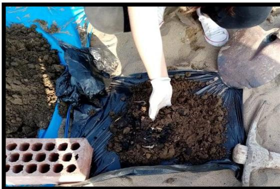
**Figura 9.** *Mezcla de suelo arenoso y biocarbón*
