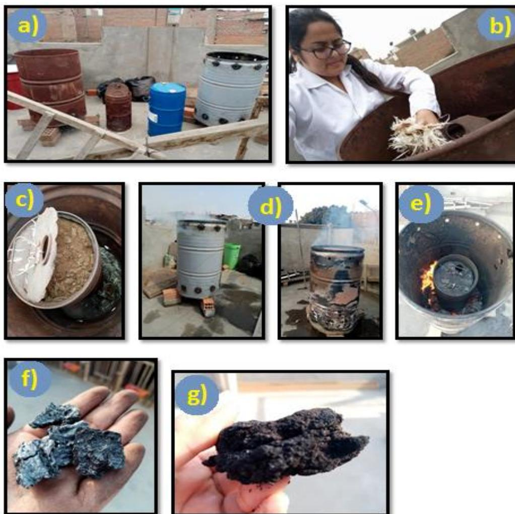
**Figura 6.** Proceso de pirólisis: a) presentación de los cilindros pirolítico, b) llenado de materia prima al cilindro, c) cilindro lleno de materia prima, d) proceso de pirólisis en ambos cilindros, e) termino de carbonización, f) biocarbón de plumas de pollo, g) biocarbón de gallinaza.
