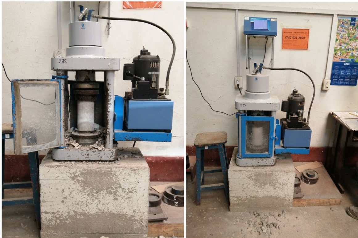
Foto 15. Colocación de la probeta de 4" x 8" en la máquina de compresión axial electro – hidráulica para proceder con en el ensayo de resistencia a compresión.
