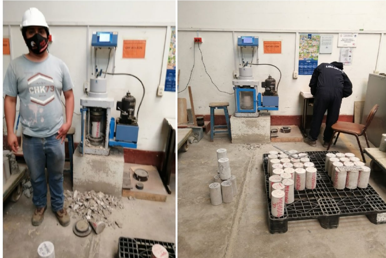
Foto 16. Ensayo de resistencia a la compresión para probetas de 4" x 8" del concreto patrón y mezclas por sustitución con agregados no convencionales.
