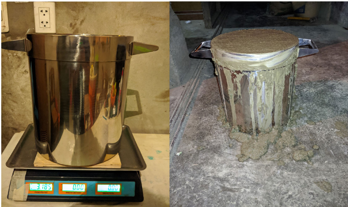
Foto 13. Peso unitario del concreto en estado fresco.
