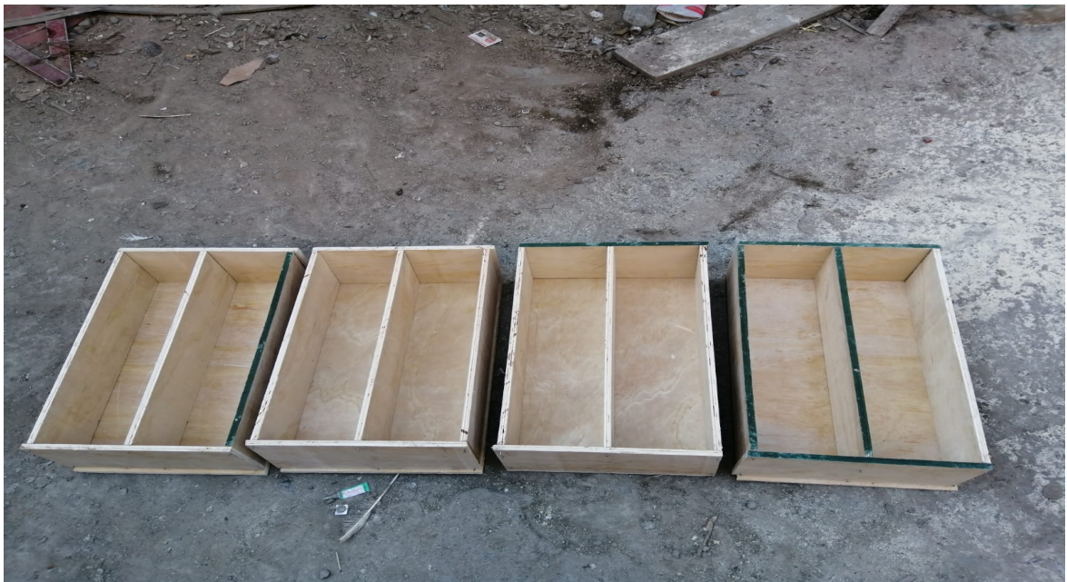
Foto 11. Fabricación de moldes de madera para ensayar vigas de concreto a flexión.
