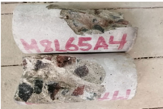
Foto 19. Fallas en concreto L65A4.
