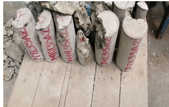
Foto 18. Fallas en concreto L35A2.
