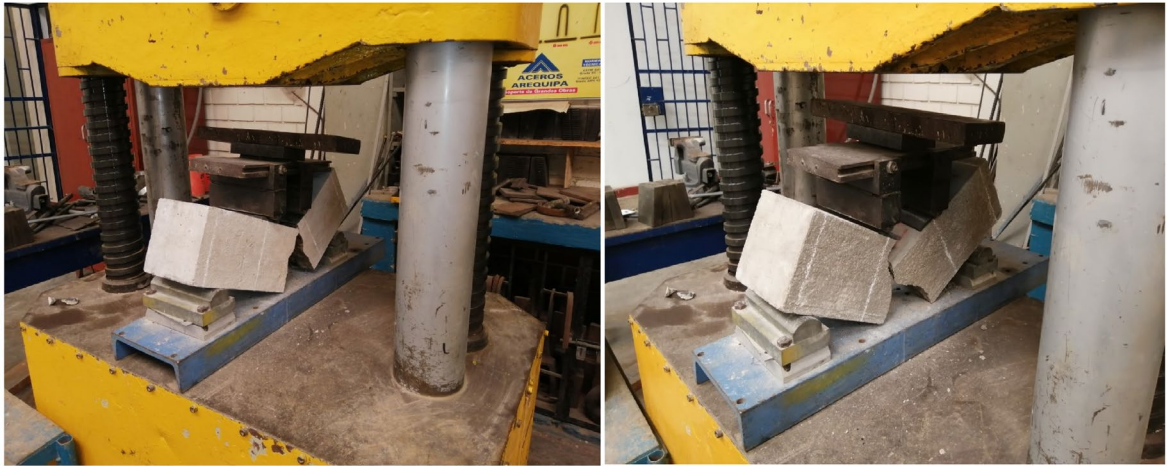
Foto 25. Fallas en vigas de concreto de 6" x 6" x 20".
