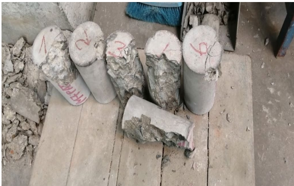
Foto 17. Fallas en concreto patrón.
