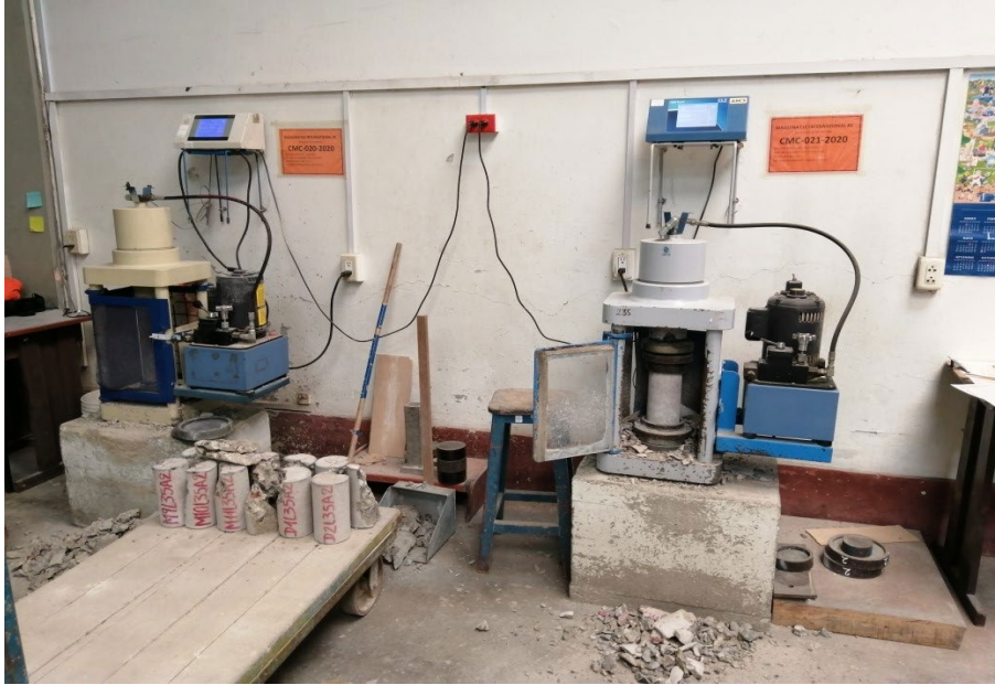
Foto 14. Máquinas de compresión axial electro – hidráulica con certificado de calibración CMC-020-2020 y CMC-021-2020 del laboratorio UNI - LEM.
