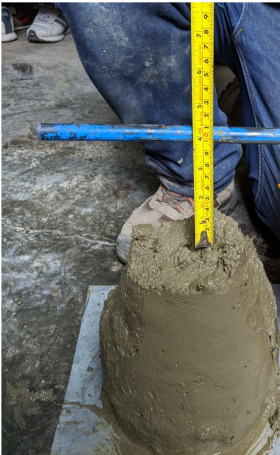
Foto 7. Medición del slump del concreto.
