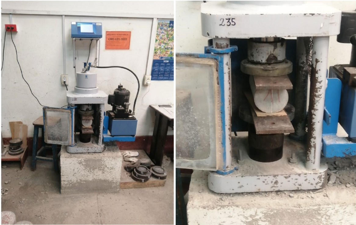
Foto 21. Colocación de la probeta de 4" x 8" en la máquina de compresión axial electro – hidráulica para proceder con en el ensayo de resistencia a tracción por compresión diametral.
