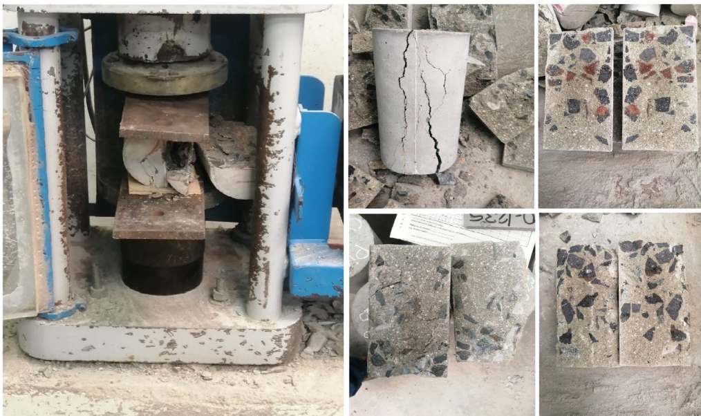
Foto 22. Ensayo de resistencia a la tracción por compresión diametral para probetas de 4" x 8" del concreto patrón y mezclas por sustitución con agregados no convencionales.
