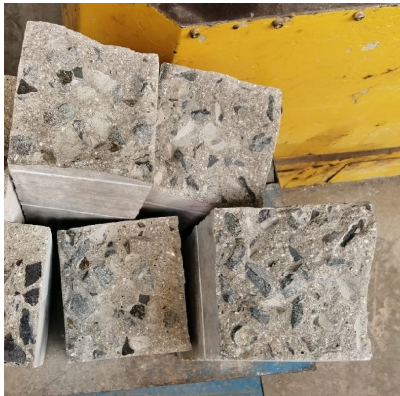
Foto 26. Vista interior de la viga de concreto patrón.
