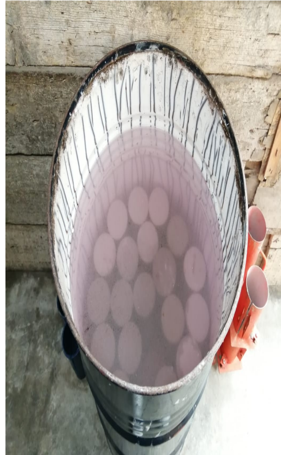
Foto 10. Curado del concreto.
