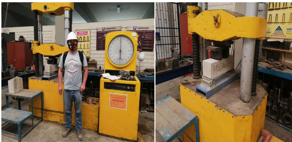
Foto 24. Colocación de viga de 6" x 6" x 20" en la máquina Tokyokoki Seizosho – Universal de 20 Tn para proceder con en el ensayo de resistencia a la flexión.
