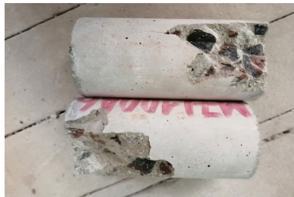
Foto 20. Fallas en concreto L100A6.
