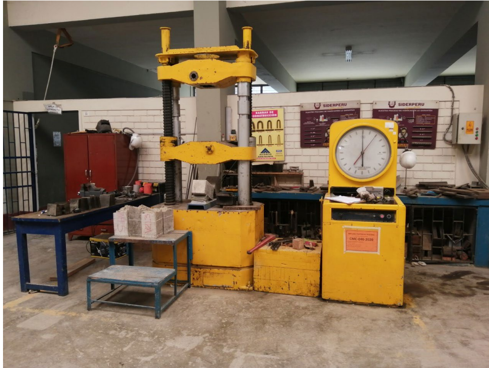
Foto 23. Máquina Tokyokoki Seizosho – Universal de 20 Tn con certificado de calibración CMC-046-2020 del laboratorio UNI - LEM.
