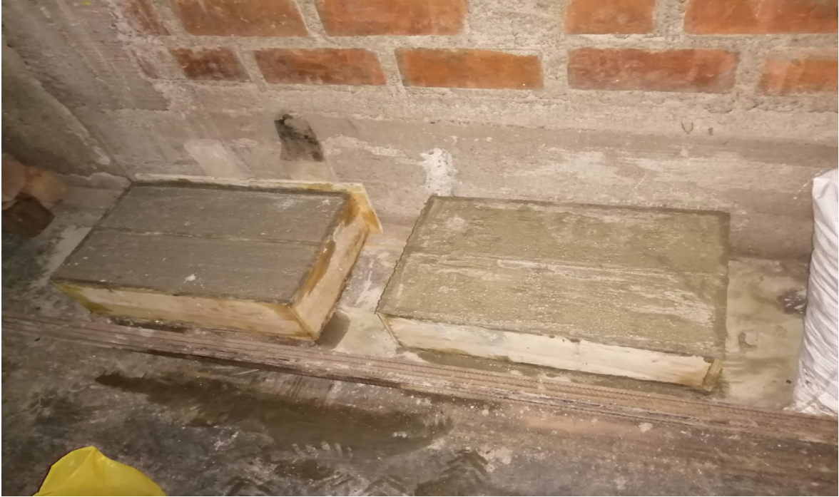
Foto 12. Vista de vigas de concreto vaciadas.
