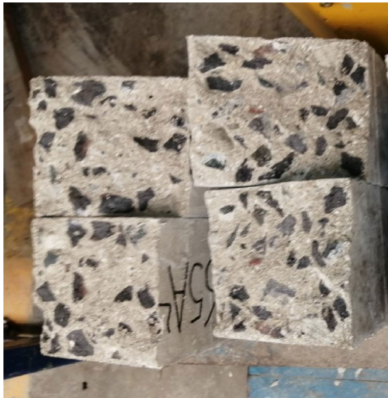
Foto 28. Vista interior de la viga de concreto L65A4.
