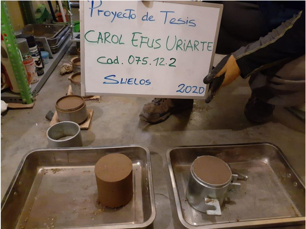
Testigos de compresión de suelos
