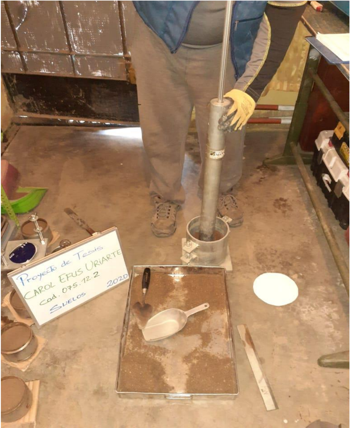
Ensayo Proctor modificado
