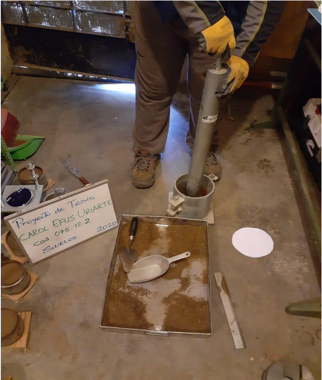
Ensayo Proctor modificado
