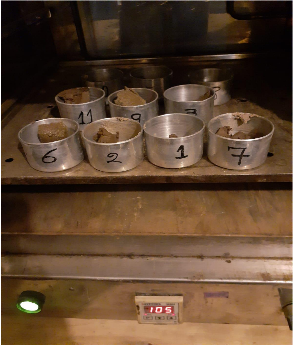
Temperatura de control de secado de muestra
