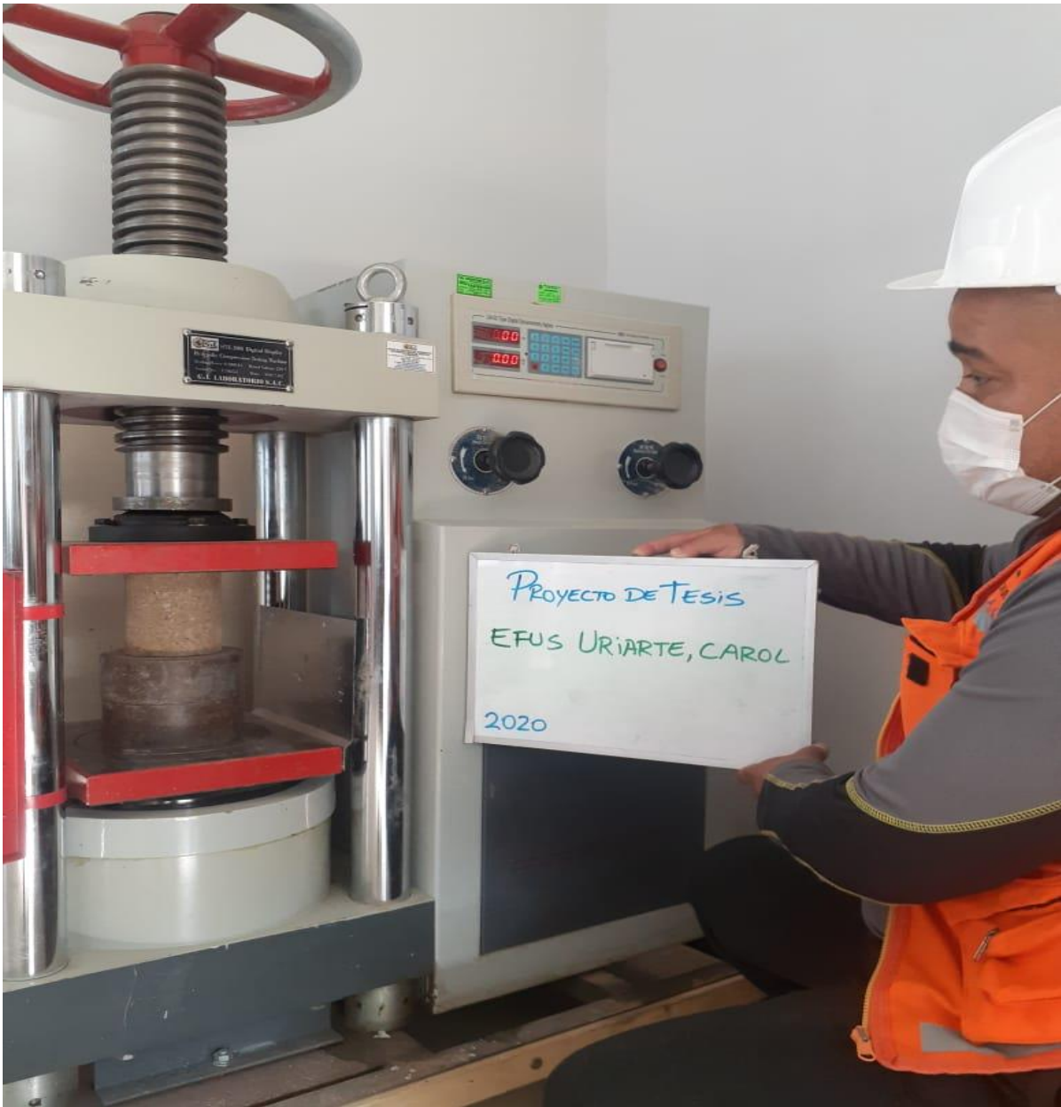
Ensayo de compresión de suelos.
