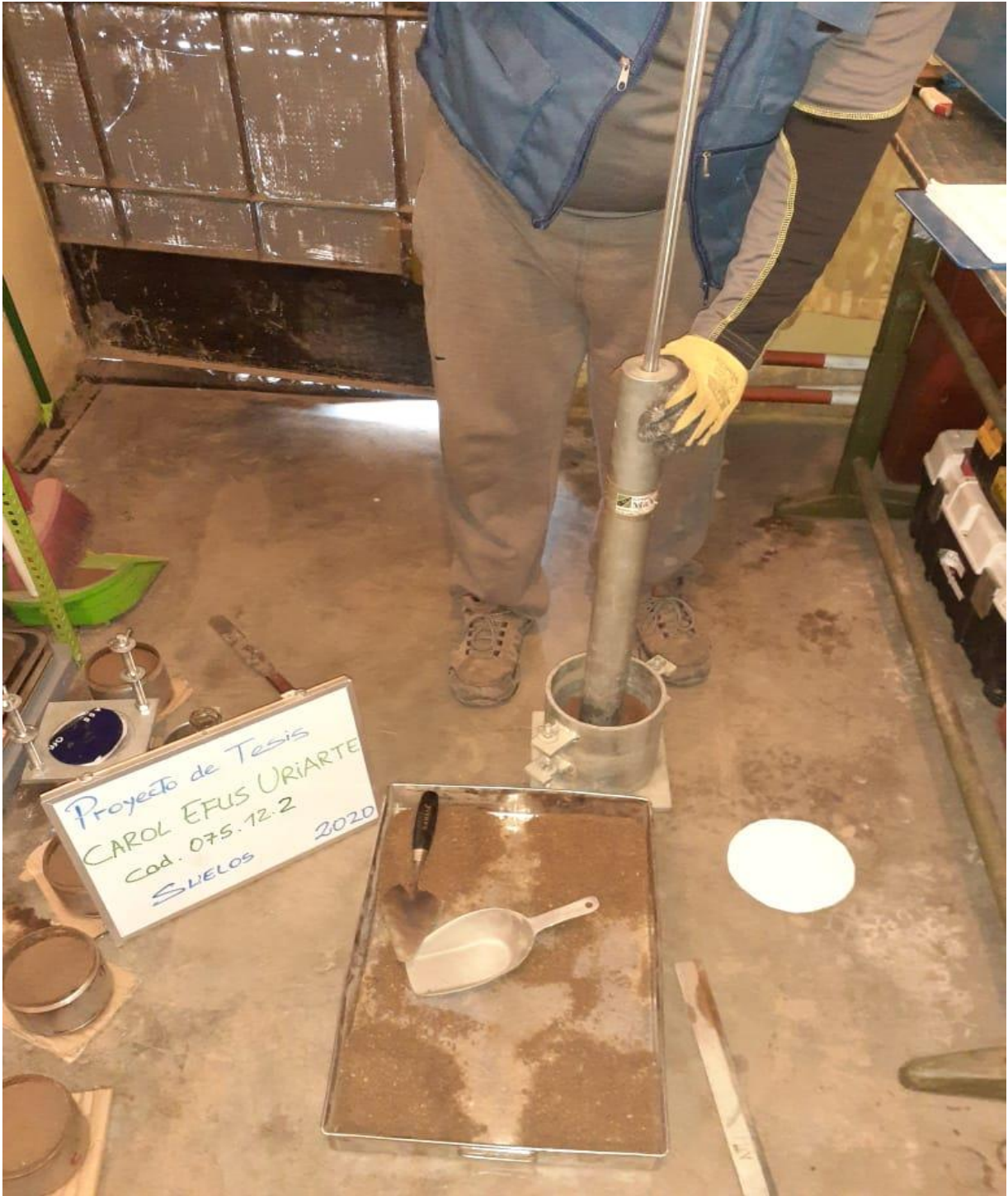
Ensayo Proctor modificado
