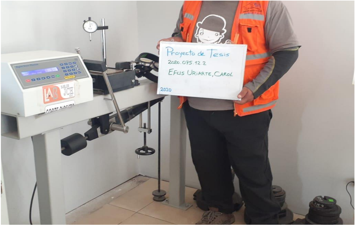
Ensayo corte directo de suelo
