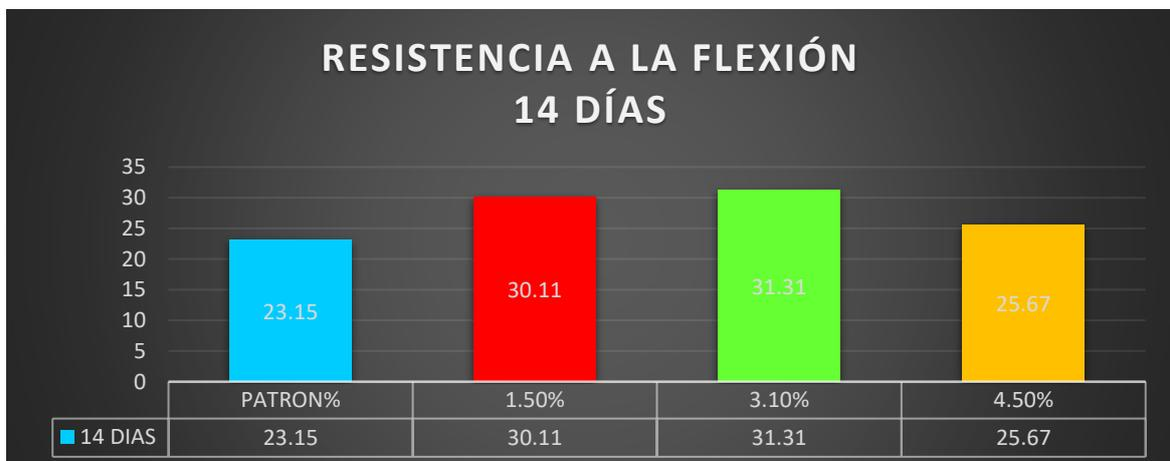
*Figura 13.* Comparación de las resistencias a la flexión en 14 días.
