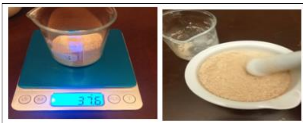
Figura 12. Desacetilación de la quitina para la obtención de quitosano.
