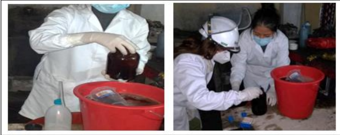
Figura 20. Toma de muestra de AyG y su preservación.
