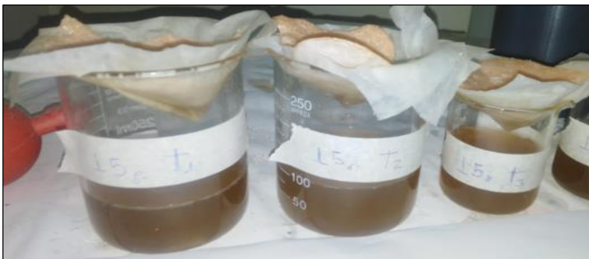
Figura 24. Tratamiento de adsorción de tres concentraciones de esponja de quitosano.
