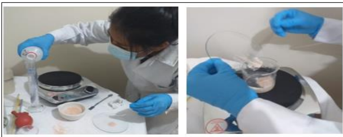
Figura 13. Mezcla de concentración de quitosano con solución de ácido acético 0,3 M.
