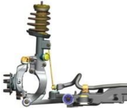
Figura N° 32 Sistema de suspensión de Muelles
