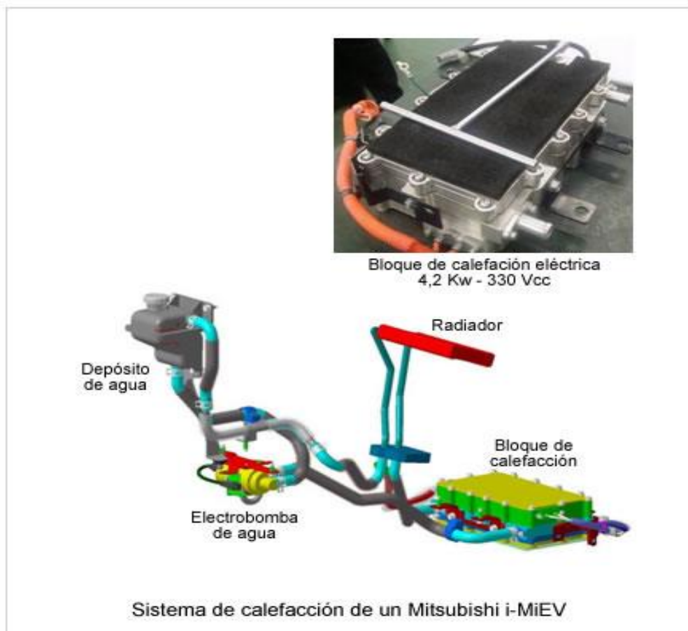
Figura N° 26 Sistema de Calefacción
