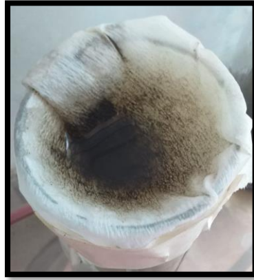
Figura 17. Filtrado de óxido de grafeno reducido
