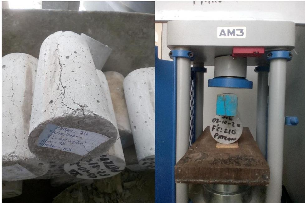
Figura 39. Prueba a tracción
