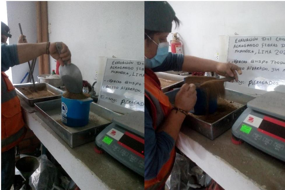
Figura 10. Peso unitario suelto y compactado de agregado fino
