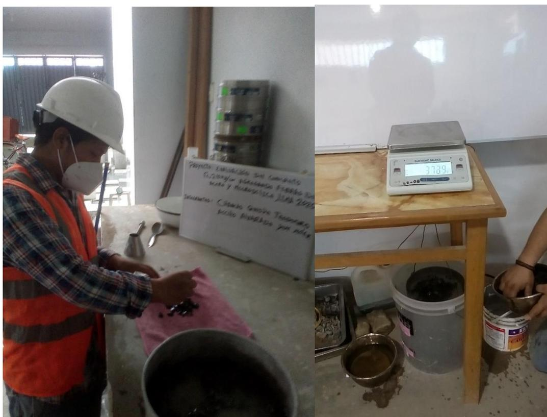
Figura 13. Secando la muestra y pesando la muestra en agua
