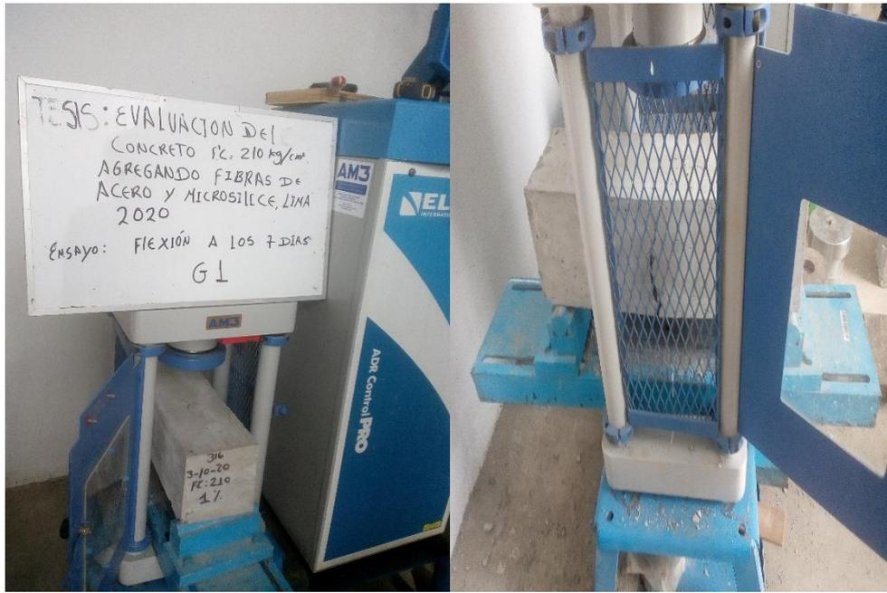
Figura 48. Vigas ensayadas a flexión
