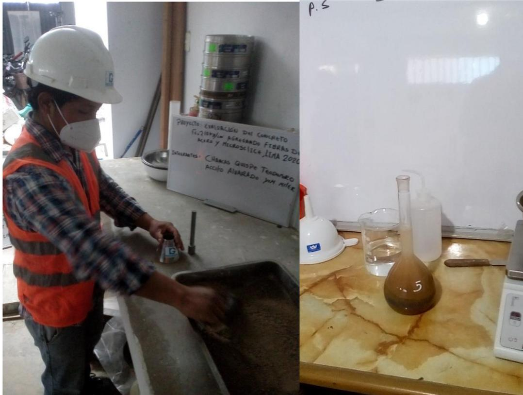
Figura 12. Conito de arena, y fiola con la muestra
