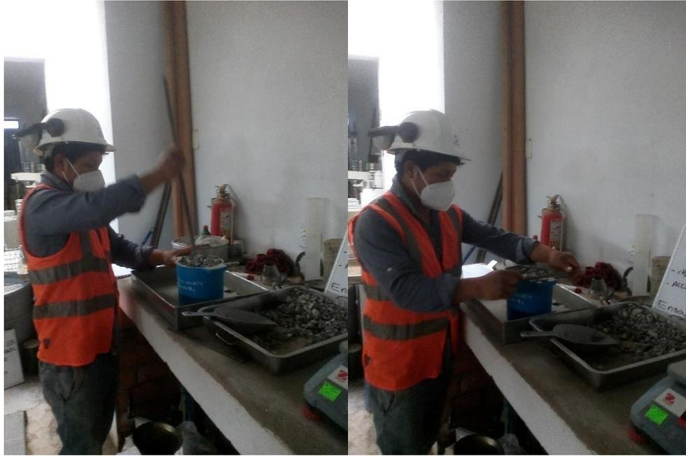
Figura 11. Peso unitario suelto y compactado del agregado grueso
