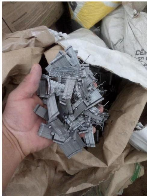
*Figura 4. Fibras de acero Sikafiber CHO 65/35 NB*
