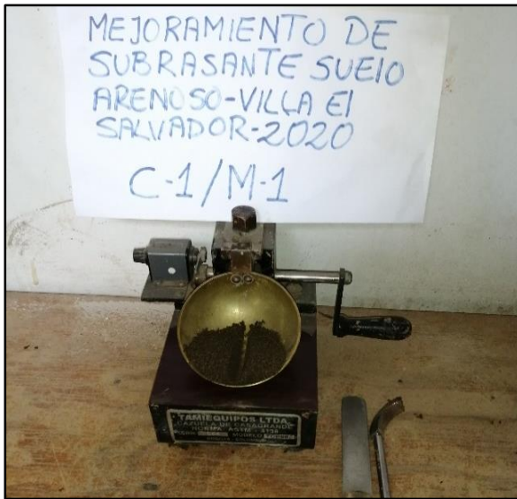
Ilustración 7: Límite de consistencia
