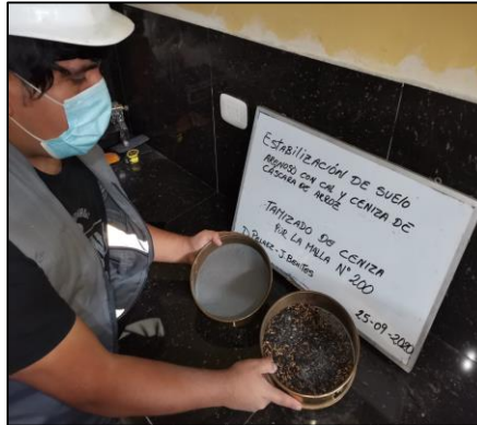
Ilustración 19: Tamizado de Ceniza de Cáscara de arroz
