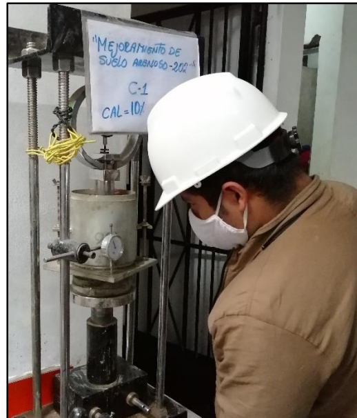
Ilustración 10: Ensayo de C.B.R.
