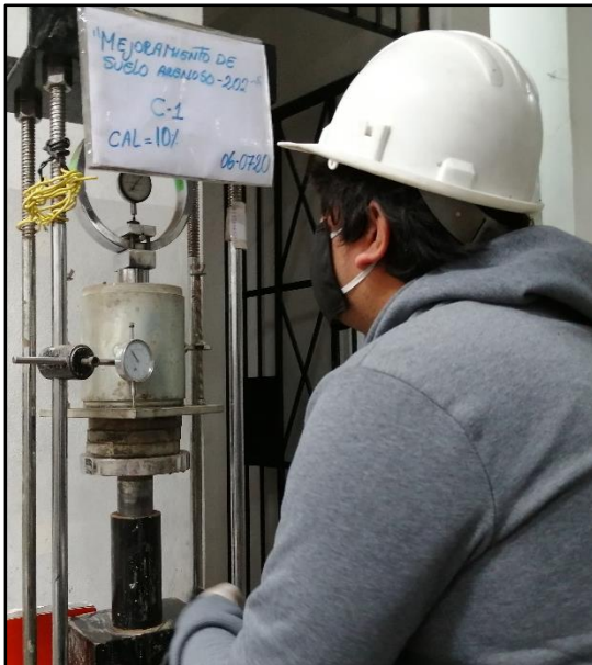
Ilustración 9: Ensayo de C.B.R.
