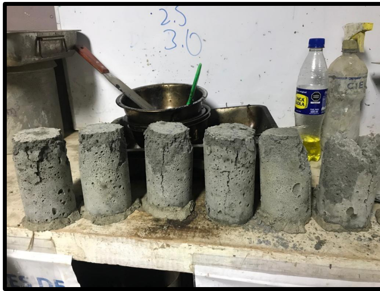
Figura 35. Rotura de probetas a compresión
