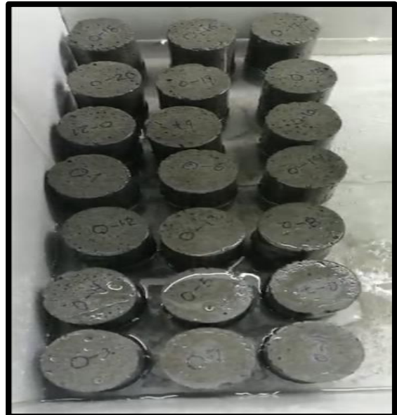
Figura 32. Curado de testigos de Concreto Celular
