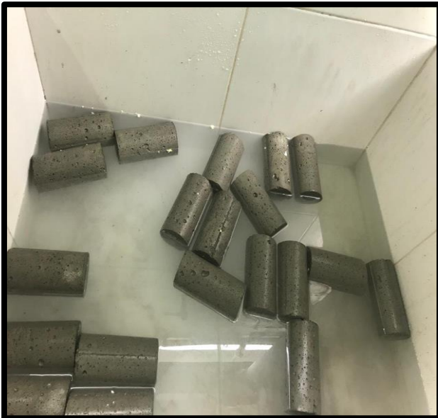
Figura 32. Curado de testigos de Concreto Celular
