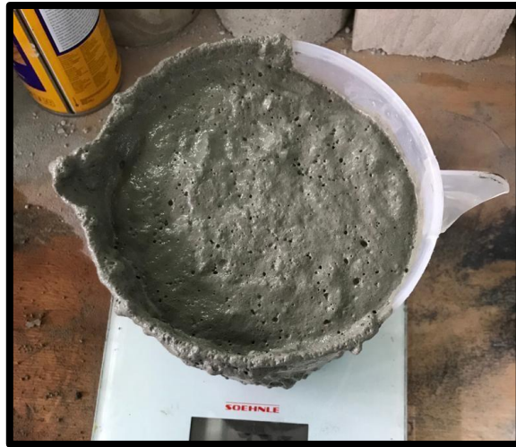
Figura 29. Determinación del peso unitario del Concreto Celular
