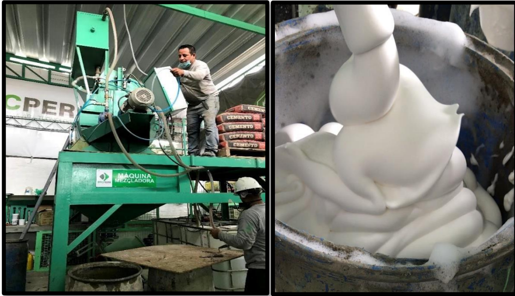
Figura 13. Espuma producida mediante el método de prespumado
