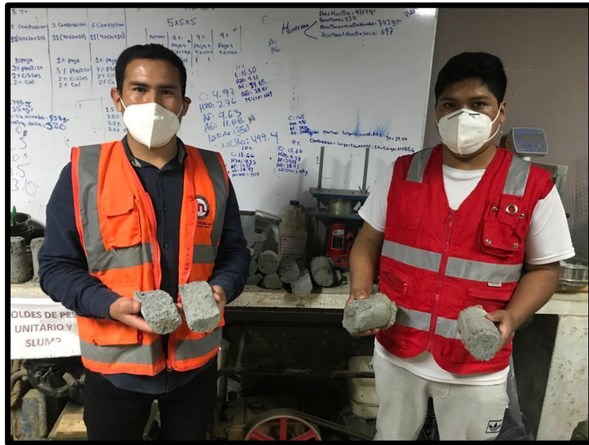
Figura 38. Probetas ensayadas en laboratorio para resistencia a la compresión y tracción.
