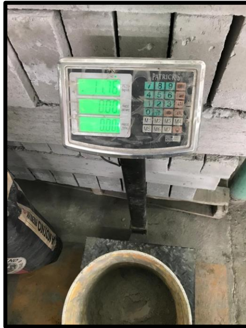
Figura 21. Pesaje de cemento
