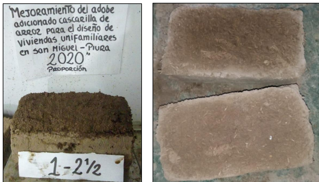
Figura 8. Dosificación suelo-arena gruesa más óptima
