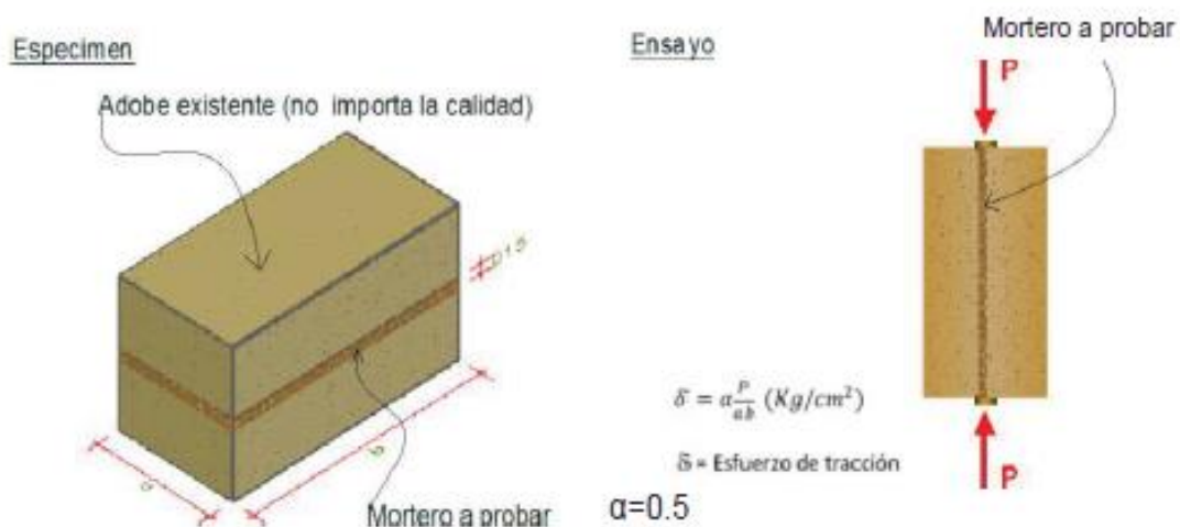
Figura 7. Ensayo de resistencia del mortero a la tracción
