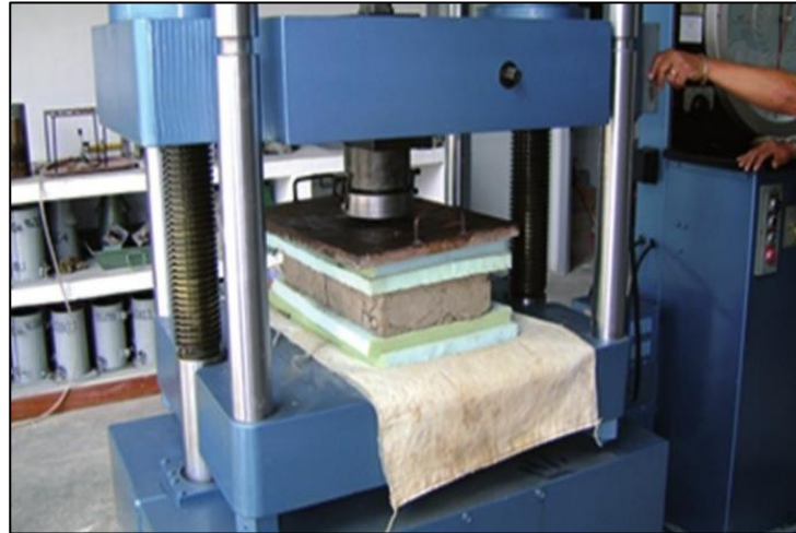
Figura 2. Ensayo de compresión en bloque de adobe.
