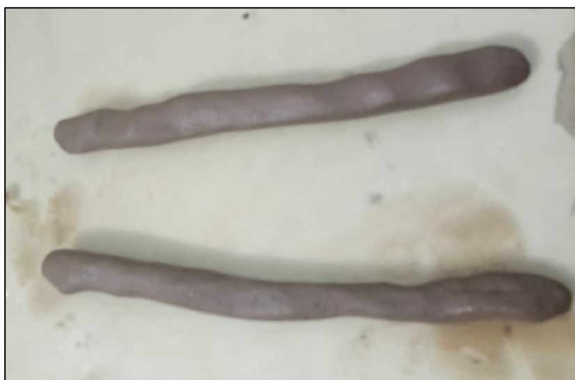
Figura 5. Prueba cinta de barro.
