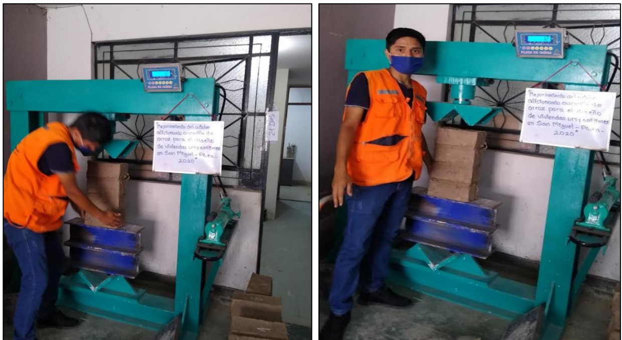
Figura 42. Ensayo de compresión en pilas de adobe.
