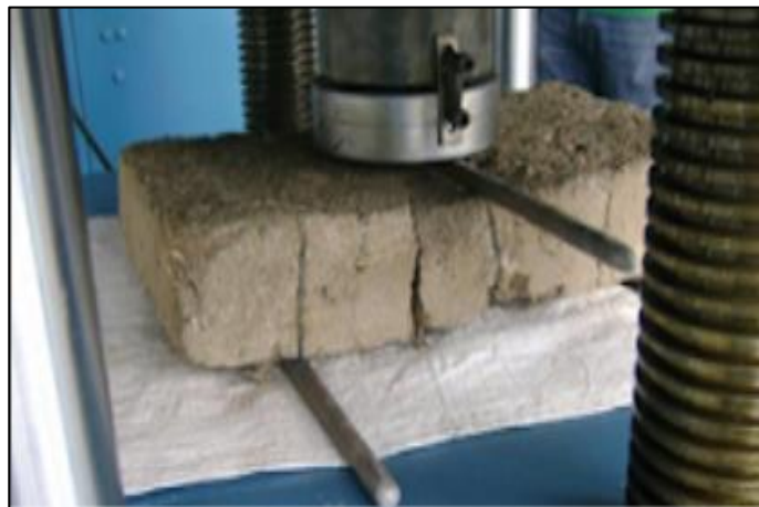
Figura 4. Ensayo a flexión en bloque de adobe.
