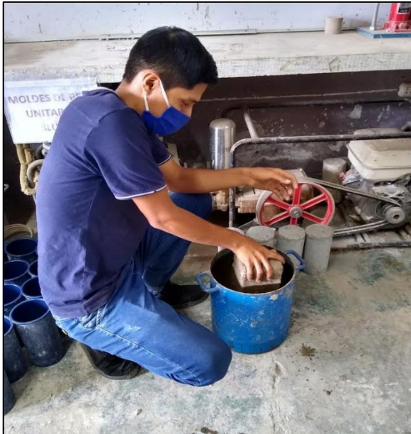
Figura 43. Ensayo de absorción del adobe.
