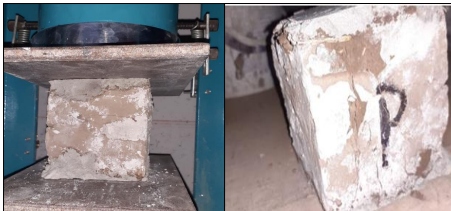
Figura 38. Ensayo a compresión en el molde de 10x10x10 cm.
