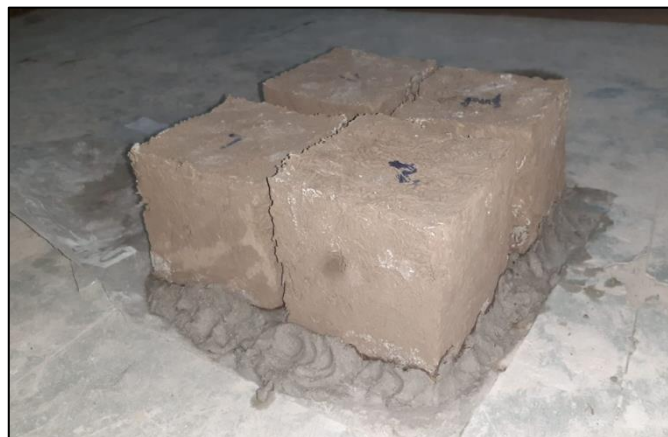
Figura 36. Refrentado de la muestra de 10x10x10 cm.
