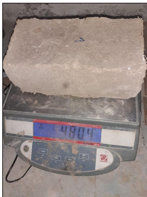
Figura 44. Pesado del bloque de adobe.
