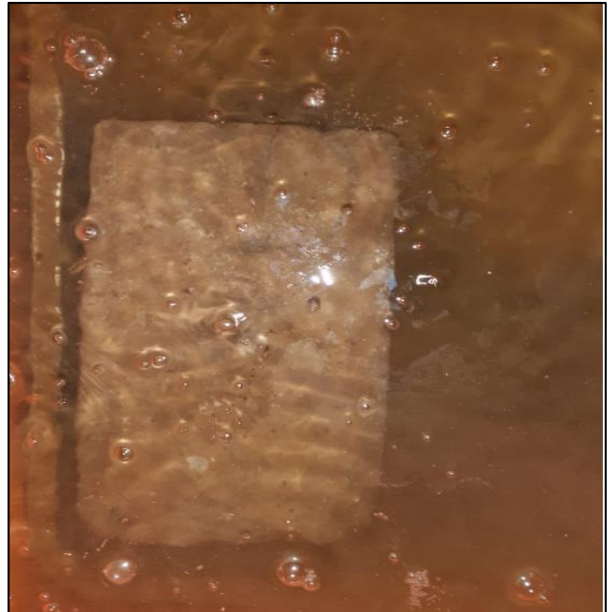
Figura 43. Ensayo de absorción del adobe.
