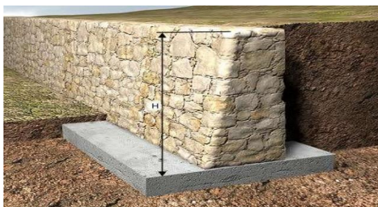
Figura 3. Muro de Mampostería
