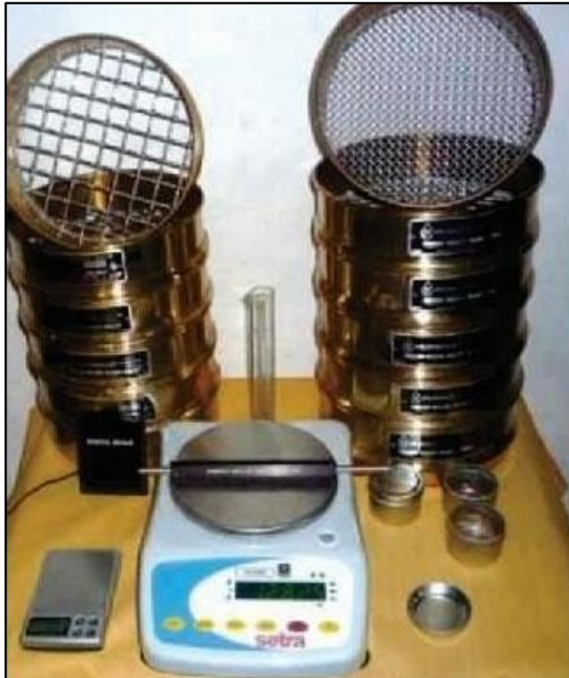
Instrumentos de tamizado para determinar la granulometría del suelo.
