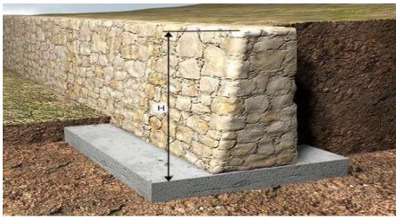
Figura 3. Muro de Mampostería.
