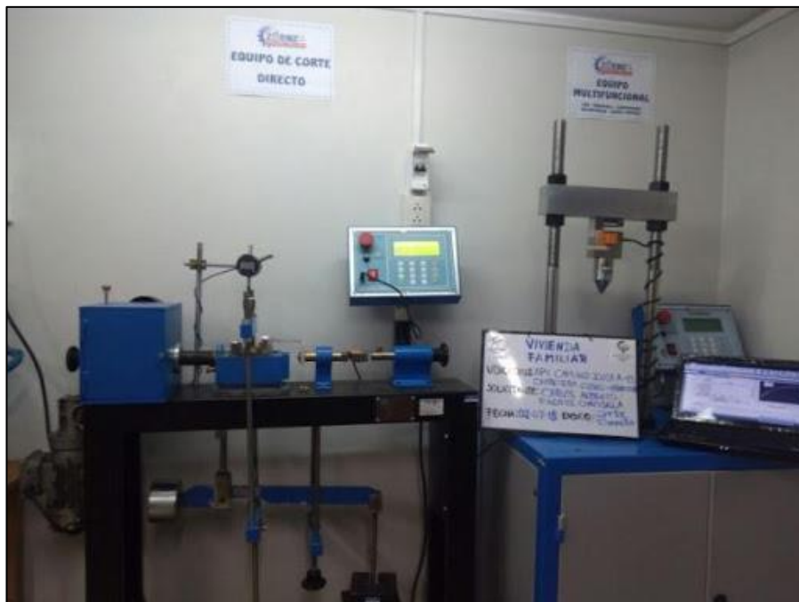
Equipo de corte directo, del cual se obtendrá el ángulo de fricción, para los cálculos de estabilidad a los asentamientos por fallas al corte.
