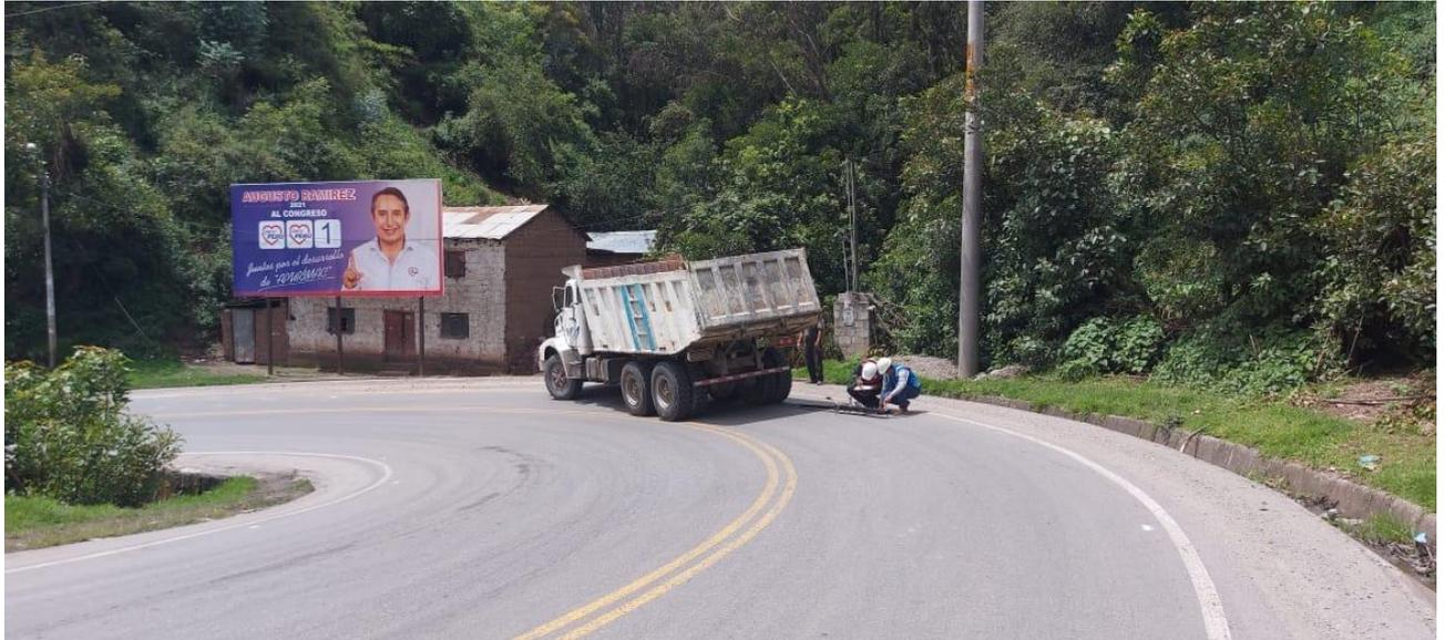
Figura N°05: lectura de diales de la viga Benkelman carril derecho zona de curva N°02
