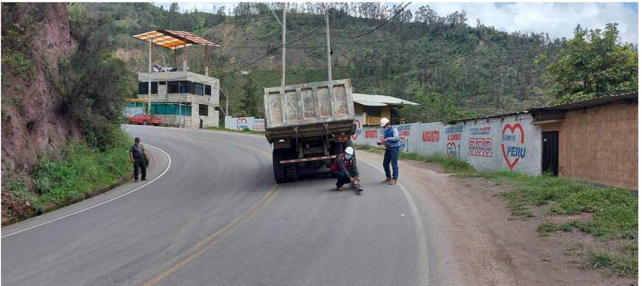
Figura N°08: Toma de lecturas de la viga Benkelman en carril izquierdo de la zona de curva n°03
