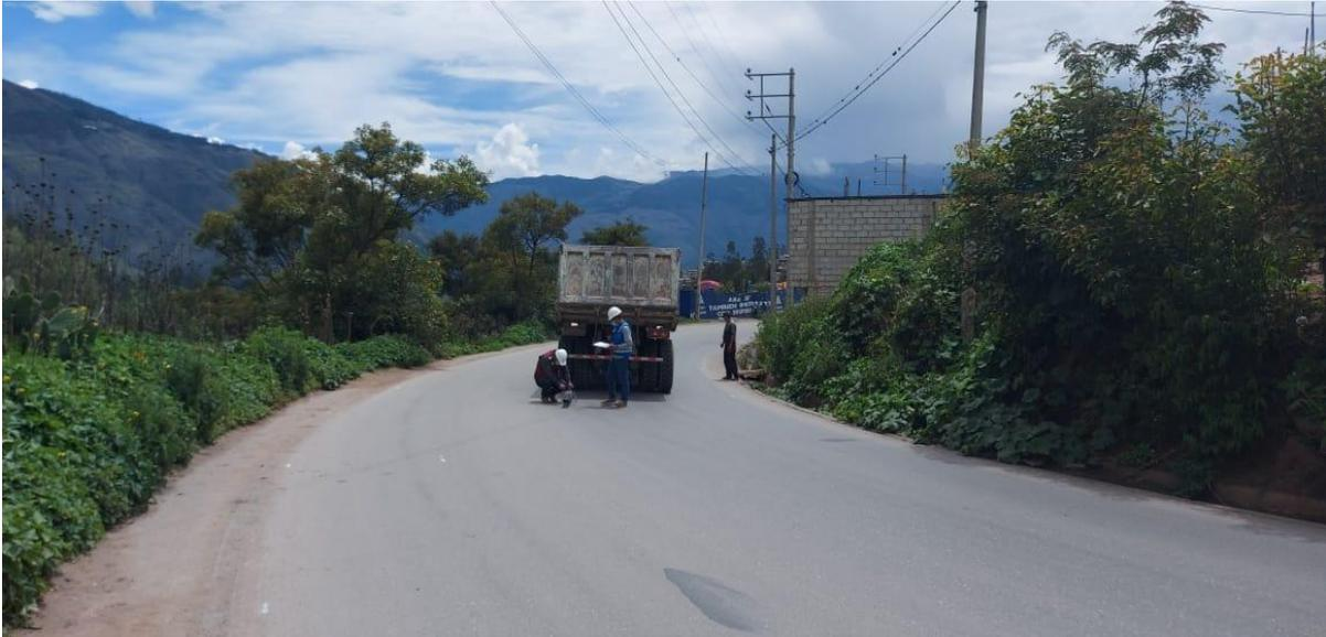
Figura N°03: Medición con viga Benkelman en eje de la zona de curva N°01.
