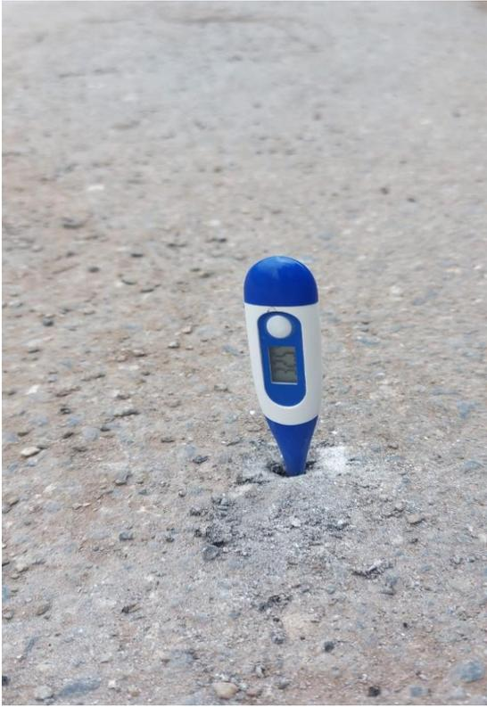
Figura N°11: Toma de la temperatura del pavimento con un termómetro digital
