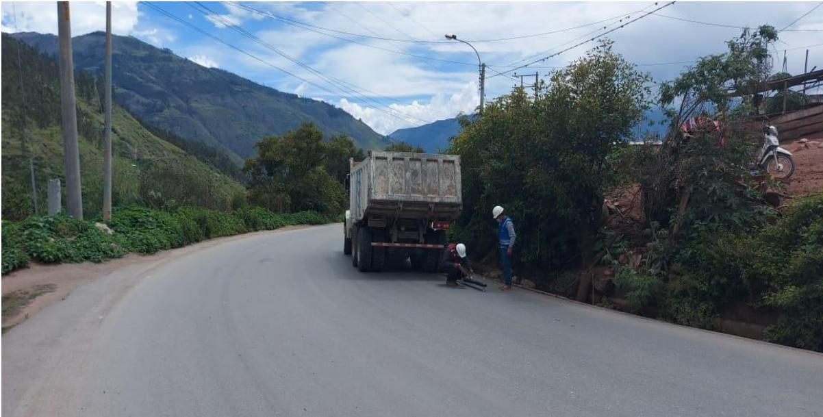
Figura N°04: lectura de diales de la deformación vertical en el carril derecho en zona de curva N°01
