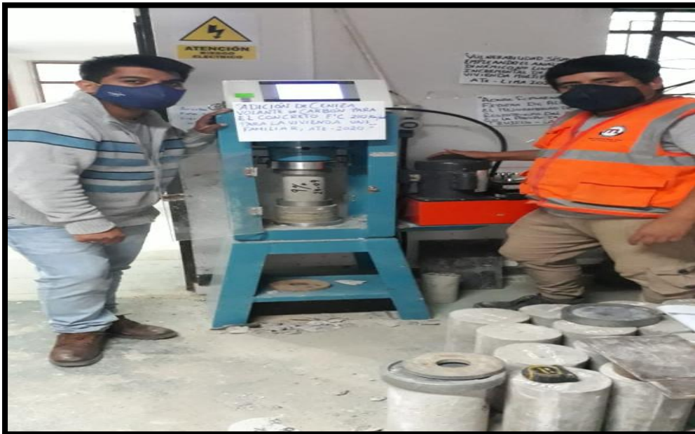
Figura 15. Ensayo a la resistencia a la compresión de Probetas Cilíndricas 4"x8"
