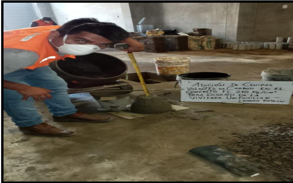
Figura 12. Medición de Slump
