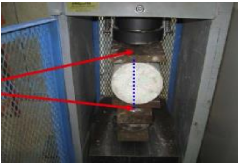
Figura 7. Máquina de ensayo para la determinación de la resistencia a la tracción simple del hormigón, por compresión diametral de una probeta cilíndrica.
