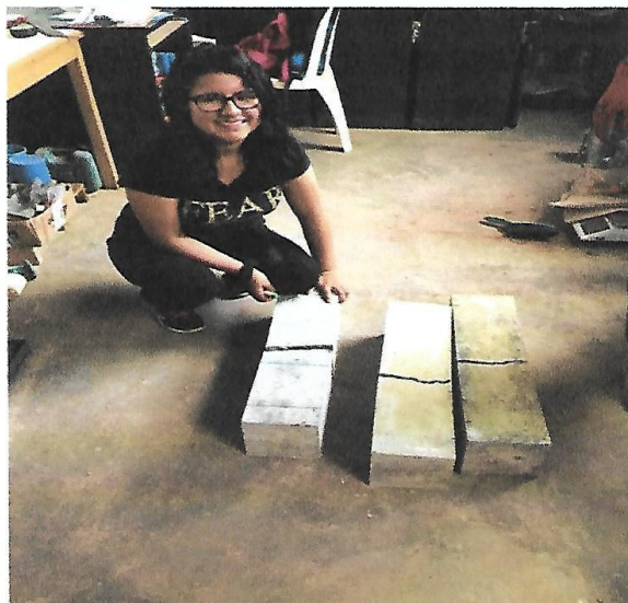
FIGURA 04 : Rotura de vigas a flexión
