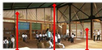
Se emplean materiales madera en los muros, pisos y cobertura. Así mismo se realizan aberturas en los muros para que pueda existir una adecuada ventilación e iluminación, la cual permita que los jóvenes se sientan cómodos en los módulos.
