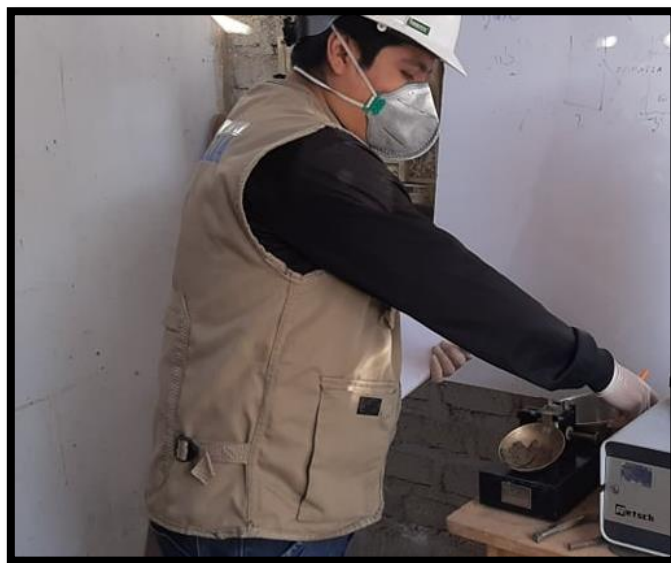
Figura 08: Se realizó el ensayo de limite liquido
