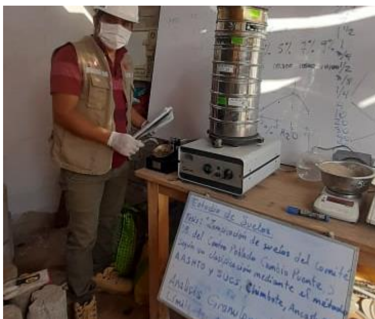
Figura 09: Se determinó que no presenta limite liquido
