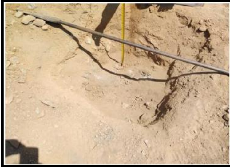
Figura 03: Medición de altura de excavación de calicata
