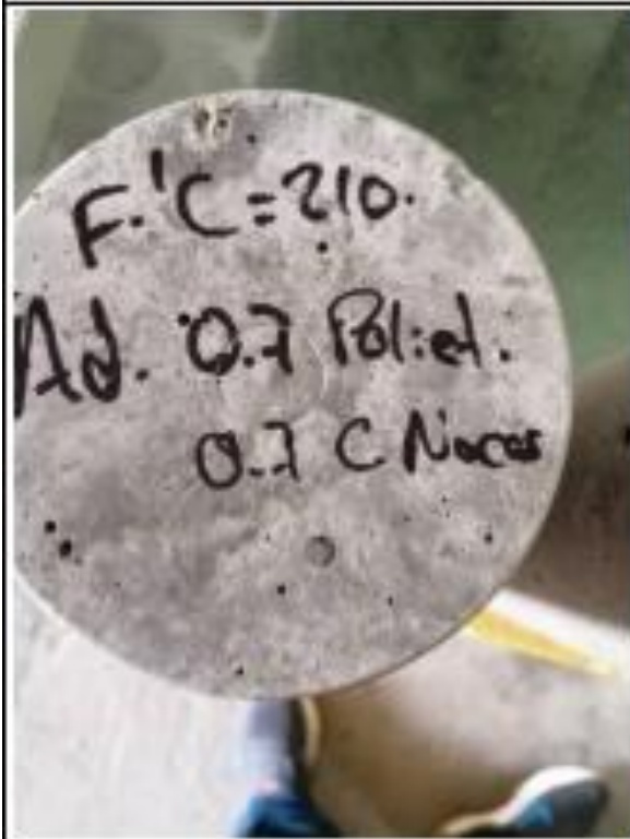
Curado adecuado de probetas o testigos para una posterior fractura dependiendo de cada ensayo
