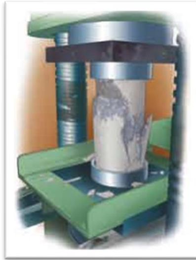
Figura 7: rotura por comprensión
