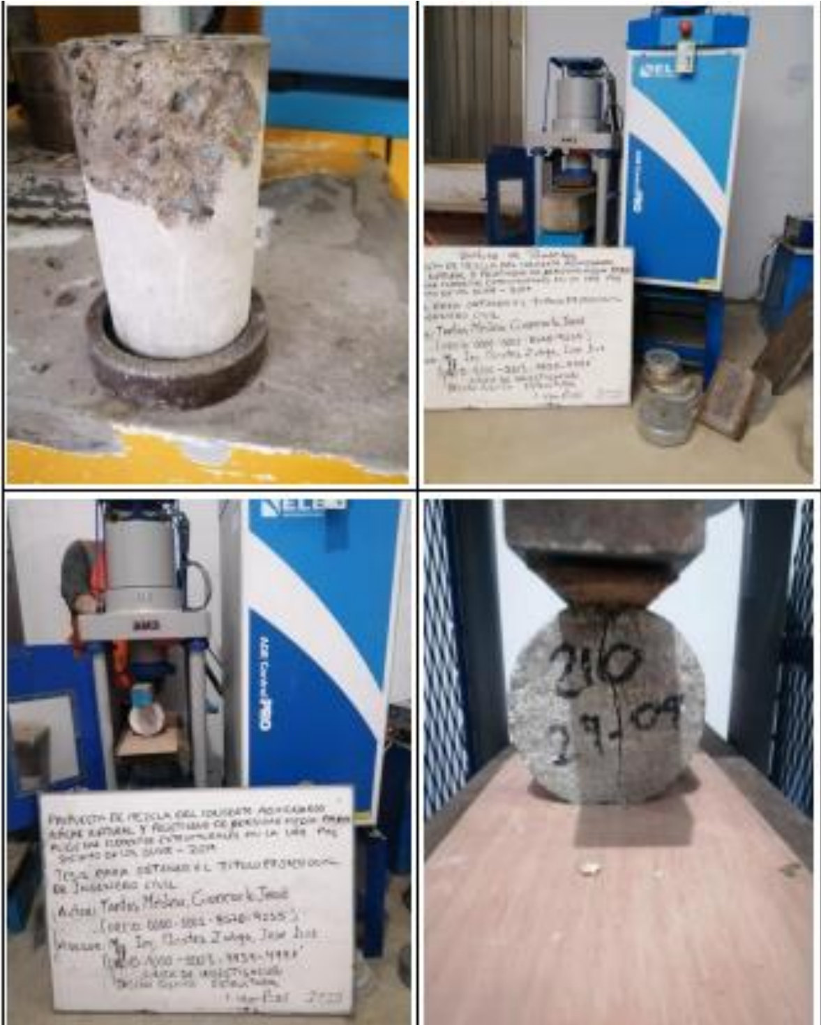
Fracturas por tipo de ensayo (traccion, compresion y flexion)
