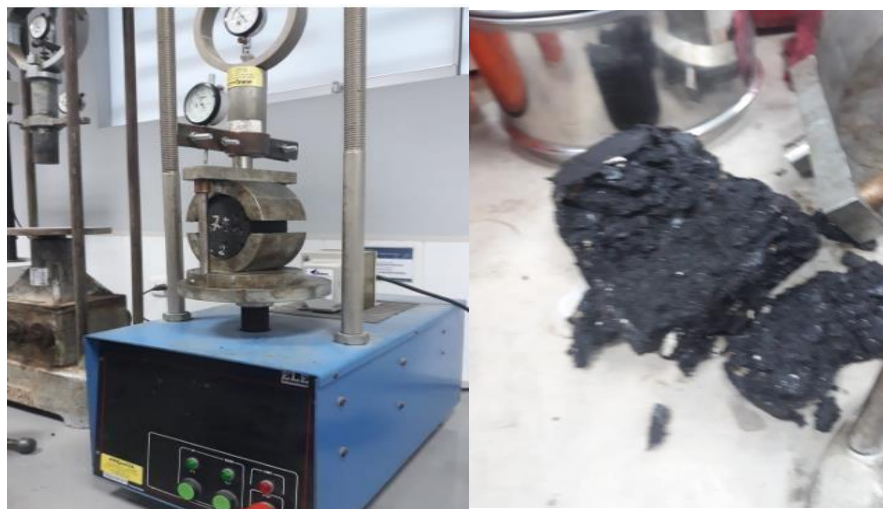
FOTO 14: ensayo Marshall a las briquetas de la mezcla
