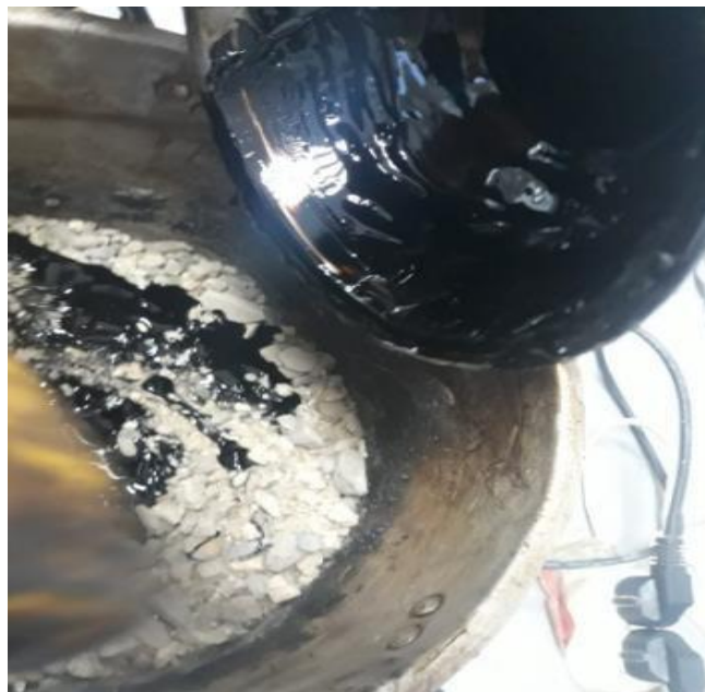
FOTO 7: preparación de mezcla asfáltica convencional.
