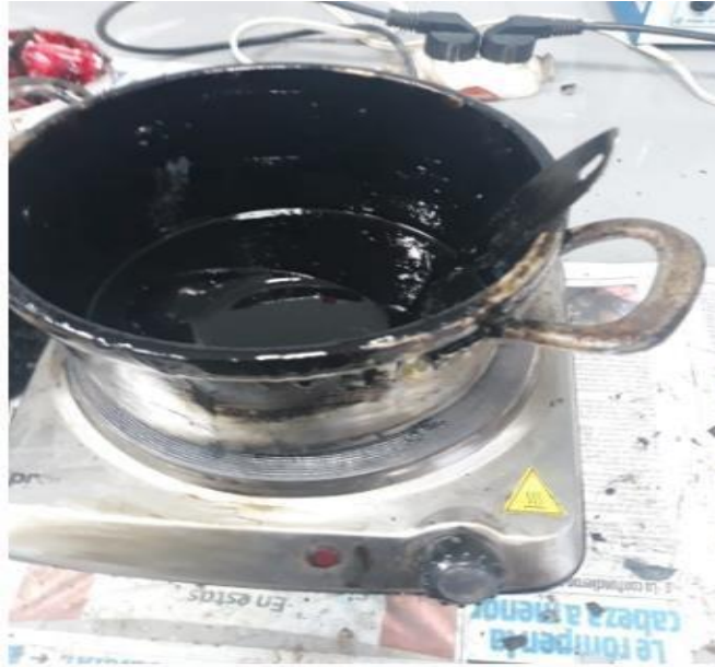
FOTO 6: calentando el cemento asfáltico.
