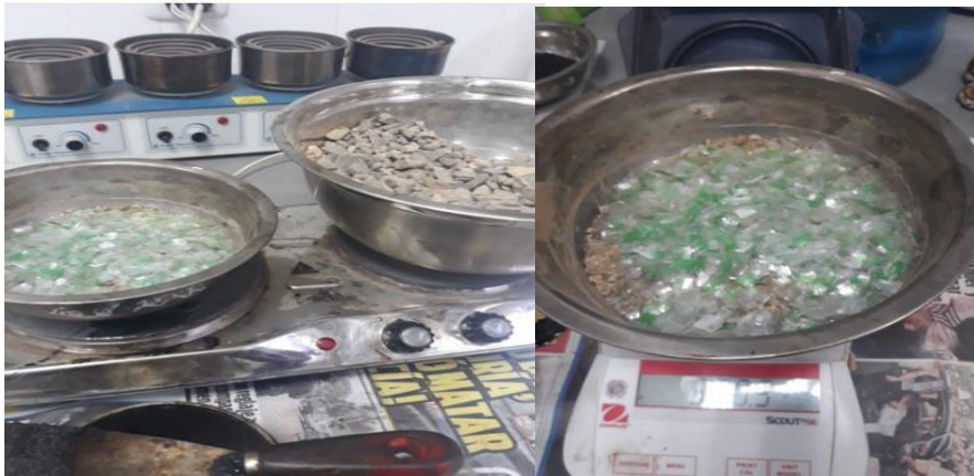
FOTO 11: materiales para la preparación de la mezcla asfáltica modificada.
