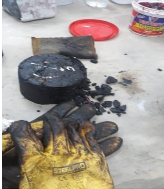
FOTO 10: realizado la ruptura de la briqueta de mezcla asfáltica convencional.
