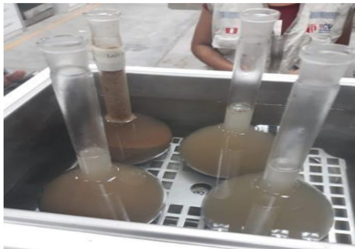
FOTO 5: Ensayo de gravedad específica.
