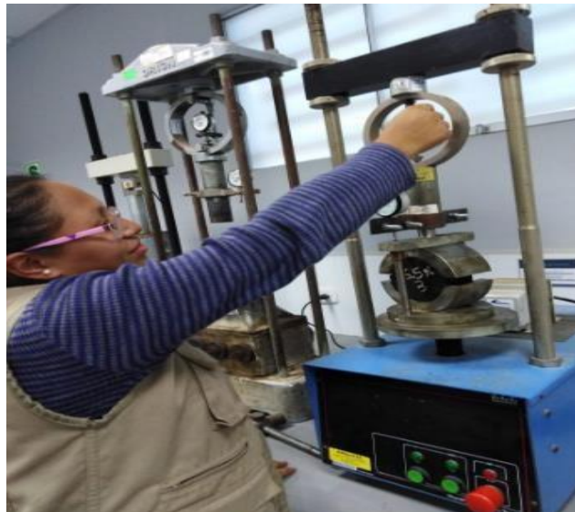
FOTO 9: ensayo de método Marshall para la briqueta de mezcla asfáltica convencional.
