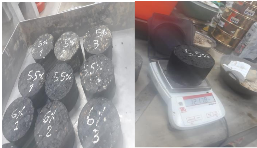
FOTO 13: briquetas de la mezcla asfáltica modificada.
