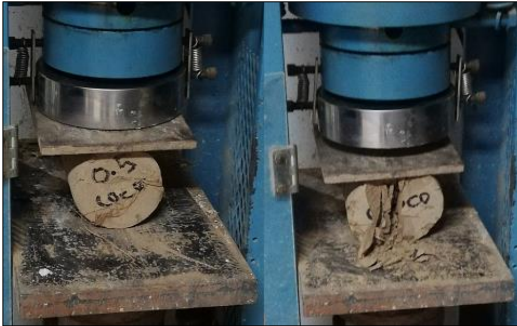
Figura 27. Ensayo de resistencia a tracción.
