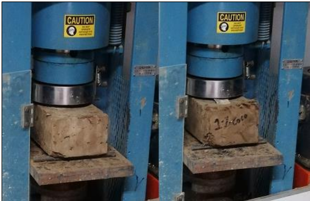
Figura 29. Ensayo de resistencia a flexión.
