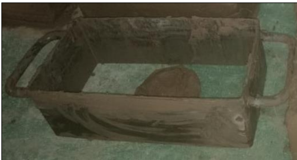
Figura 23. Molde de 30 x 15 x 10 cm, para la elaboración de las unidades de adobe.
