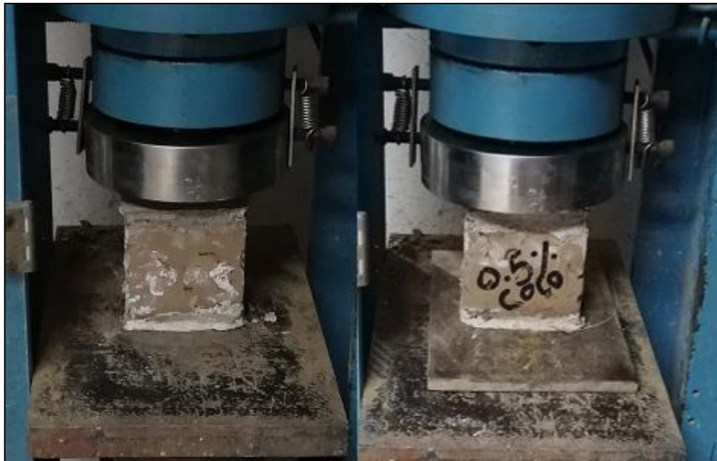
Figura 25. Ensayo de resistencia a compresión.
