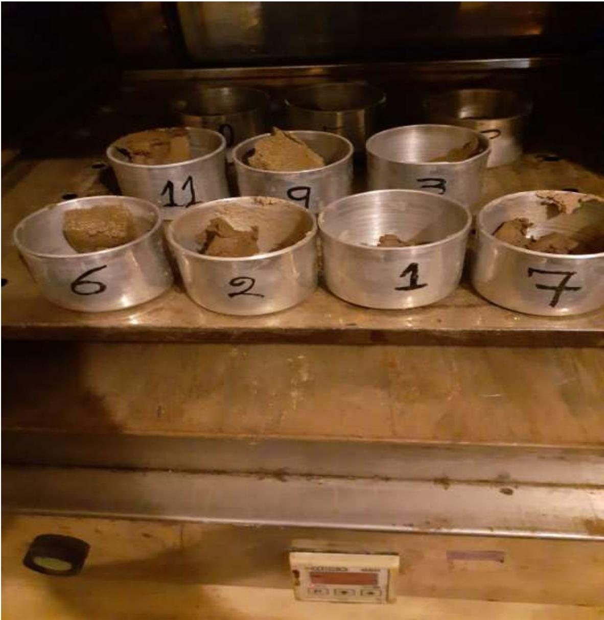
**Muestra de los LL y LP:** El límite líquido se define como el contenido de humedad expresado en por ciento con respecto al peso seco de la muestra, con el cual el suelo cambia del estado líquido al plástico, El límite plástico se define como el contenido de humedad, expresado en por ciento con respecto al peso seco de la muestra secada al horno, para el cual los suelos cohesivos pasan de un estado semisólido a un estado plástico.
