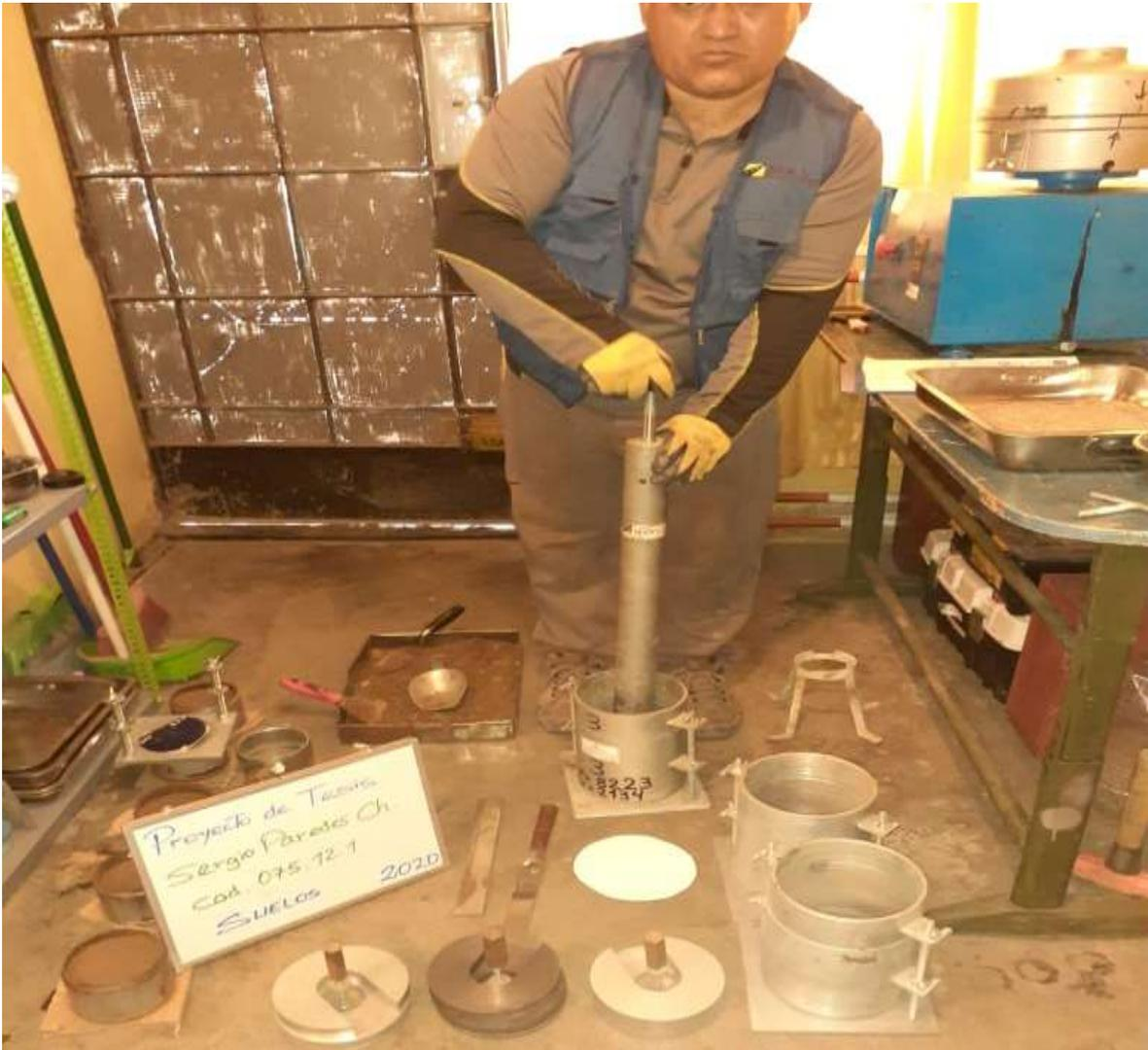
**Compactación del CBR:** La finalidad de este ensayo, es determinar la capacidad de soporte (CBR) de suelos y agregados compactados en laboratorio, con una humedad óptima y niveles de compactación variables. El ensayo se realiza normalmente sobre suelo preparado en el laboratorio en condiciones determinadas de humedad y densidad; pero también puede operarse en forma análoga sobre muestras inalteradas tomadas del terreno, también indica:
