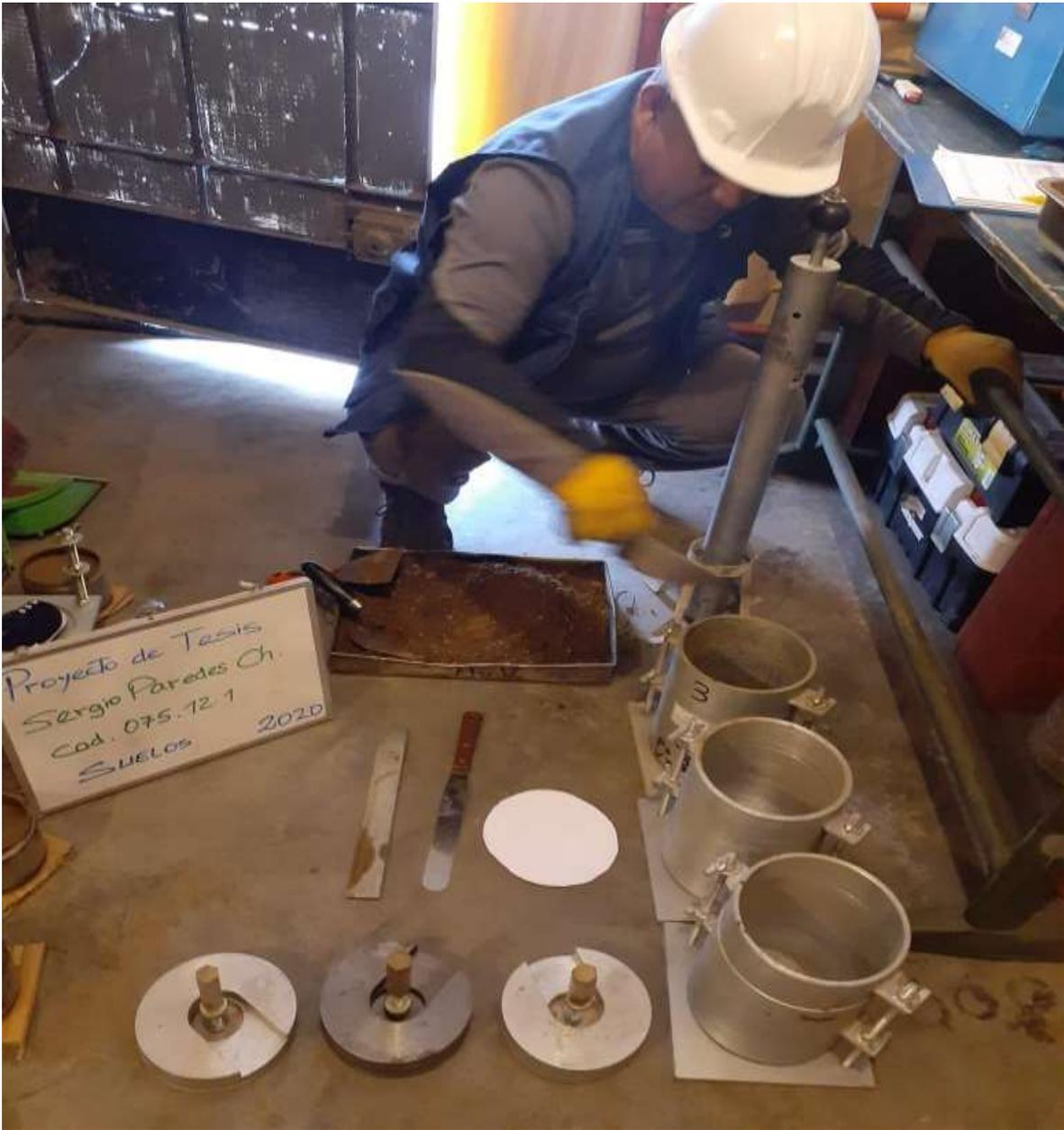
**Ensayo de CBR:** El CBR es un ensayo para evaluar la calidad de un material de suelo con base en su resistencia, medida a través de un ensayo de placa a escala.
