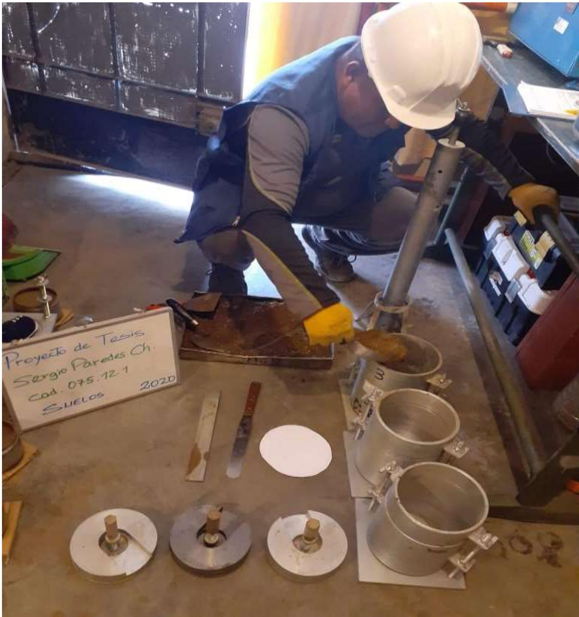
**Ensayo de CBR:** Según la norma ASTM (1883) "El CBR es un ensayo para evaluar la calidad de un material de suelo con base en su resistencia, medida a través de un ensayo de placa a escala. CBR significa en español relación de soporte California, por las siglas en inglés de California Bearing Ratio: aunque fue desarrollado en 1925, el ensayo comienza a aparecer en los estándares norteamericanos ASTM (por American Standards for Testing and Materials) desde 1964, en su versión para laboratorio".
