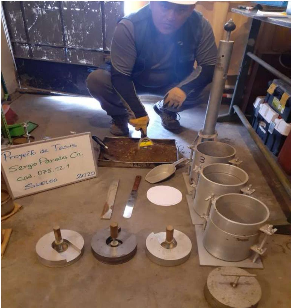
**Ensayo de CBR:** El Ensayo CBR (California Bearing Ratio: Ensayo de Relación de Soporte de California) mide la resistencia al esfuerzo cortante de un suelo y para poder evaluar la calidad del terreno para subrasante, sub base y base de pavimentos.
