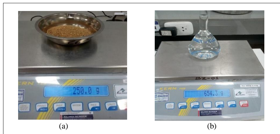
Figura 21. Ensayo de Peso específico y absorción del Agregado fino.
