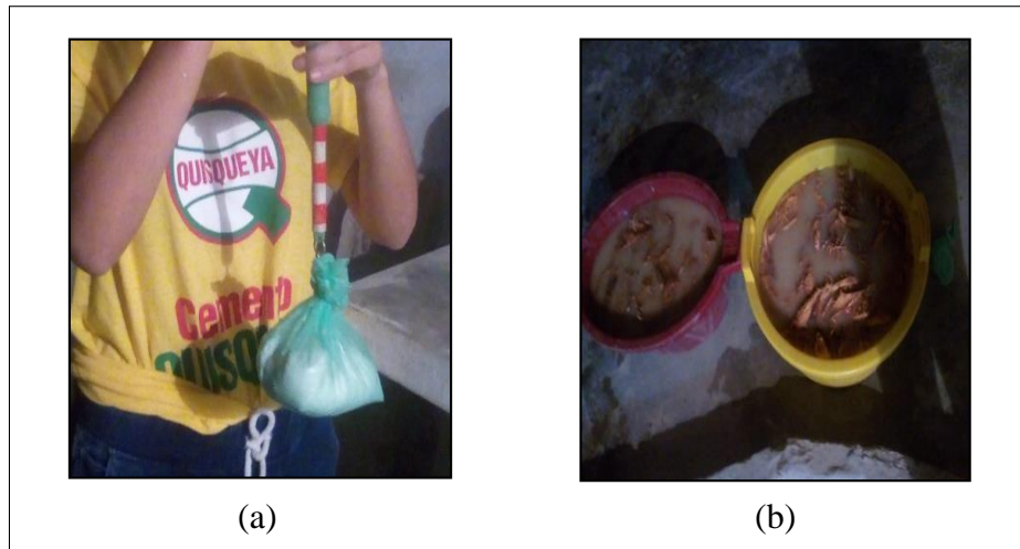
Figura 8. Curado de fibra de estopa de coco.
