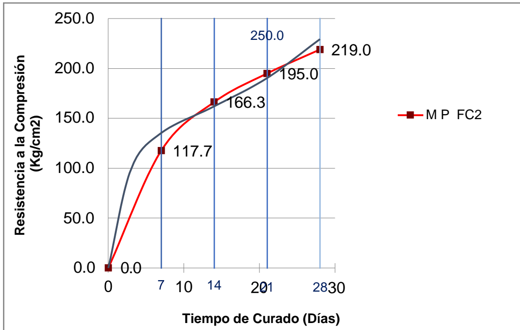
Gráfico 9. Curva de resultados de ensayos a compresión de mezcla con 2% de adición de fibra de estopa coco vs resistencia f'c diseño.
