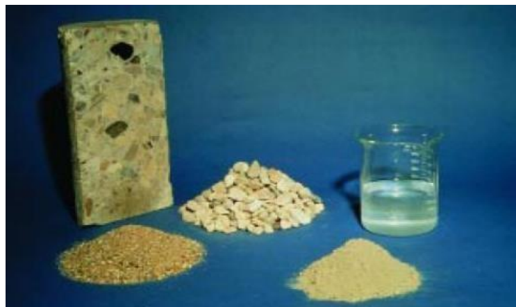
Figura 2. Elementos que conforman el concreto: cemento, agregados (grueso y fino) y agua.
