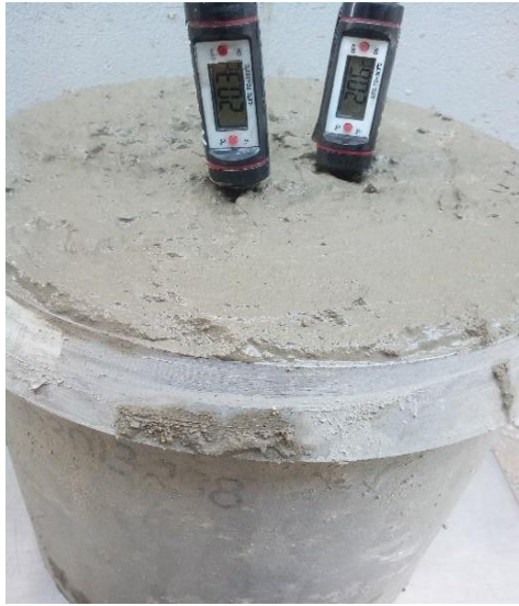
Figura 29. Temperatura del concreto para vigas.
