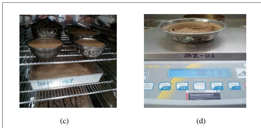
Figura 22. Ensayo de Peso específico y absorción del Agregado fino.
