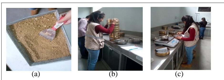
Figura 12. Ensayo Granulométrico del Agregado Fino.
