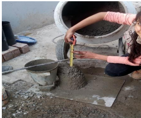
Figura 24. Asentamiento de mezcla patrón para probetas.
