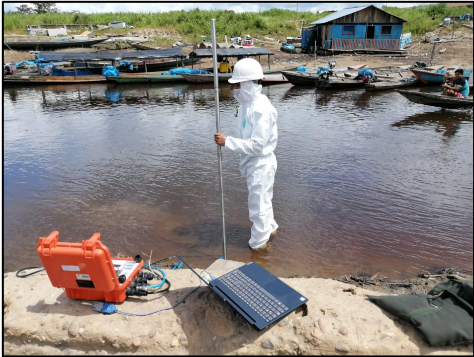
Foto 9: Medición de parámetros hidráulicos del cauce de la quebrada
