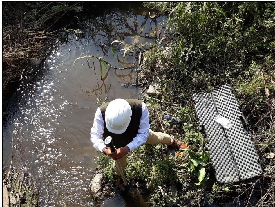
Foto 6: Aforo de la sección transversal de la quebrada Pacacochoa
