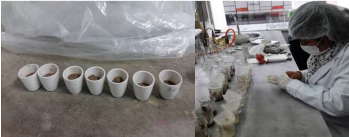
Figura 6: Determinación pH, CE y potencial redox, M.O
