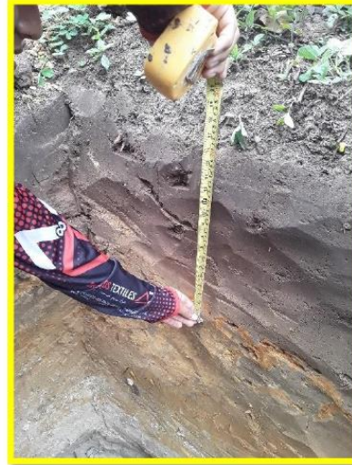
Foto 02: Realizando la estratificación de la Calicata N° 01
