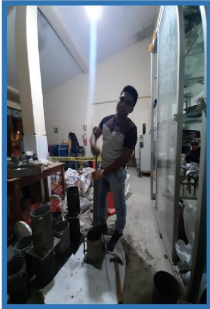
Foto 17: Realizando la compactación para el CBR
