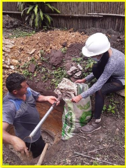
Foto 05: Toma de la muestra para realizar los ensayos de laboratorio, Calicata N° 01
