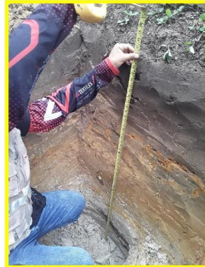
Foto 04: Toma de medida del estrato 3 de la Calicata N° 01
