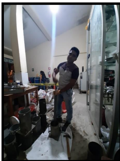
Figura 14. Compactación del suelo, elaboración propia, 2020.
