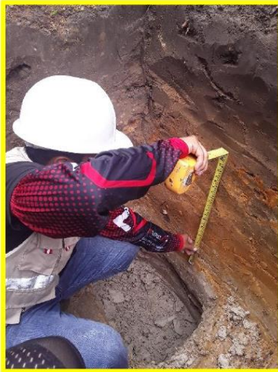
Foto 03: Toma de medida del estrato 2 de la Calicata N° 01
