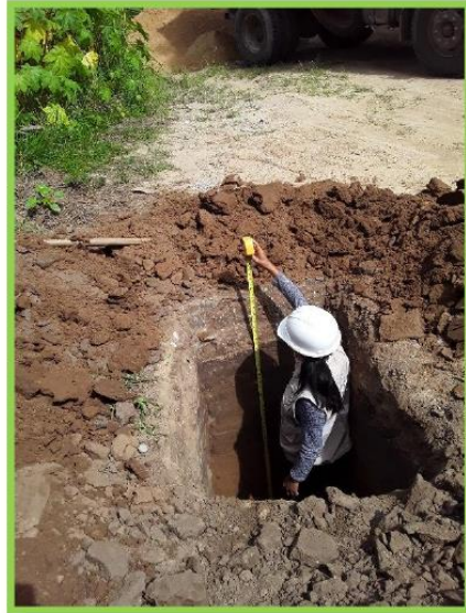
Foto 08: Toma de medidas de los estratos de la Calicata N° 02
