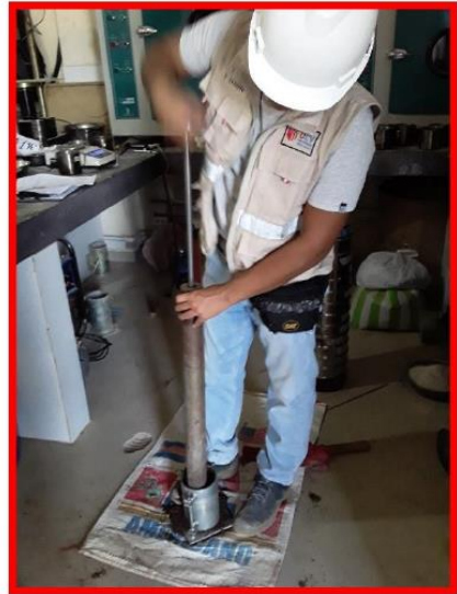
Foto 14: Realizando el ensayo de Proctor Modificado
