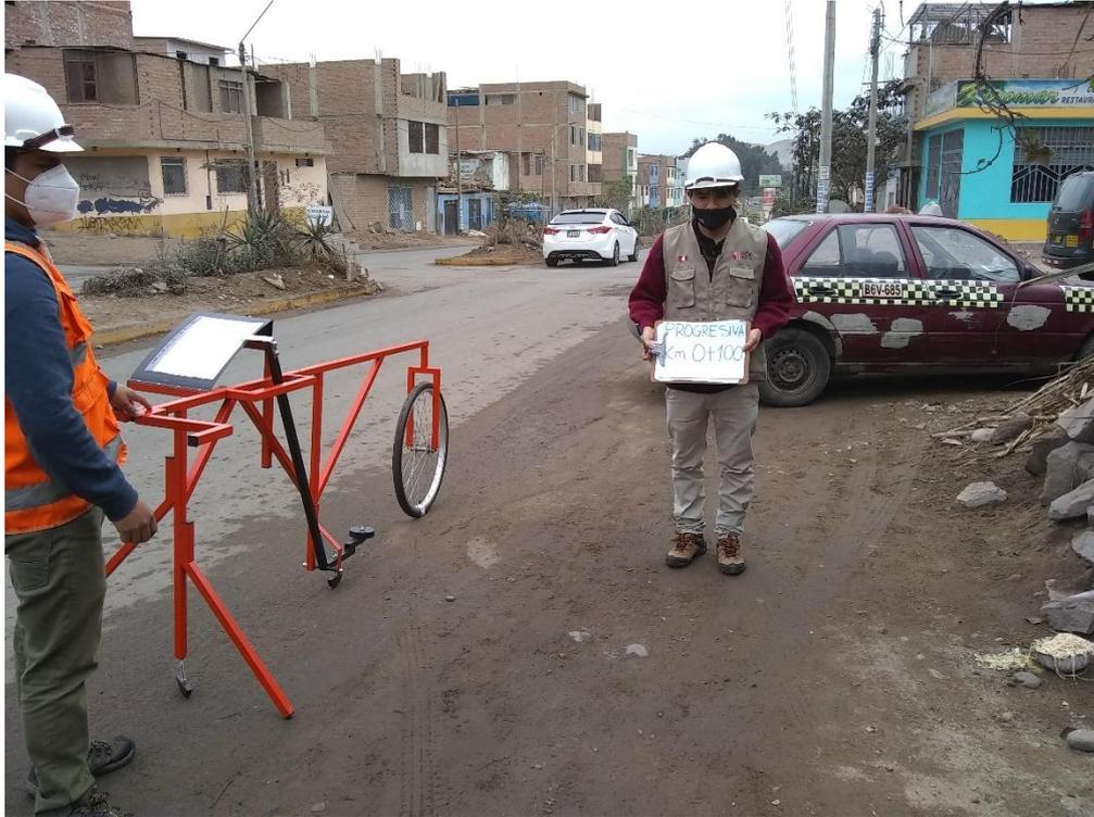
Toma de datos hasta la progresiva (Km 0+100), en el cual se encontró un rompe muelle, considerándose como elevación máxima.
