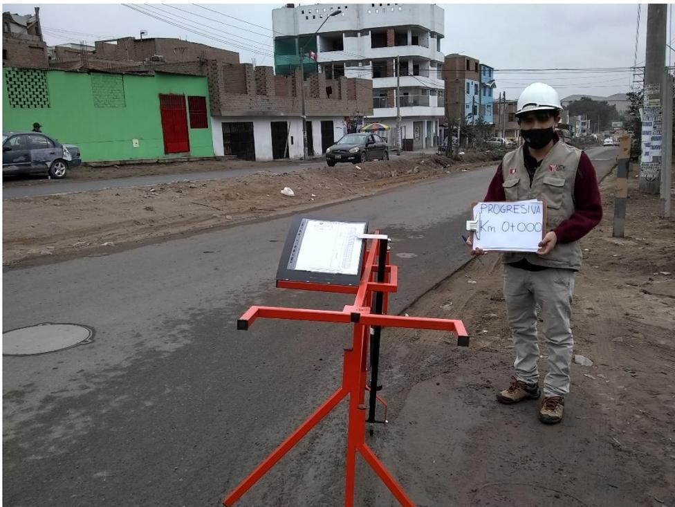
Progresiva inicial en el ensayo para la obtención del IRI
