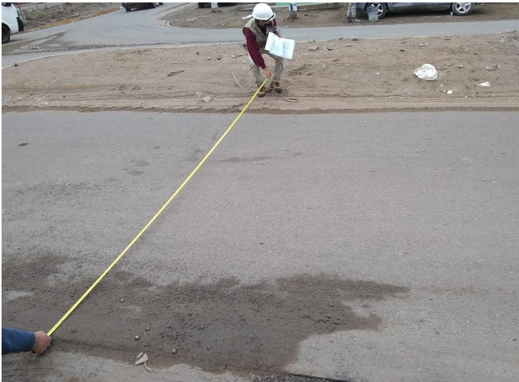
Medición la calzada en inicio de la vía de estudio para el ensayo **MDR**
