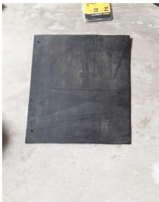
Imagen 2. Plancha de caucho reciclado. 1.5 cm de espesor.
