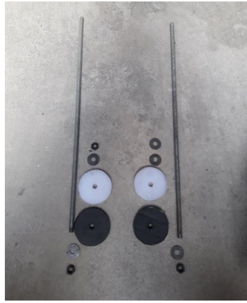
Imagen 4. discos de caucho y plástico para la válvula de golpe de ariete con 2.5 pulgadas de diámetro, estas funcionaran con un eje metal, cumpliendo el trabajo de una válvula check.
