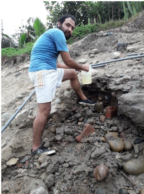
Imagen 5. Ensayo de campo, prueba de caudal de llegada a una altura de 5 m.
