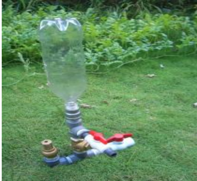
Figura 10: Bomba de ariete hidráulico con cámara de aire de botella de plástico.
