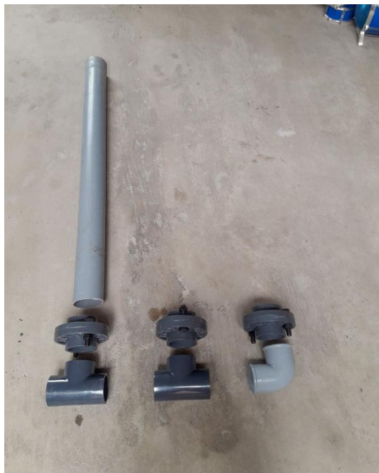
Imagen 1. bridas de PVC de 3" de diámetro, codo de 90° de 3" de diámetro, tubo PVC de 4". De 4" de diámetro.
