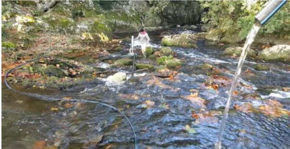
Figura 15: Tubería de descarga de polietileno de baja densidad, modelo a usarse en el presente proyecto de investigación.
