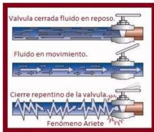
Figura 6: Fenómeno del golpe de ariete
