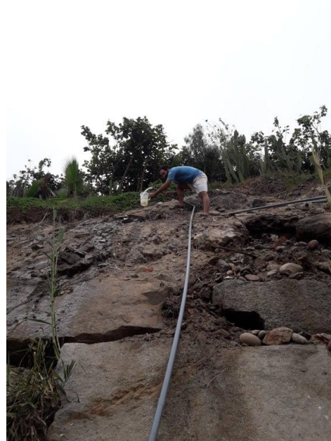
Imagen 6. Ensayo de campo, prueba de caudal de llegada a una altura de 6 m.
