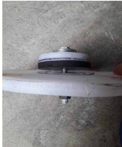
Imagen 6. Armado final de la válvula anti retorno.
