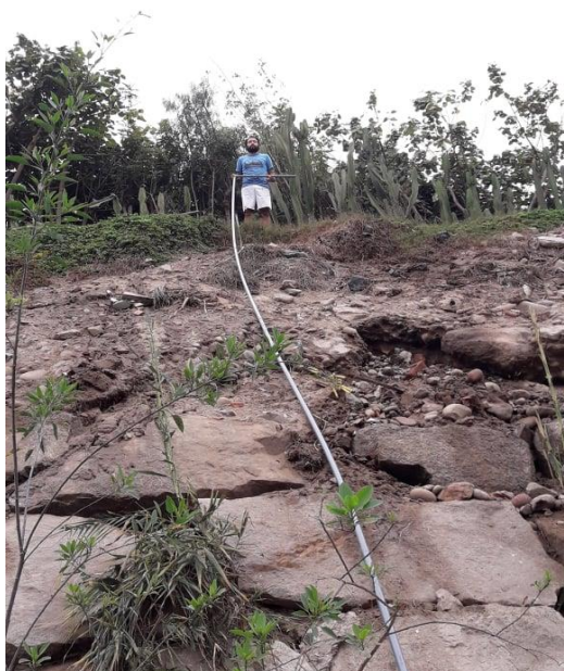
Imagen 9. Ensayo de campo, prueba de caudal de llegada a una altura de 9 m.
