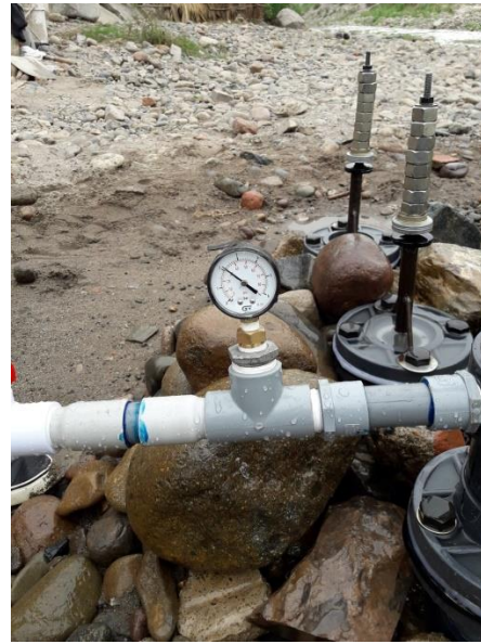
Imagen 4. Nanómetro de bourdoun marcando 30 PCI de presión.
