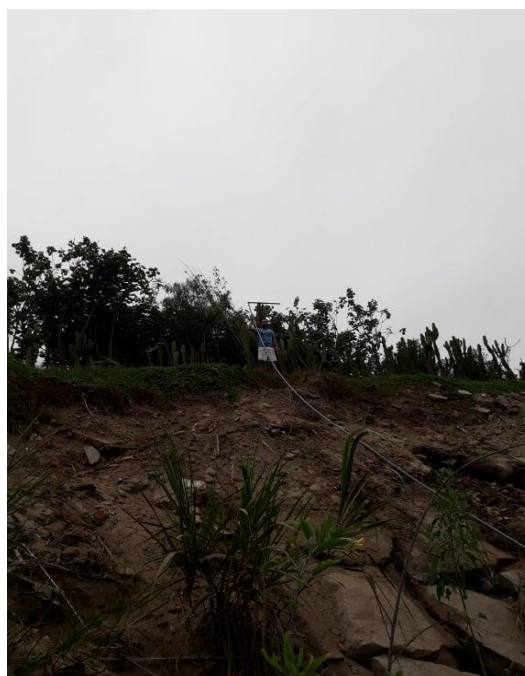
Imagen 10. Ensayo de campo, prueba de caudal de llegada a una altura de 10 m.
