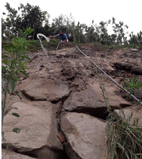
Imagen 7. Ensayo de campo, prueba de caudal de llegada a una altura de 7 m.
