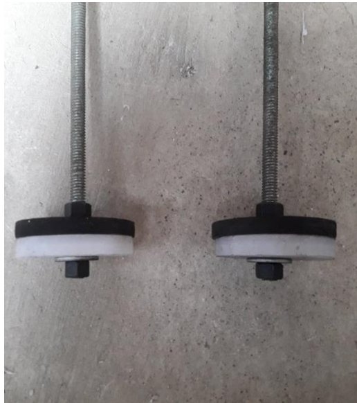
Imagen 5. Armado final del componente de la válvula check.
