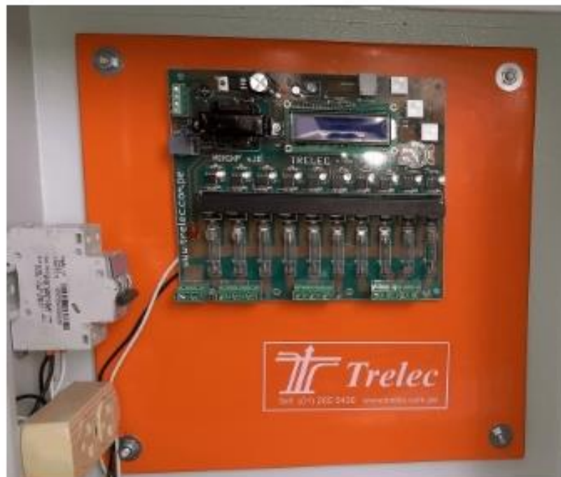
Figura 30: Controlador TRELEC - Modelo: MINIXP v10 – Parte I
