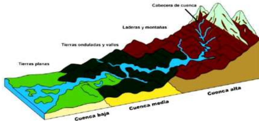
Figura 3 Esquema donde se muestran las partes de una cuenca hidrográfica.
