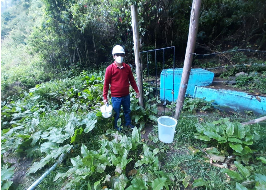
Aforo en la Captación existente.
