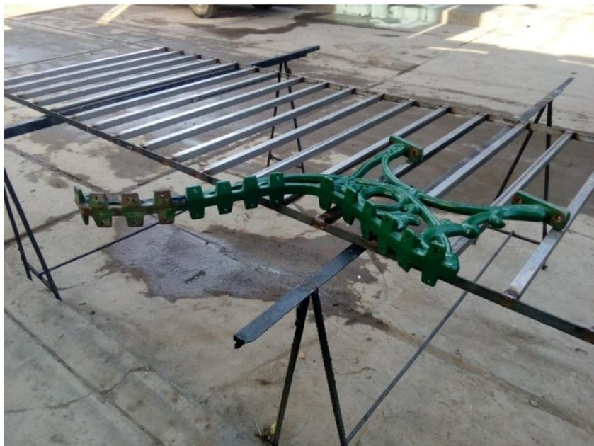
**Figura 4.** *Fabricación de un Cerco Metálico (Etapa Inicial)*
