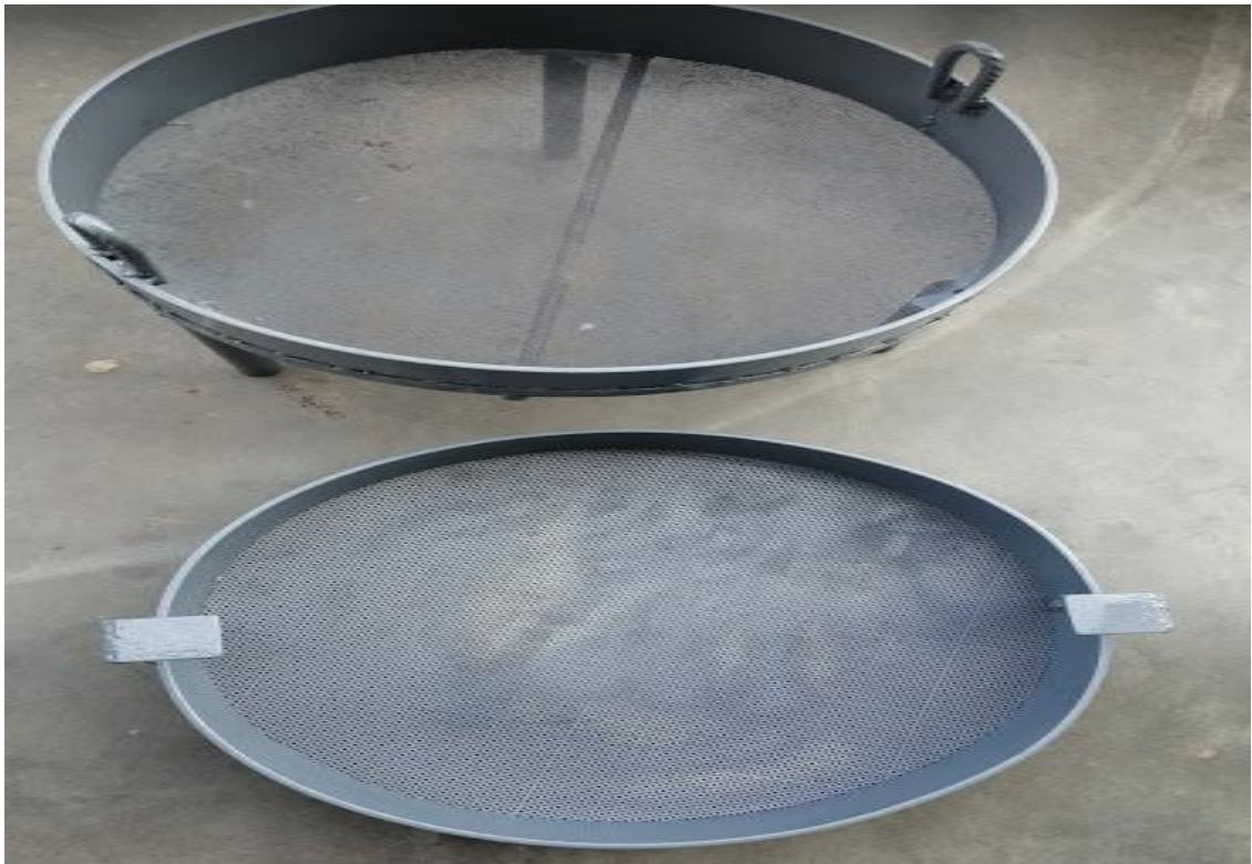
Foto N° 5: Tamices para concreto permeable y carbón activo
