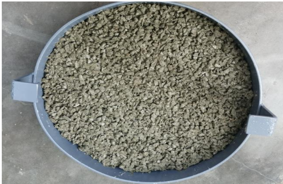
Foto N° 4: Filtro con tamices de concreto permeable
