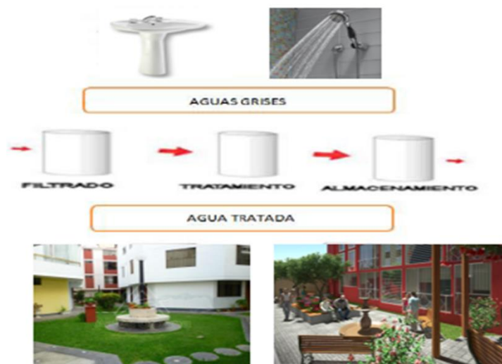
Figura N° 5. Proceso de tratamiento de agua gris, elaboración propia
