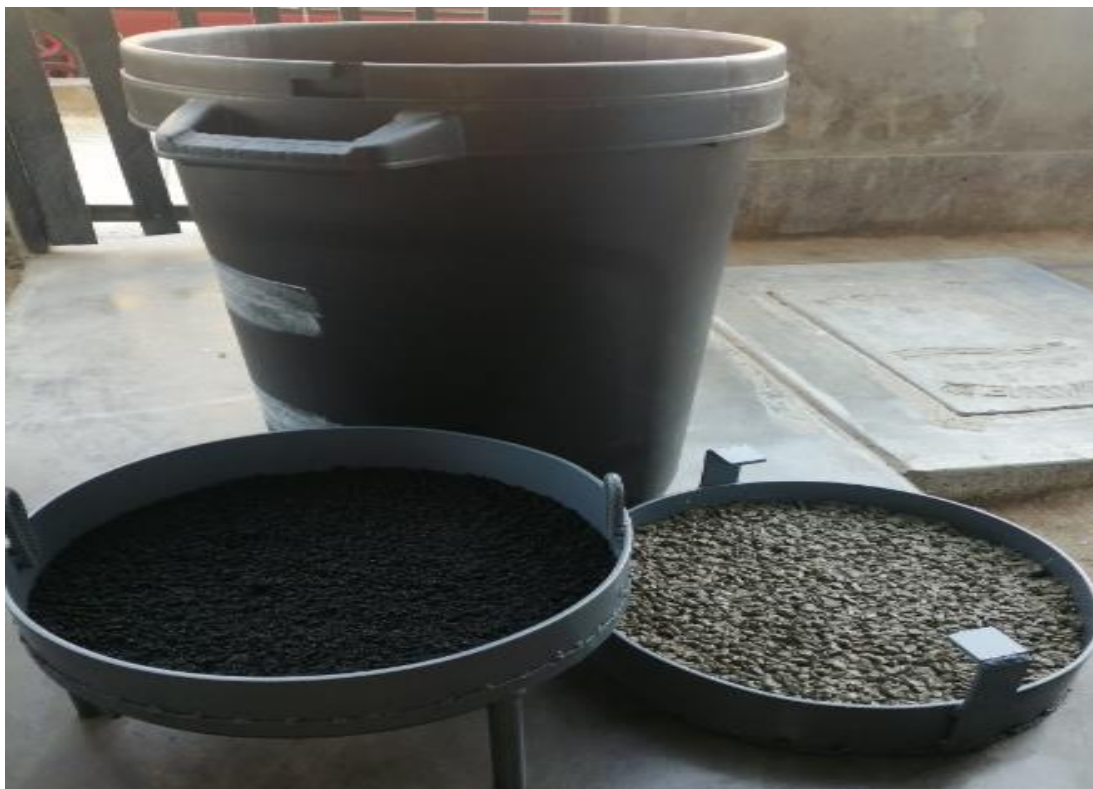
Foto N° 3: Tanque Filtro con tamices de concreto permeable y carbón activo
