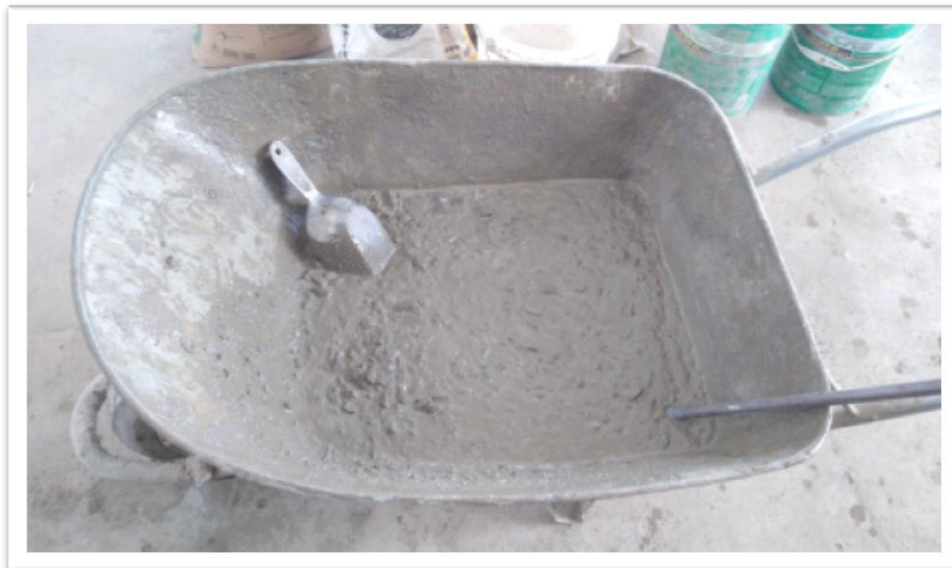
Figura N°06. Mezcla de la pasta para el diseño de mezcla patrón
