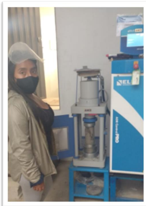
Figuras N° 18: Ensayo para medir la resistencia a la compresión en el diseño de mezcla reciclada a los 14 días
