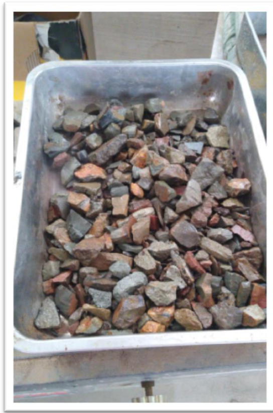
Figura N°05. Agregado grueso natural lavado
