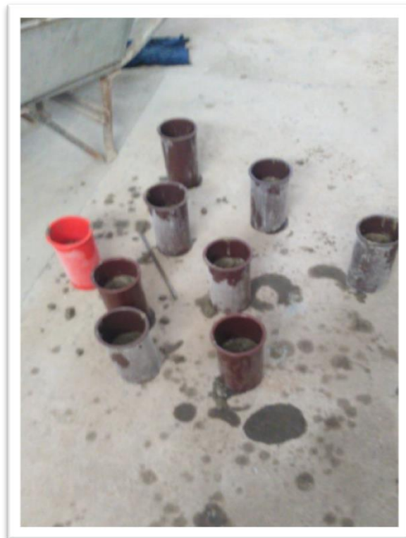
Figura N°08: Moldeando para el diseño de mezcla
