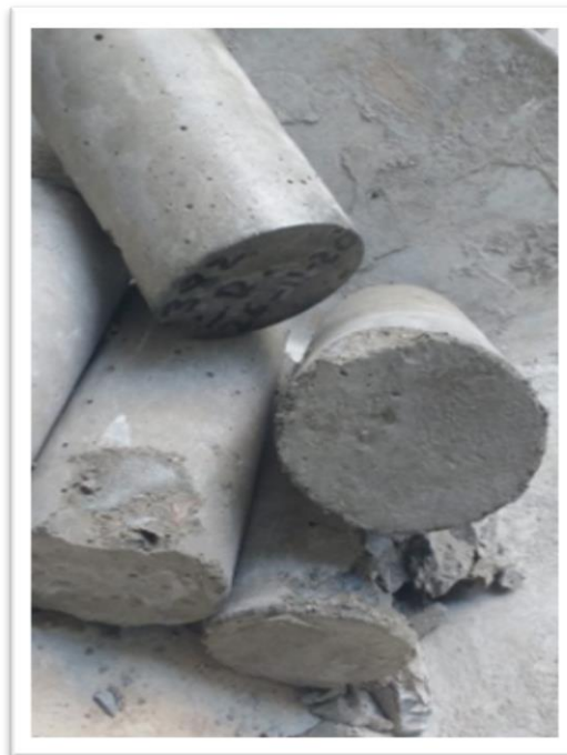
Figura N°16: Probetas reventadas a los 7 días.
