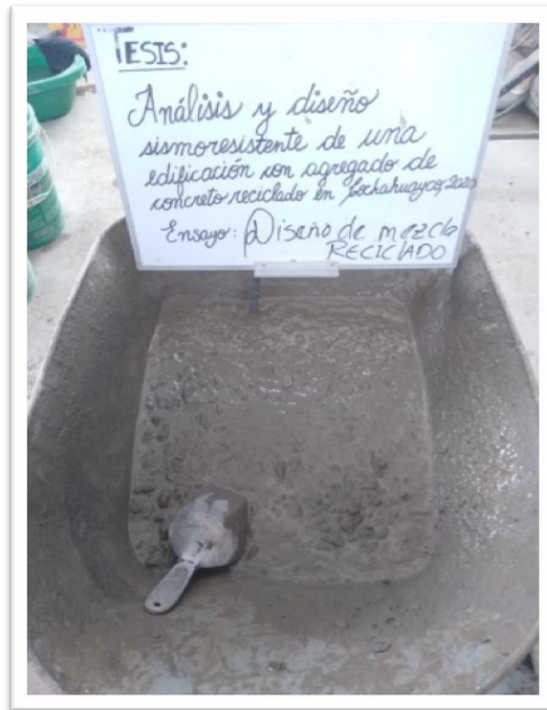
Figura N°07. Mezcla de la pasta para el diseño de mezcla patrón
