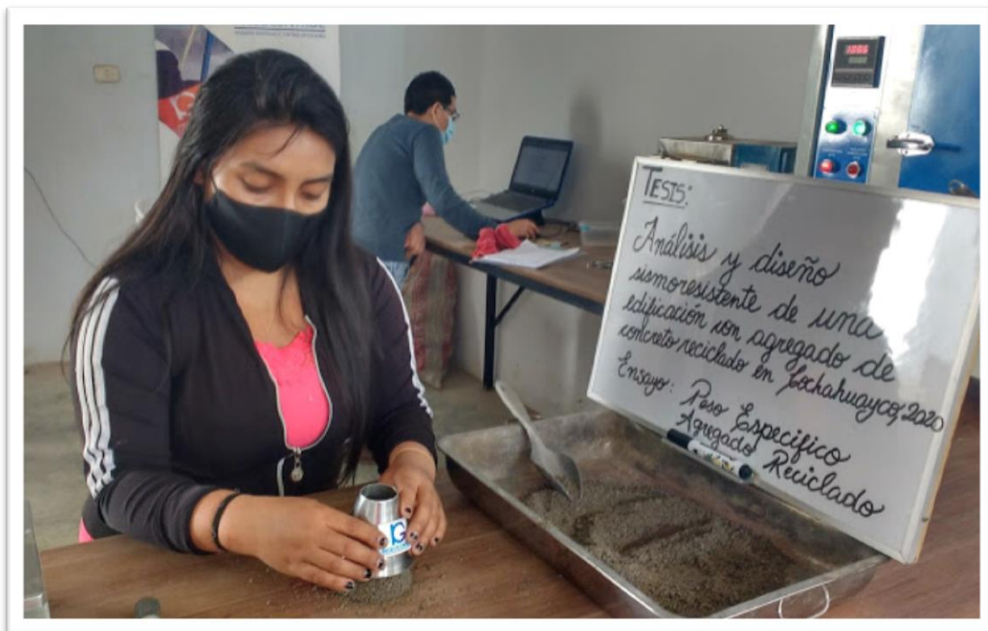
Figura N°11: Peso específico del agregado fino reciclado
