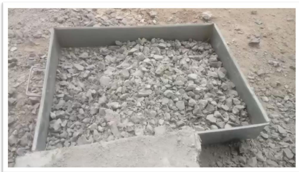
Figura N°04. Separación de materiales del agregado reciclado
