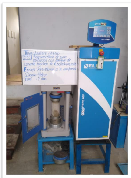
Figuras 12 y 13: Ensayo para medir la resistencia a la compresión en el diseño de mezcla patrón a los 7 días
