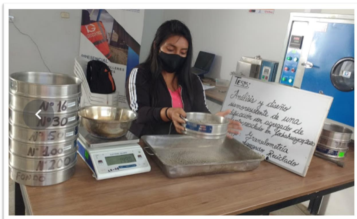
Figura N°10: Tamizaje de los agregado reciclado
