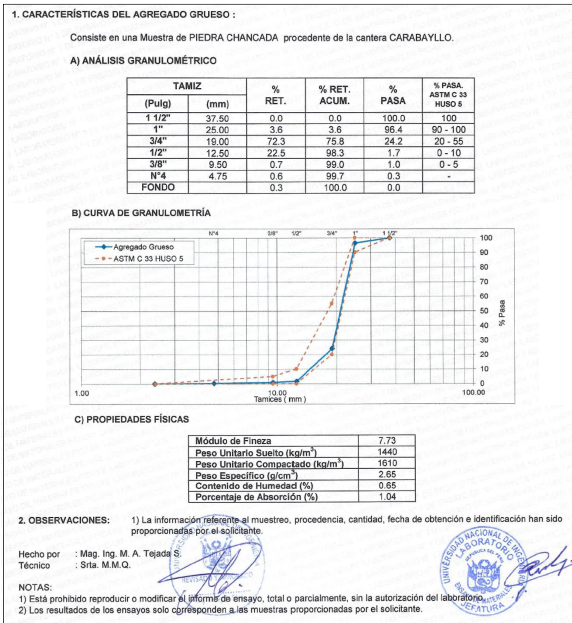
Figura 3. Resultados ensayos granulométricos, curva granulométrica y propiedades físicas del agregado grueso.
