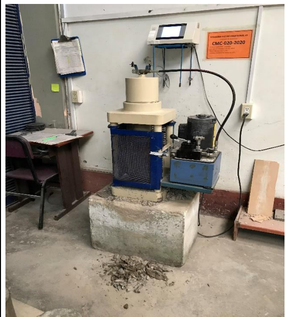
Prueba de resistencia a la compresión
