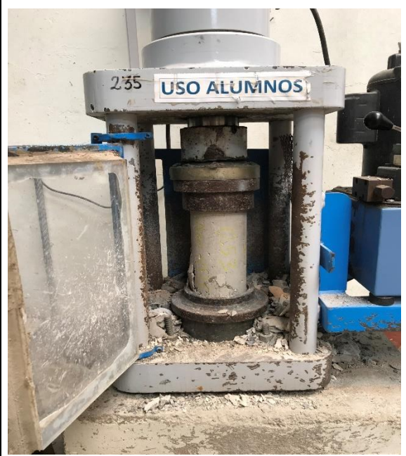
Prueba de resistencia a la compresión
