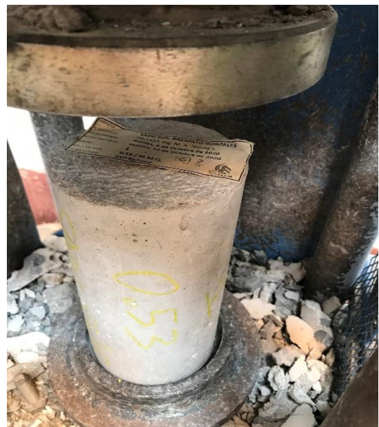
Prueba de resistencia a la compresión probeta para diseño de mezcla final
