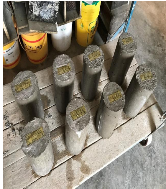
Probetas a los 7 días para prueba de resistencia a la compresión
