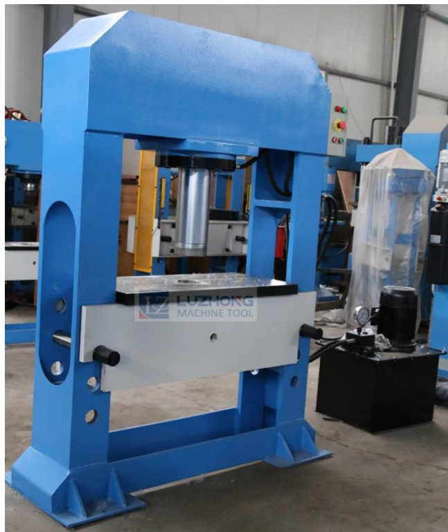
Figura 16: PLEGADORA HIDRÁULICA. Potencia: 7.5KW, 3 \phi /380v/60Hz. Cant: 1
