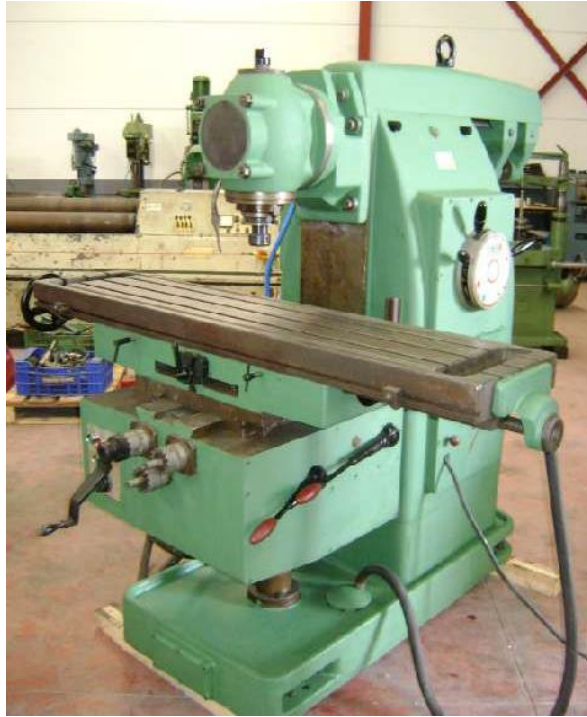
Figura 22: FRESADORA UNIVERSAL. Potencia: 3.73KW, 3 \phi /380v/60Hz. Cant: 1
