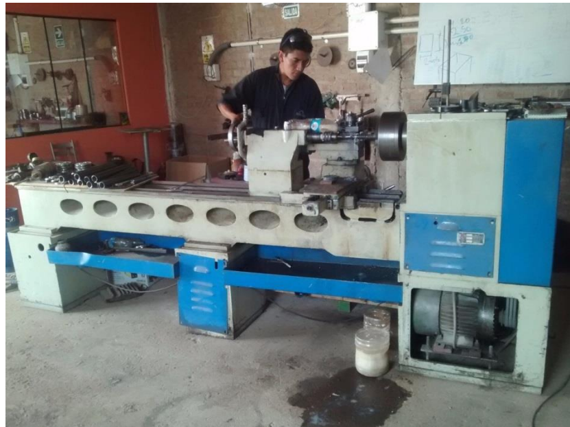
Figura 19: TORNO N°1. Potencia: 7.46KW, 3 \phi /380v/60Hz. Cant: 1
