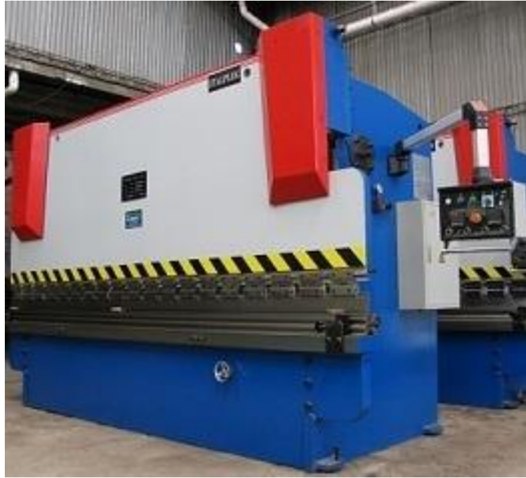
Figura 16: PLEGADORA HIDRÁULICA. Potencia: 7.5KW, 3 \phi /380v/60Hz. Cant: 1
