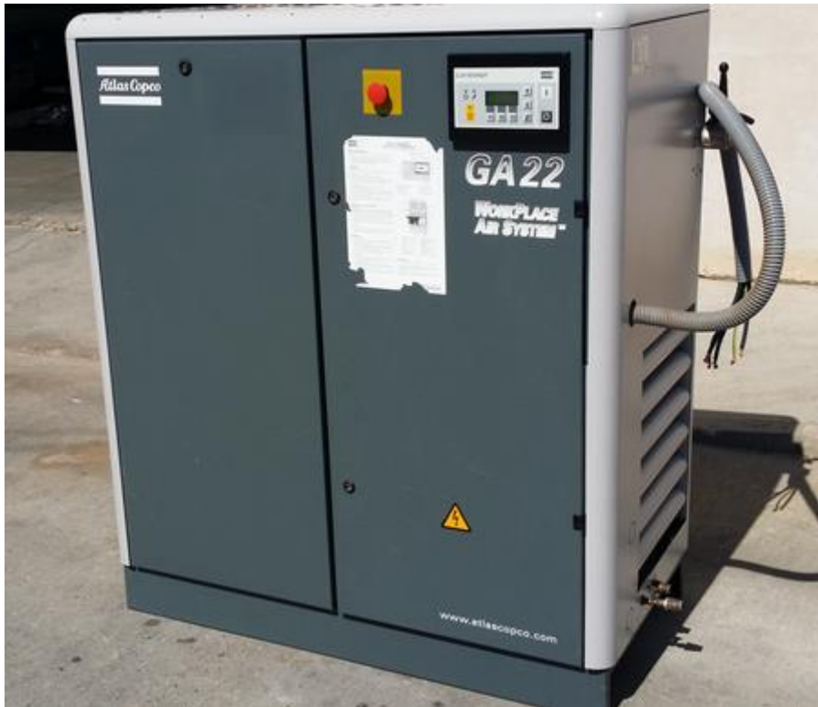
Figura 26: COMPRESOR DE TORNILLO. Potencia: 11.19KW, 3 \phi /380v/60Hz. Cant: 1
