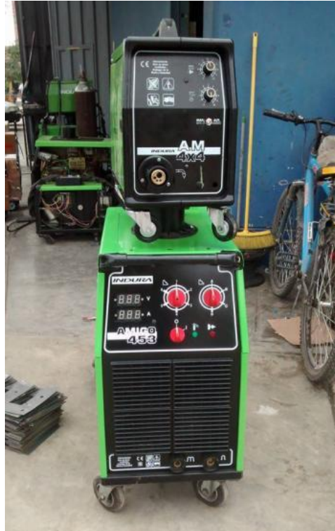
Figura 18: MÁQUINA DE SOLDAR MIG. Potencia: 5KVA, 3 \phi /380v/60Hz. Cant: 3
