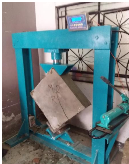
Figura 30. Ensayo compresión diagonal M2-R.
