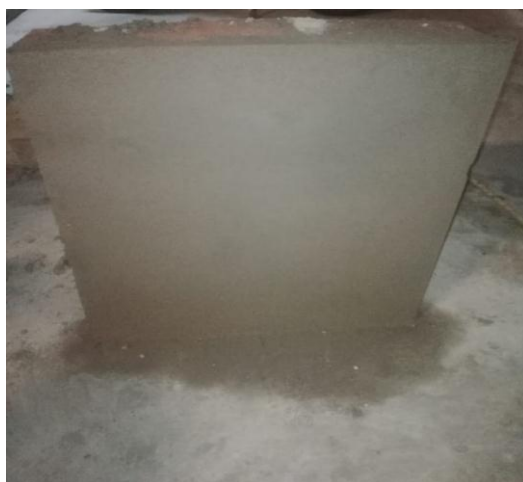
Figura 24. Murete de ladrillo King Kong Macizo tarrajeado.
