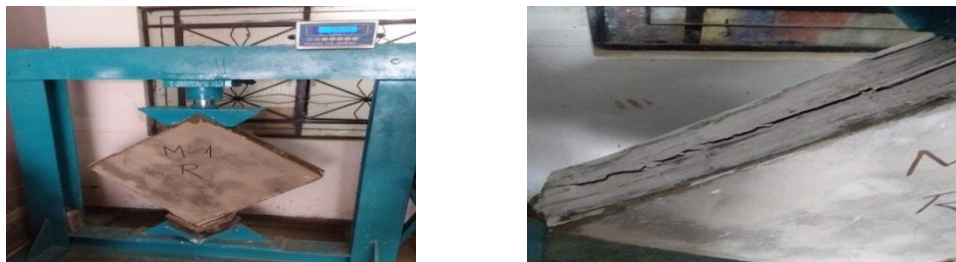
Figura 29. Ensayo compresión diagonal M1-R.
