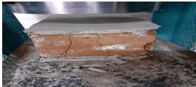
Figura 19. Ladrillo refrentado con yeso.
