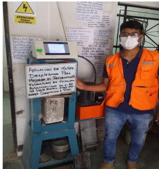
Figura 33. Ensayo de pila de Albañería.
