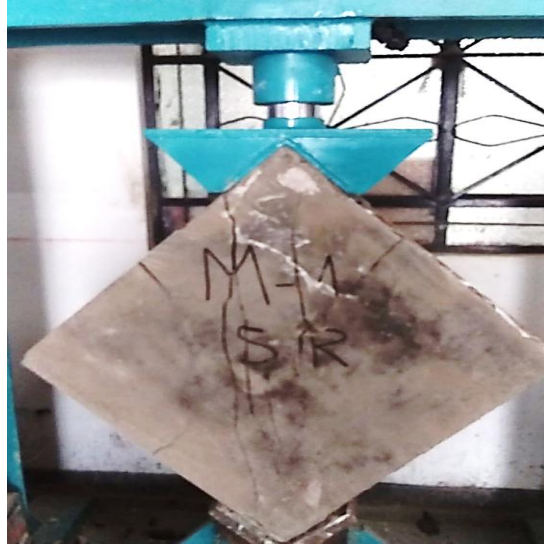
Figura 25: Falla por Tracción.
