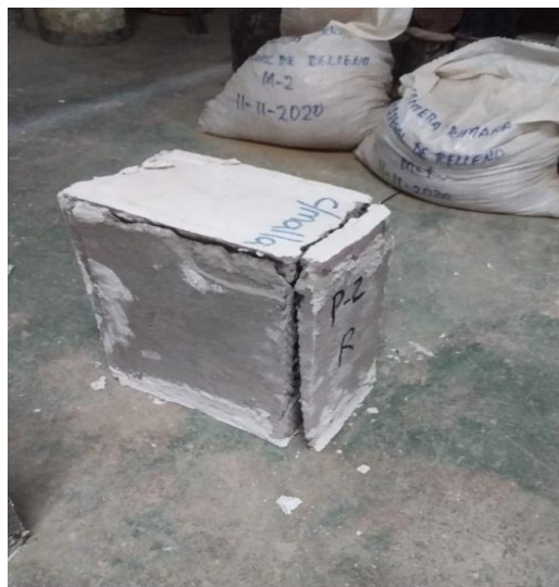
Figura 34. Falla de pila P2-R
