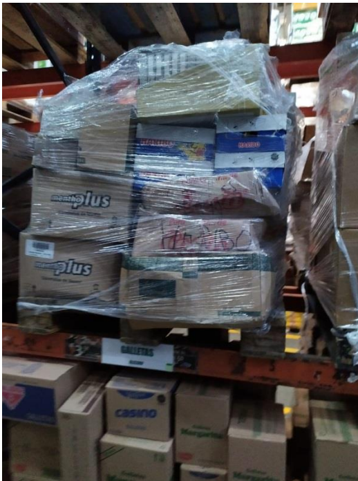
ANEXO 8 PALLET MAL APILADO OCACIONA QUE LA MERCADERIA SE DAÑE
