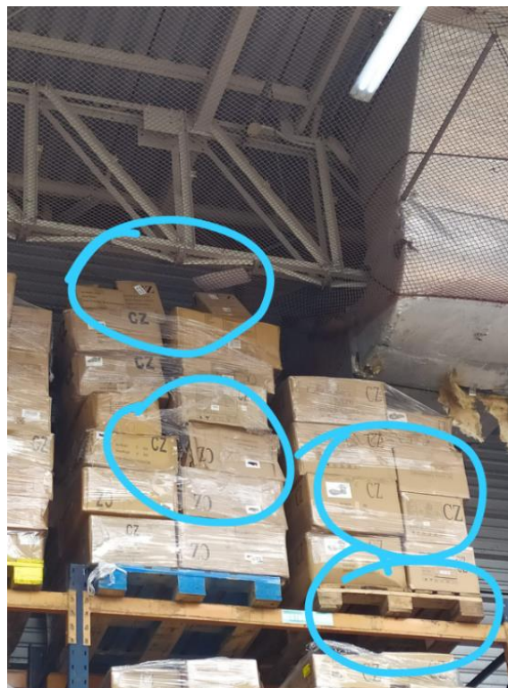
ANEXO 17 PALLETS MAL APILADOS, CAJAS SUELTAS Y MAL VITAFILEADO
