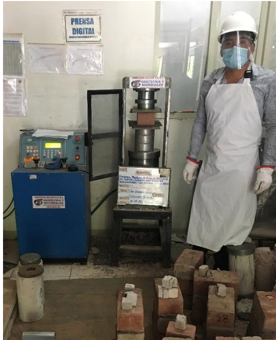
Figura 4.3: Ensayo compresión simple a ladrillos ecológicos
