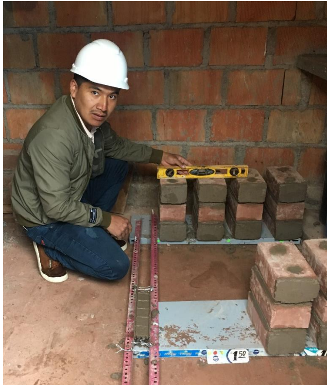
Figura 4.5: Elaboracion de 6 probetas con ladrillos ecologicos
