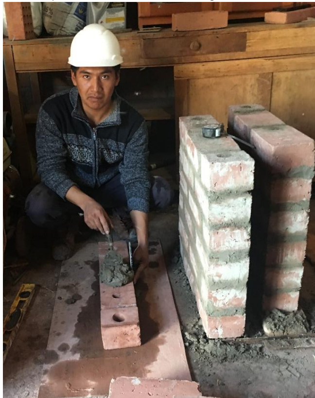
Figura 4.6: Elaboracion de 3 muretes y 3 pilas con ladrillos ecologicos
