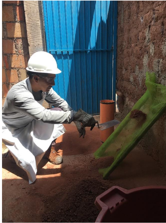
Figura 4.1 Ensayo de Tamizado del suelo arcilloso
