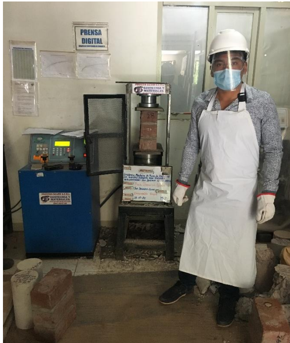
Figura 4.4: Ensayo a compresion axial de pilas de albañileria con Ladrillos ecologicos.
