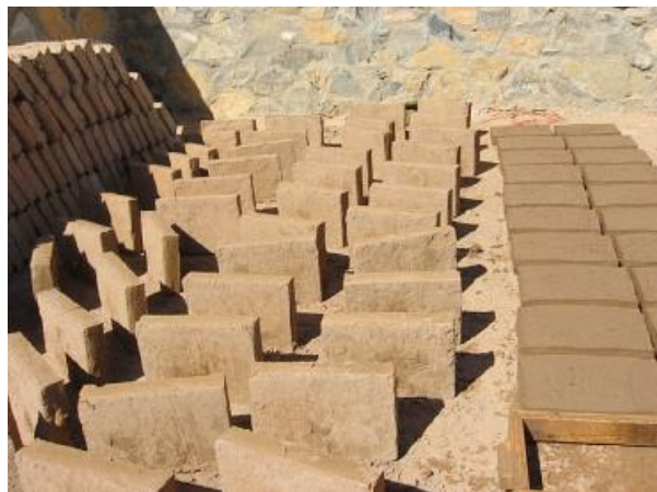
Figura 1: Imagen Secado del Adobe al aire libre.
