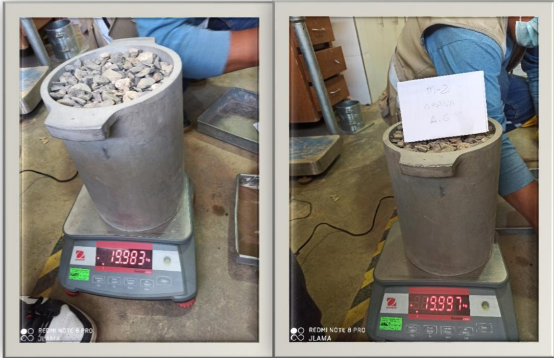
Foto 7: Peso del agregado Grueso para calcular el Peso Unitario Suelto y Compactado
