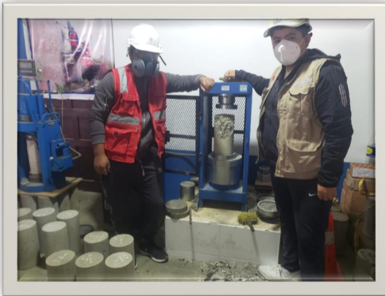
Foto 29: Rotura de Probetas (Fisuras verticales)
