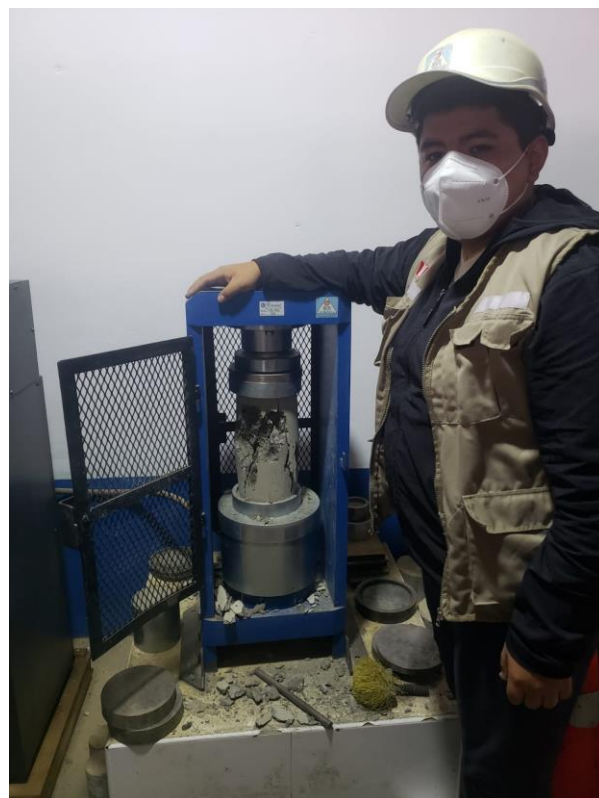
Foto 32: Rotura de probetas (Fisura vertical)
