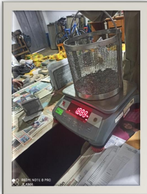
Foto 11: Ensayo de Absorción del Agregado Grueso
