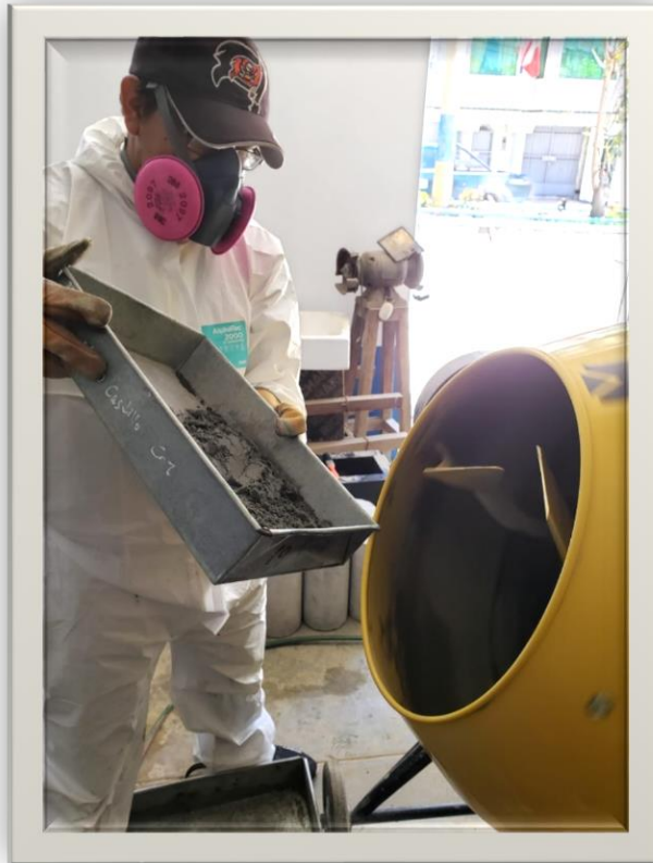
Foto 25: Preparado de la mezcla con el 10% de adición del relave minero en reemplazo del agregado fino
