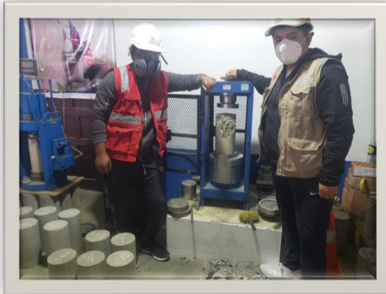
Foto 28: Rotura de Probetas C.P y Sustituyendo
