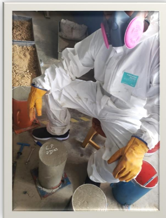
Foto 26: Desmoldado de Probetas
