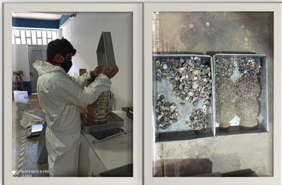
Foto 6: Tamizado de los agregados
