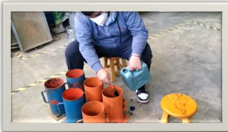
Foto 18: Limpieza y engrase con petróleo de las probetas
