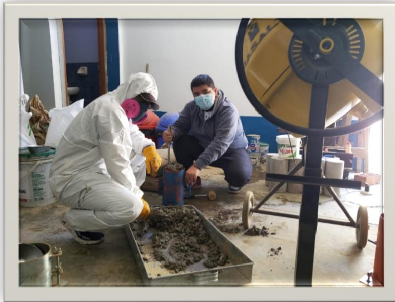
Foto 24: Mezclado del concreto con adición del relave en reemplazo del agregado fino
