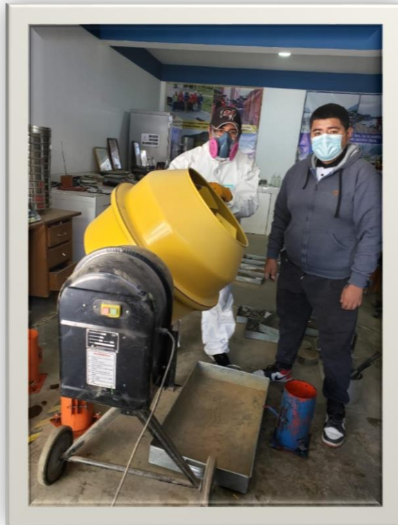
Foto 23: Vaciado del concreto en las probetas
