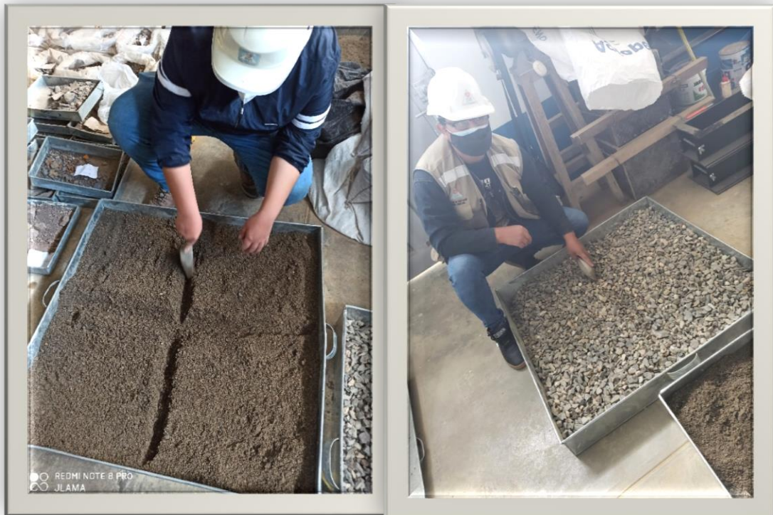
Foto 4: Cuarteo del Agregado Fino y Grueso para realizar el ensayo de contenido de humedad
