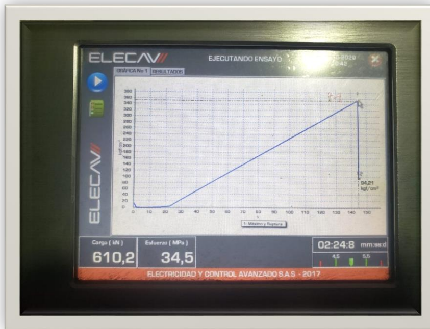
Foto 33: Resistencia Obtenida Sustituyendo el 5% de relave a los 7 días P - 1(164 kg/cm 2 )
