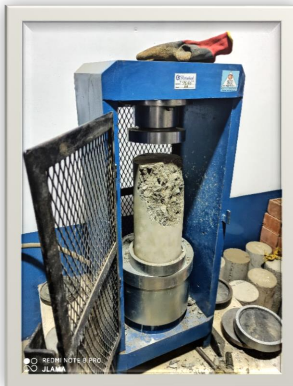
Foto 30: Rotura de Probetas con S – 5% (fisuras verticales)
