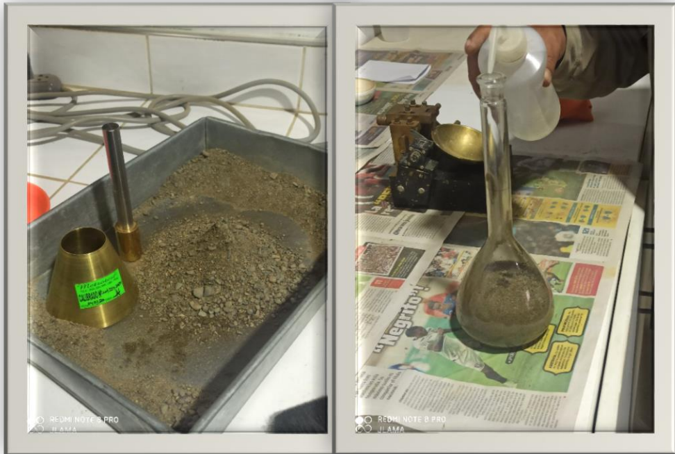
Foto 10: Ensayo de Absorción del Agregado Fino
