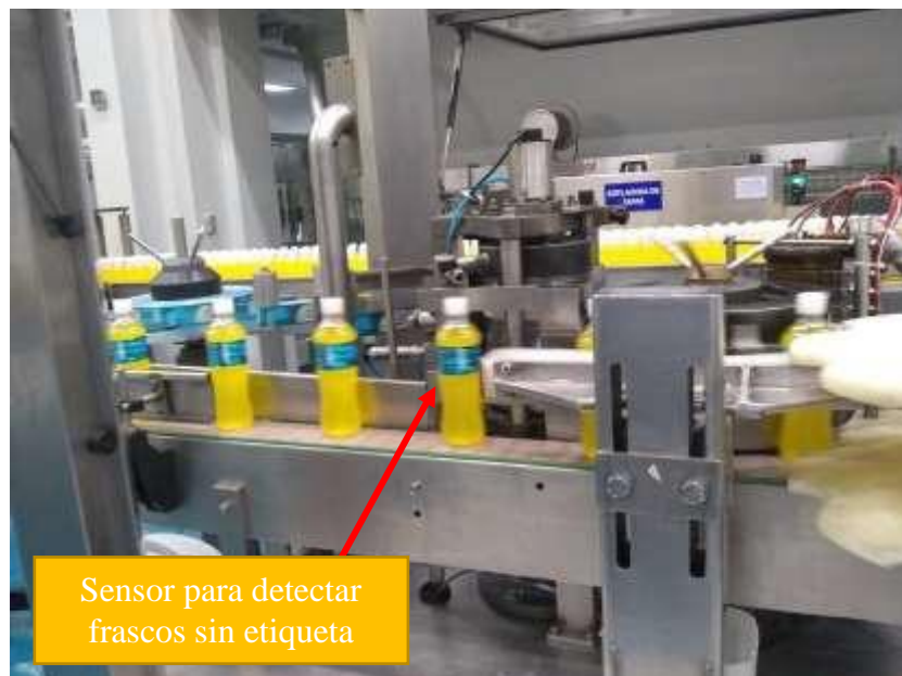
Fig. 24. Sensor para detectar frascos sin etiquetar. Fuente de la empresa ATE-2019
