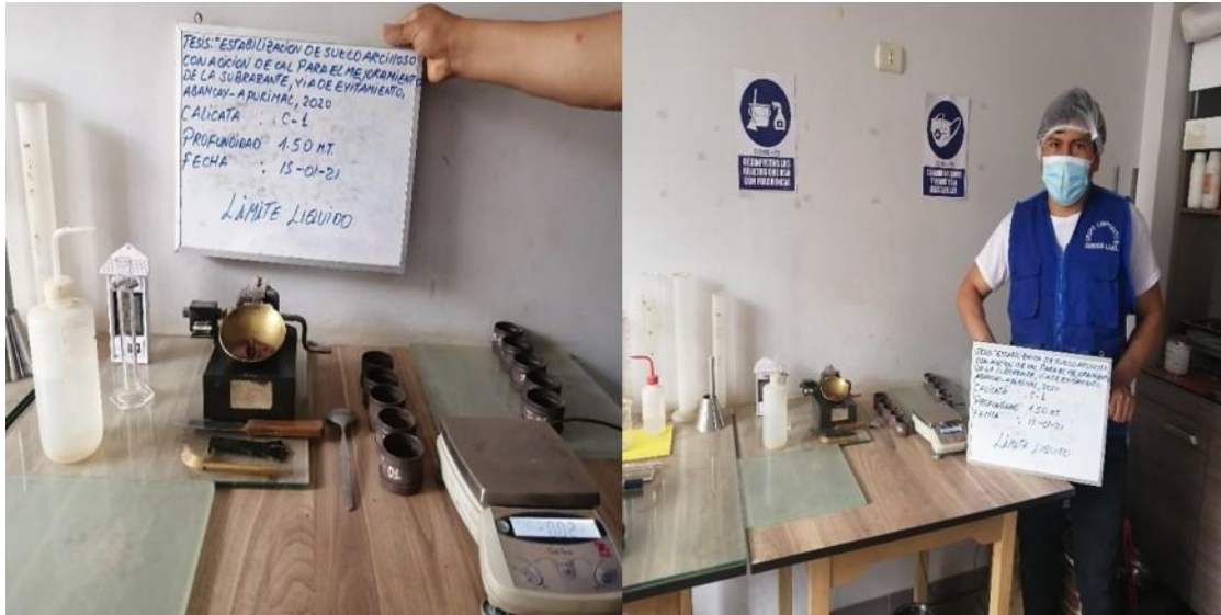
Figura 2. Límite Líquido en laboratorio ASTM D-4318, MTC E 110
