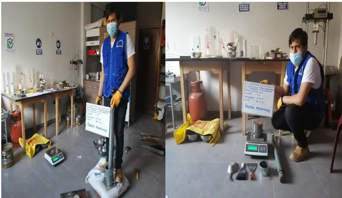
Figura 4. Proctor Modificado en laboratorio ASTM D-1557, MTC – E115
