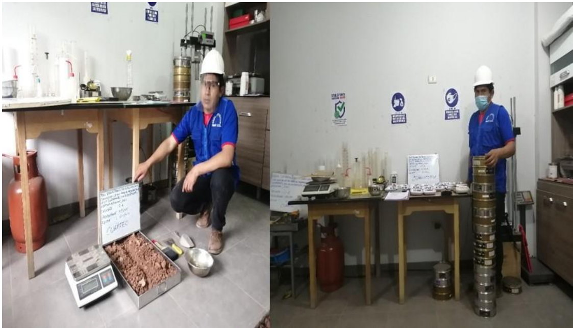
Figura 1 Análisis granulométrico en laboratorio (ASTM D-422, MTC E 107)
