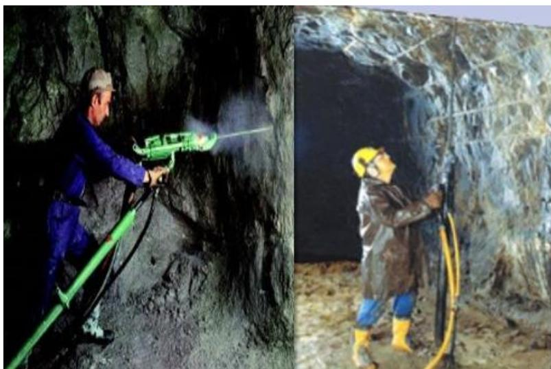
Figura 1: Proceso de perforación para la extracción del mineral
