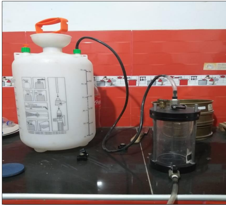
Figura 41: Ensayo de permeabilidad
